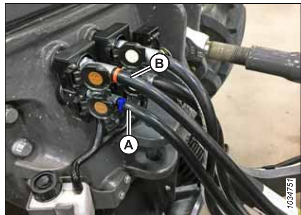
Figure 4.24: SCS avant du tracteur
