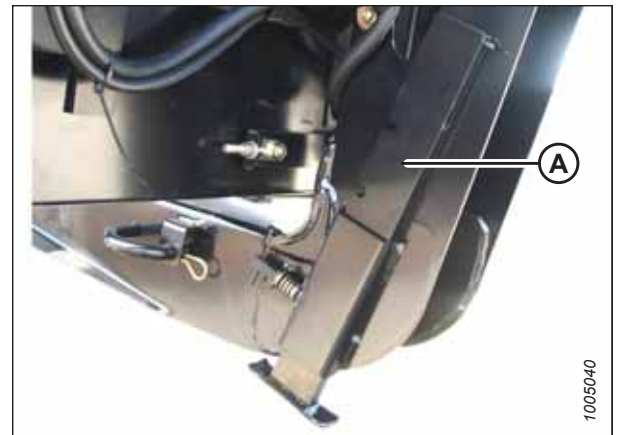
Figure 4.49: Chandelle de la plateforme
