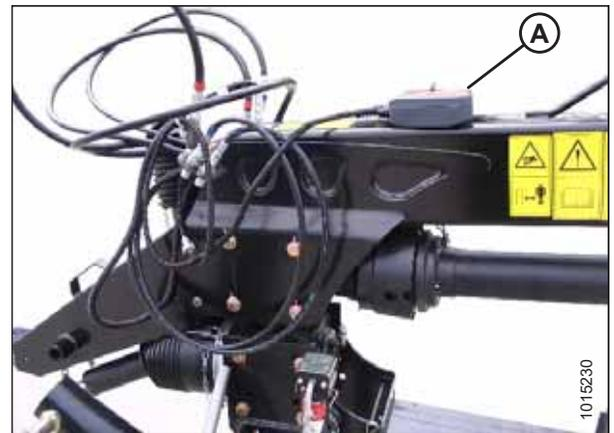
Figure 4.78: Contrôle à distance au-dessus de l'attelage
