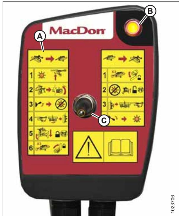
Figure 9.14: Boîtier de commande
