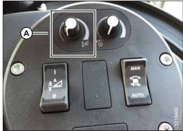
Figure 8.223: Groupe de commande de la plateforme
