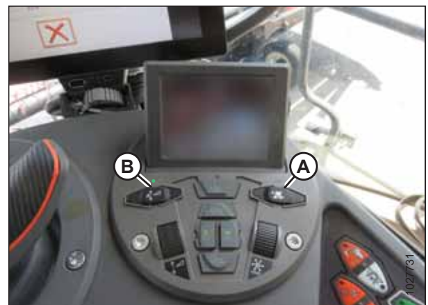
Figure 8.40: Groupe de commande de la plateforme
