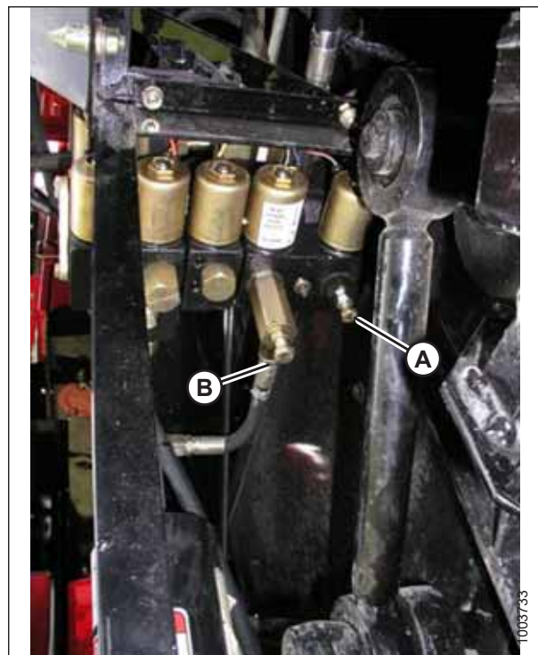
Figure 8.187: Limiteurs réglables d'élévation et d'abaissement de la plateforme
