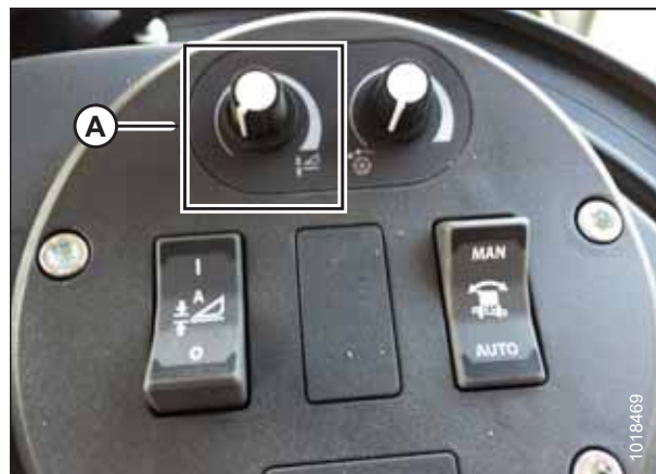
Figure 8.226: Groupe de commande de la plateforme
