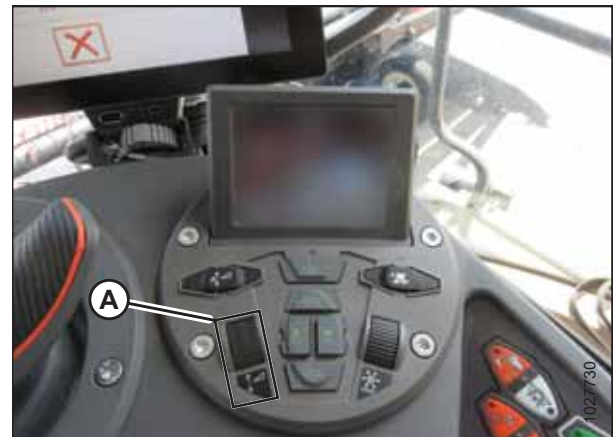
Figure 8.45: Groupe de commande de la plateforme
