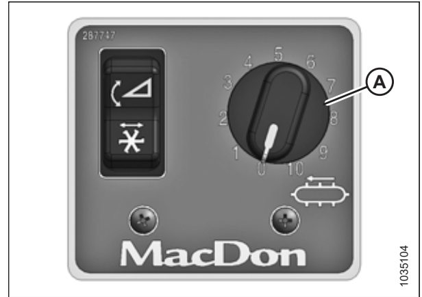
Figure 10.5: Commande de vitesse du tapis en cabine – Moissonneuses-batteuses IDEAL™, Challenger®, CLAAS, Gleaner®, John Deere et Massey Ferguson®
