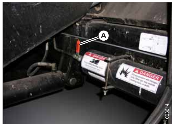
Figure 8.186: Commutateur ON/OFF (marche/arrêt) de l'accumulateur de la moissonneuse-batteuse
