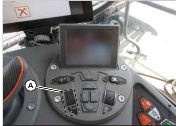
Figure 8.42: Groupe de commande de la plateforme
