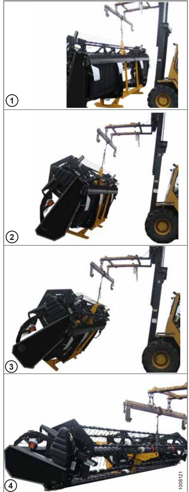
Figure 2.19: Abaissement de la plateforme sur le sol
