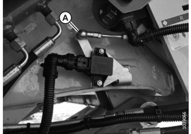
Figure 4.37: Articulation du bras du capteur
