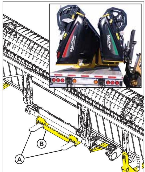
Figure 2.3: Supports d'expédition de la plateforme
