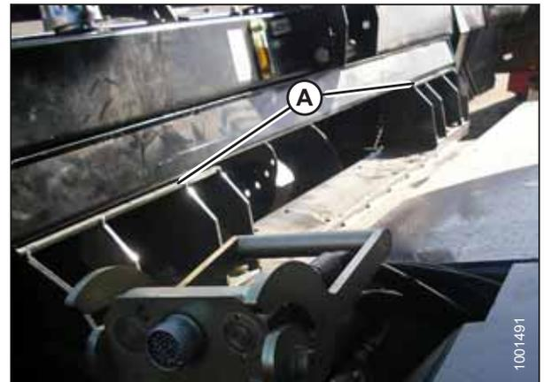
Figure 10.39: Convoyeur et module de flottement
