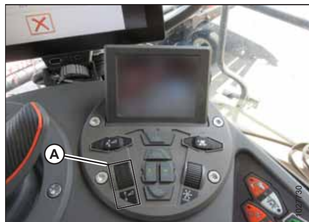
Figure 7.52: Groupe de commande de la plateforme
