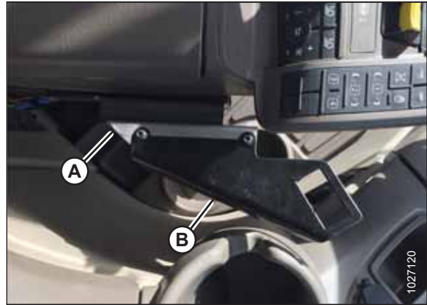
Figure 5.66: Vue de dessus de l'accoudoir montrant les supports installés dans un autre emplacement
