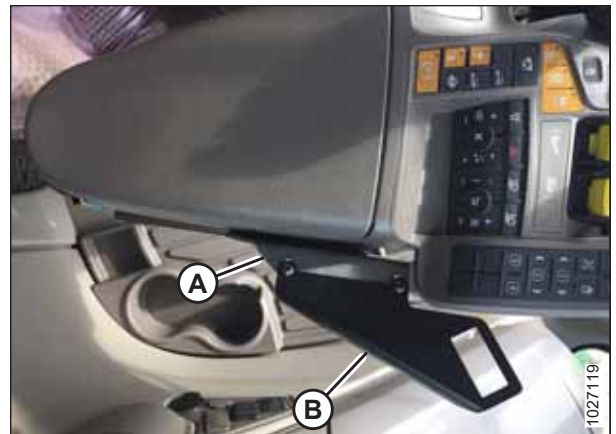
Figure 5.64: Vue de dessus de l'accoudoir montrant les supports installés à l'emplacement recommandé
