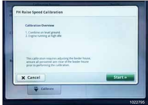
Figure 7.348: Écran John Deere S7 – Étalonage du convoyeur
