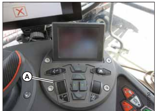
Figure 7.49: Groupe de commande de la plateforme
