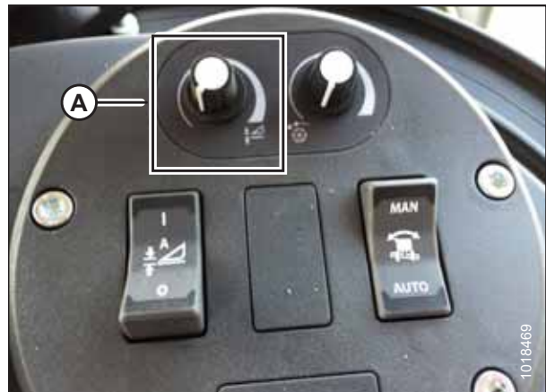
Figure 7.250: Groupe de commande de la plateforme
