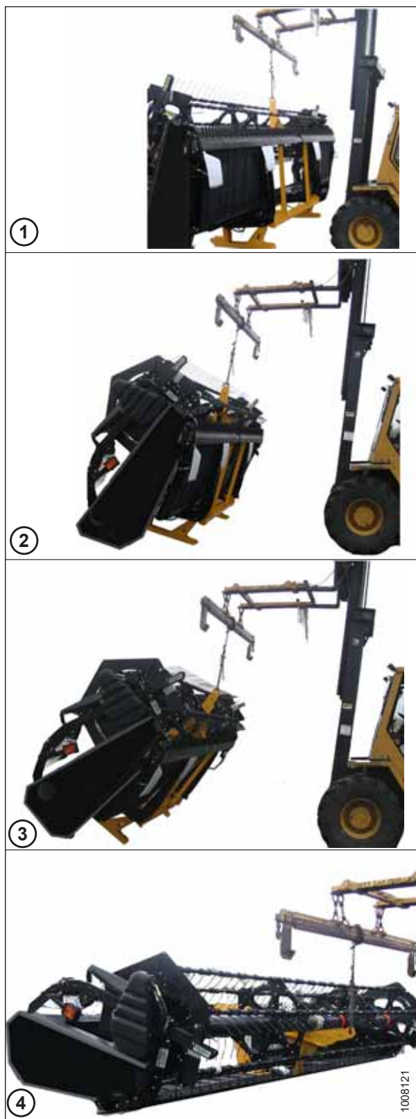
Figure 2.6: Plateforme abaissée sur le sol
