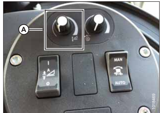
Figure 7.253: Groupe de commande de la plateforme
