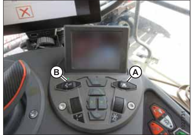
Figure 7.47: Groupe de commande de la plateforme
