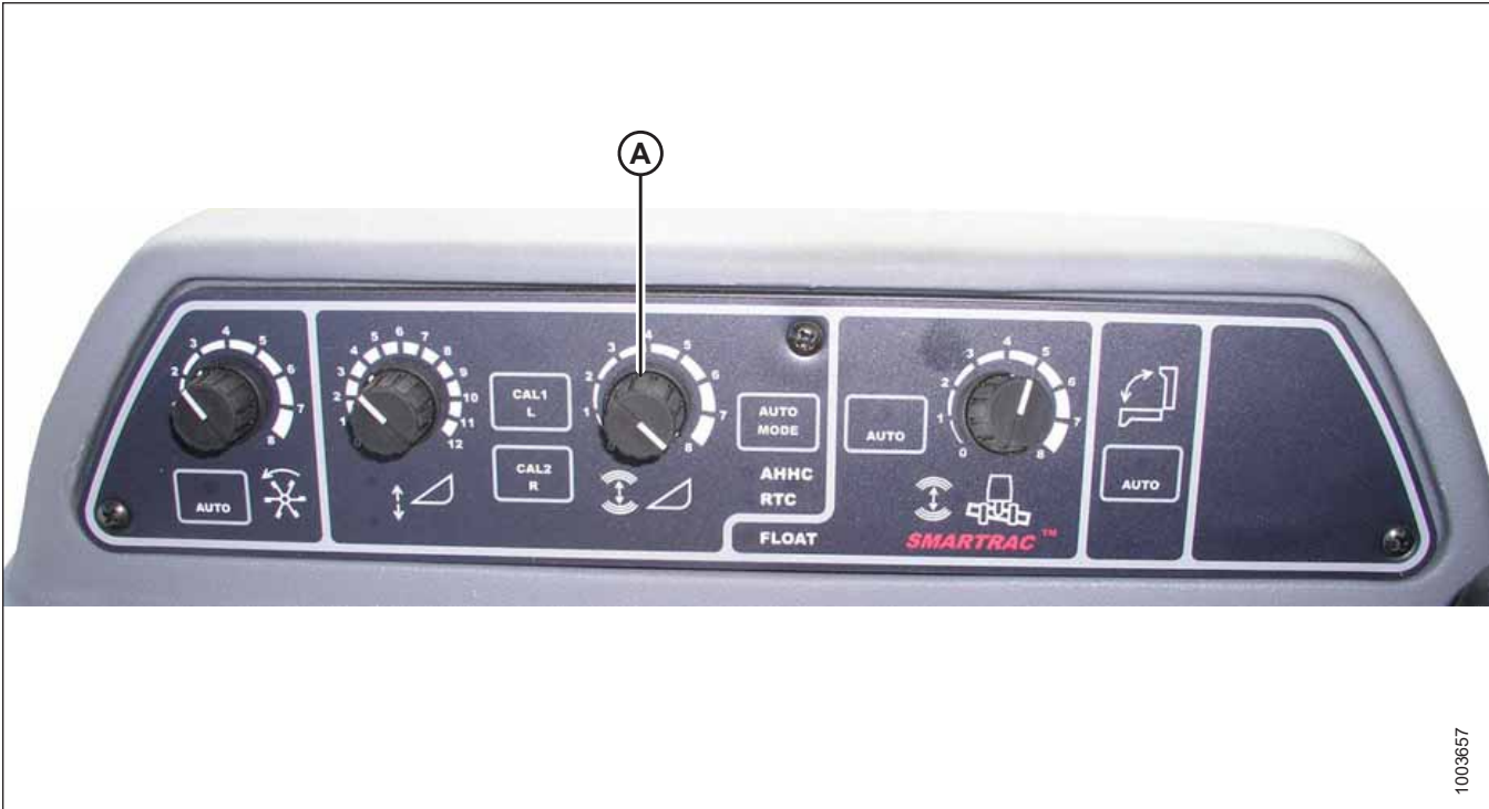
Figure 7.216: Console de contrôle de la hauteur automatique de la plateforme
