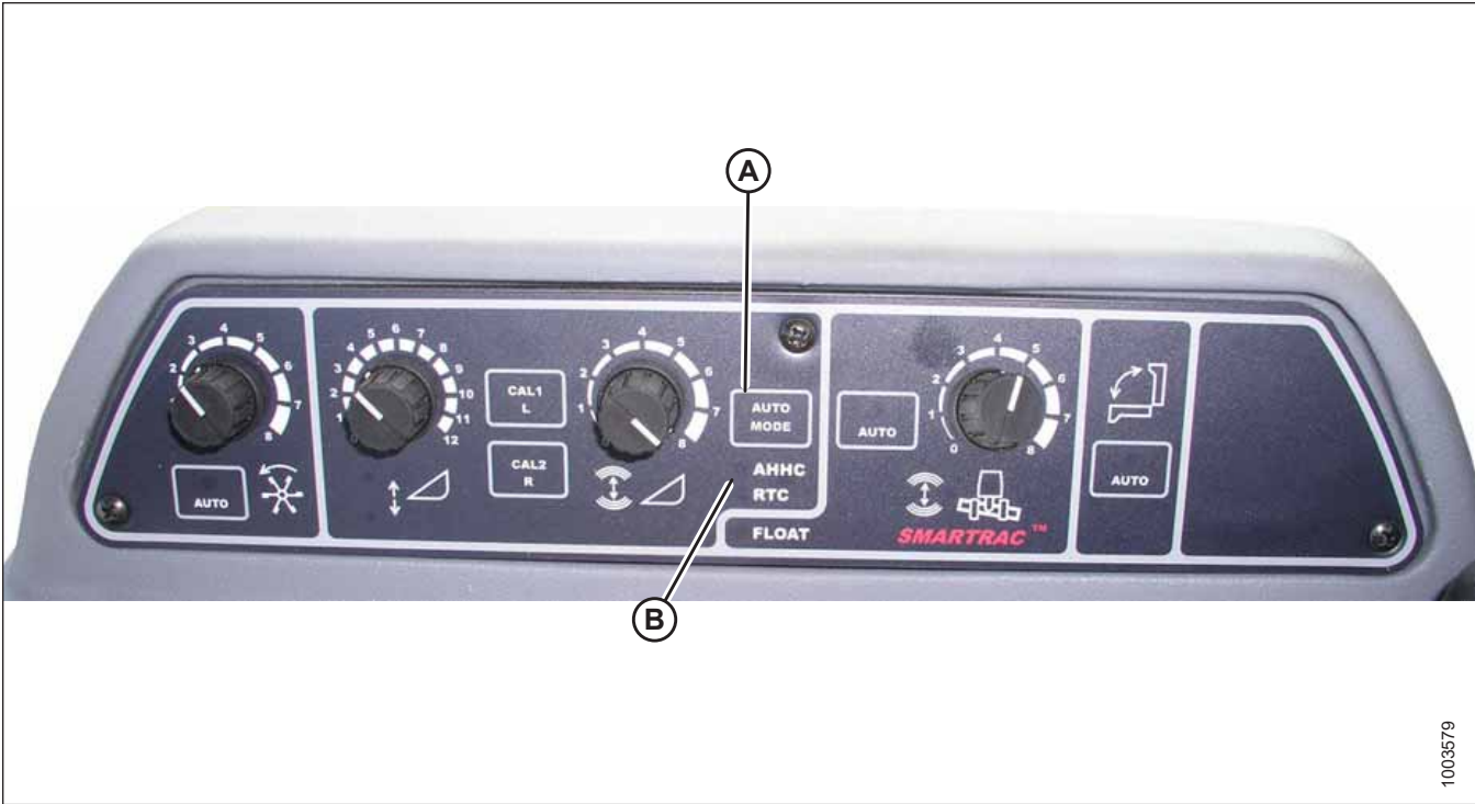
Figure 7.209: Commandes du système de réglage automatique de la hauteur de la plateforme de la moissonneuse-batteuse
