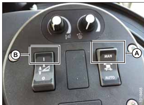
Figure 7.248: Groupe de commande de la plateforme
