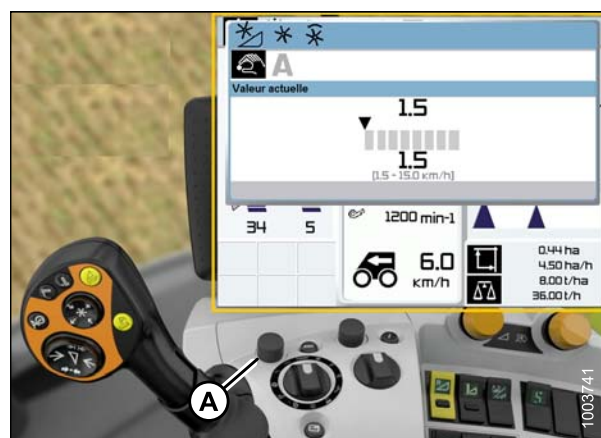
Figure 7.147: Écran, console et levier de commande de la moissonneuse-batteuse CLAAS
