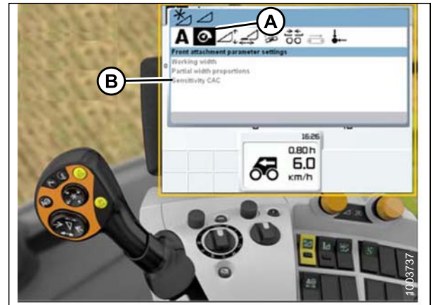
Figure 7.142: Écran, console et levier de commande de la moissonneuse-batteuse CLAAS
