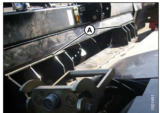
Figure 5.11: Convoyeur et module de flottement
