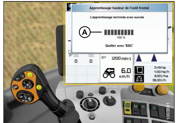
Figure 7.153: Écran, console et levier de commande de la moissonneuse-batteuse CLAAS
