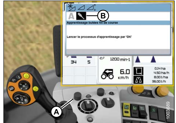
Figure 7.151: Écran, console et levier de commande de la moissonneuse-batteuse CLAAS
