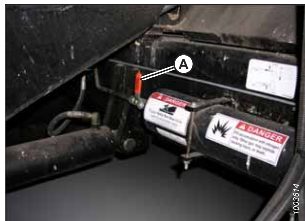
Figure 8.190: Commutateur ON/OFF (marche/arrêt) de l'accumulateur de la moissonneuse-batteuse A – Levier de l'accumulateur (position Off)
