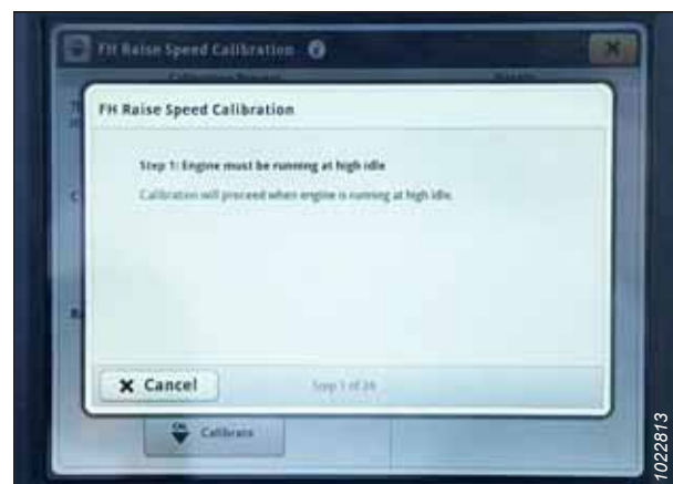
Figure 8.368: Écran John Deere S7 – Étalonnage du convoyeur
