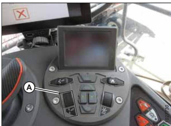
Figure 8.263: Groupe de commande de la plateforme
