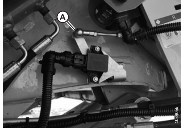
Figure 4.34: Articulation du bras du capteur
