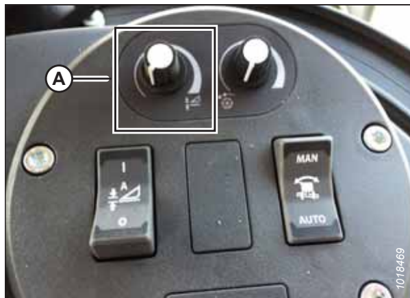
Figure 8.230: Groupe de commande de la plateforme
