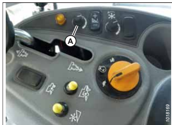
Figure 8.102: Bouton de réglage de la hauteur sur la console de commande de la moissonneuse-batteuse
