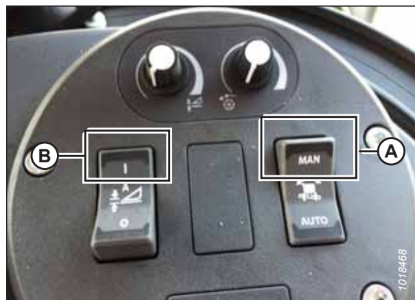
Figure 8.228: Groupe de commande de la plateforme
