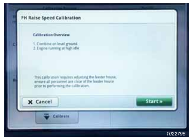
Figure 8.367: Écran John Deere S7 – Étalonnage du convoyeur
