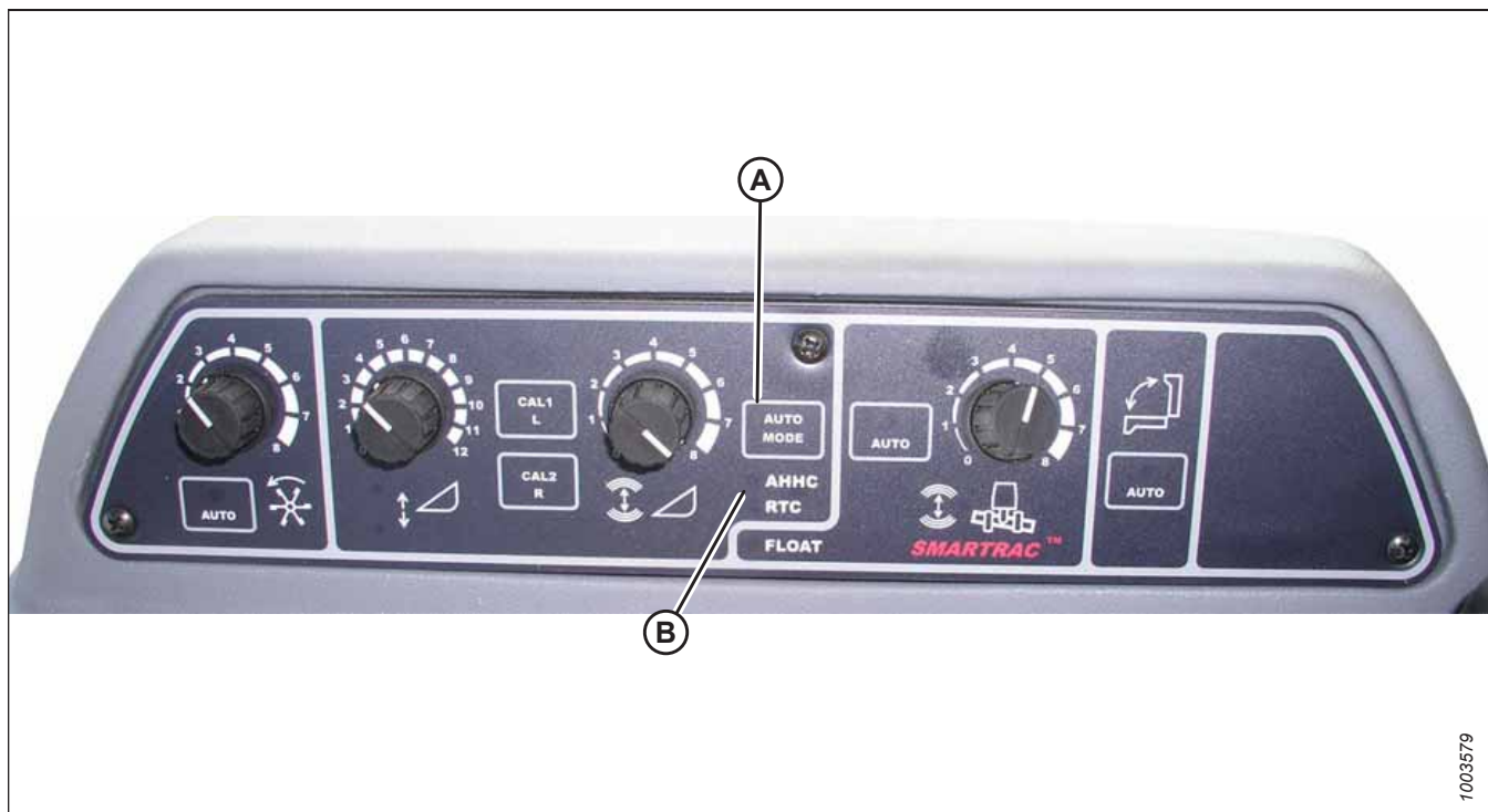
Figure 8.185: Commandes du système de réglage automatique de la hauteur de la plateforme de la moissonneuse-batteuse
