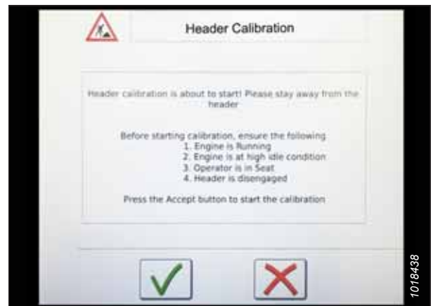
Figure 8.223: Avertissement d'étalonnage de la plateforme
