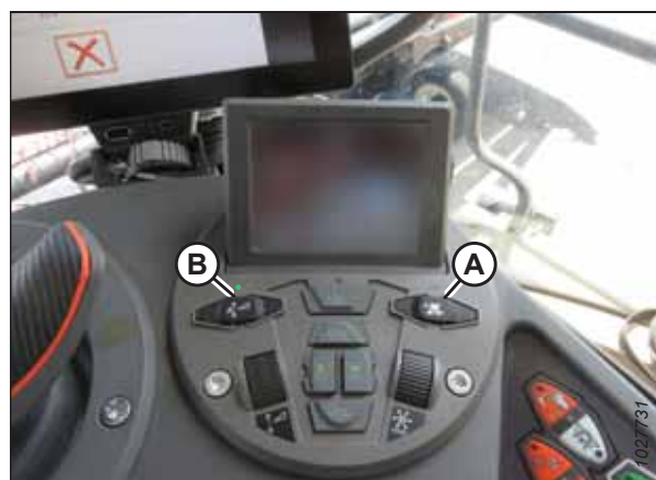
Figure 8.261: Groupe de commande de la plateforme
