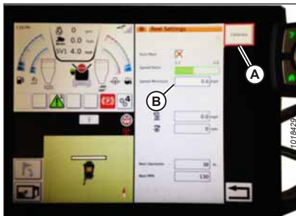
Figure 8.209: Étalonnage des réglages du rabatteur
