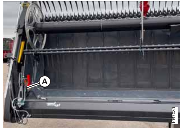
Figure 2.8: Feu de gabarit gauche fixé à la plateforme
