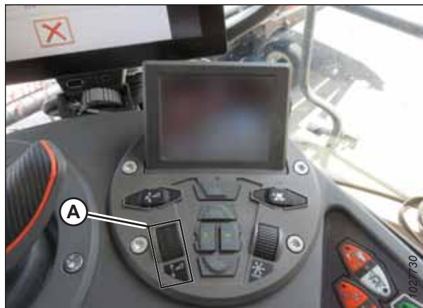
Figure 9.226: Groupe de commande de la plateforme
