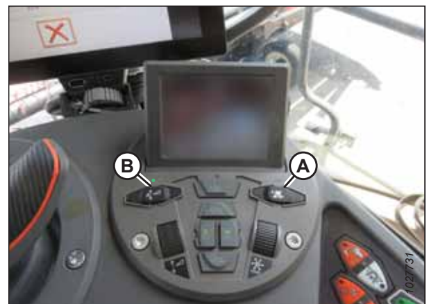
Figure 9.224: Groupe de commande de la plateforme
