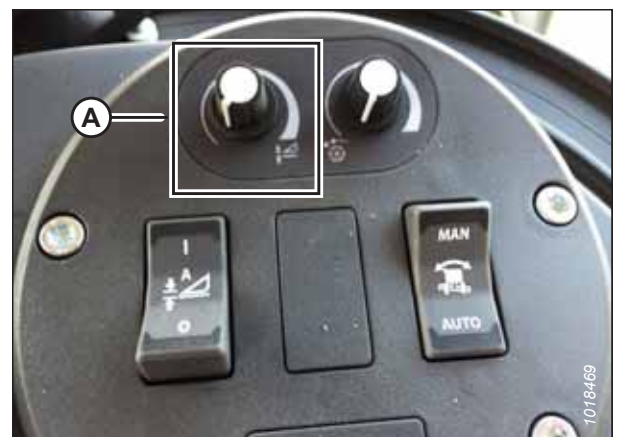
Figure 9.196: Groupe de commande de la plateforme
