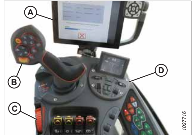
Figure 9.223: Poste de l'opérateur
