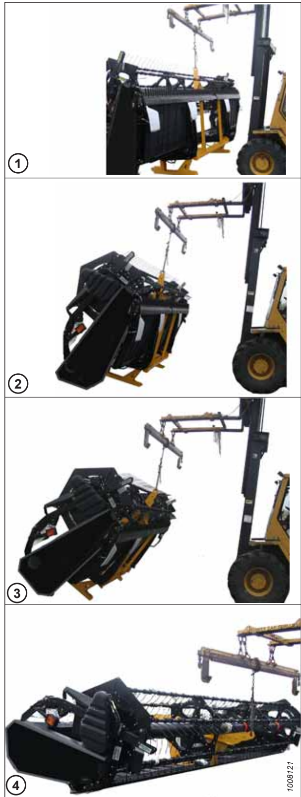
Figure 2.21: Plateforme abaissée en position de travail
