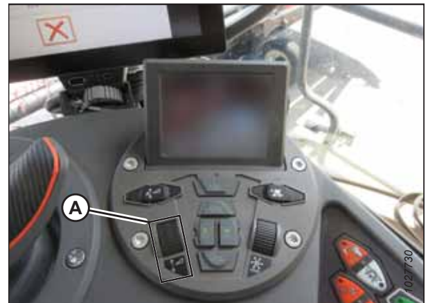
Figure 9.229: Groupe de commande de la plateforme
