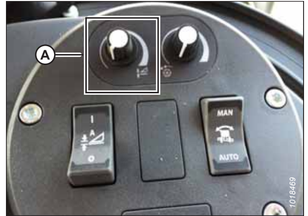
Figure 9.199: Groupe de commande de la plateforme
