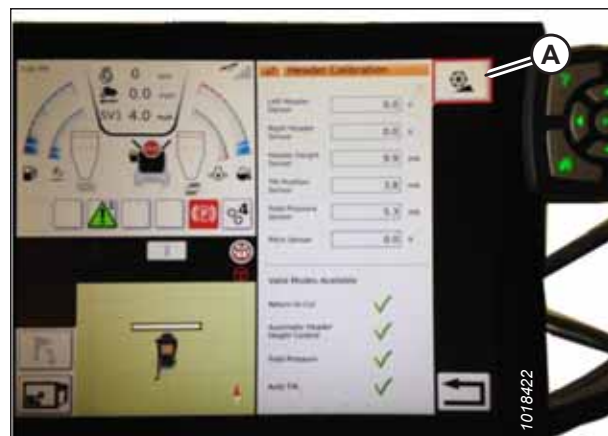
Figure 9.188: Étalonnage de la plateforme
