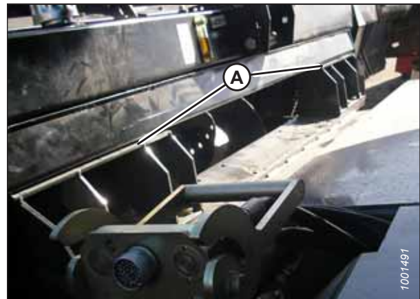
Figure 5.14: Convoyeur et module de flottement
