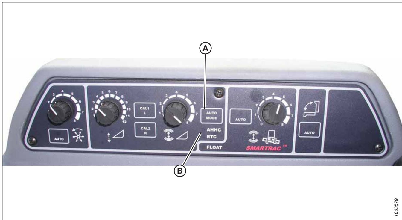
Figure 9.156: Commandes du système de réglage automatique de la hauteur de la plateforme de la moissonneuse-batteuse
