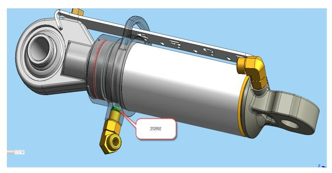
ENSURE ELBOW FITTING IS ORIENTATED AS SHOWN BELOW
