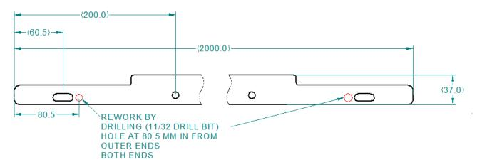
REWORK TRANSITION PAN FLAPS BY DRILLING HOLE (AS SHOWN BELOW) OR EXTENDING SLOT BY 13 MM.
