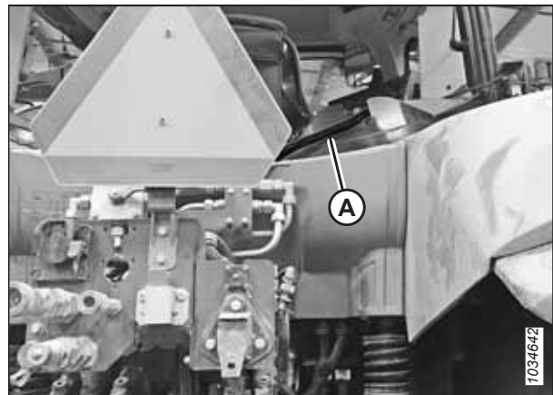
Abbildung 4.40: Verlegen des Kabelbaums in die Kabine
