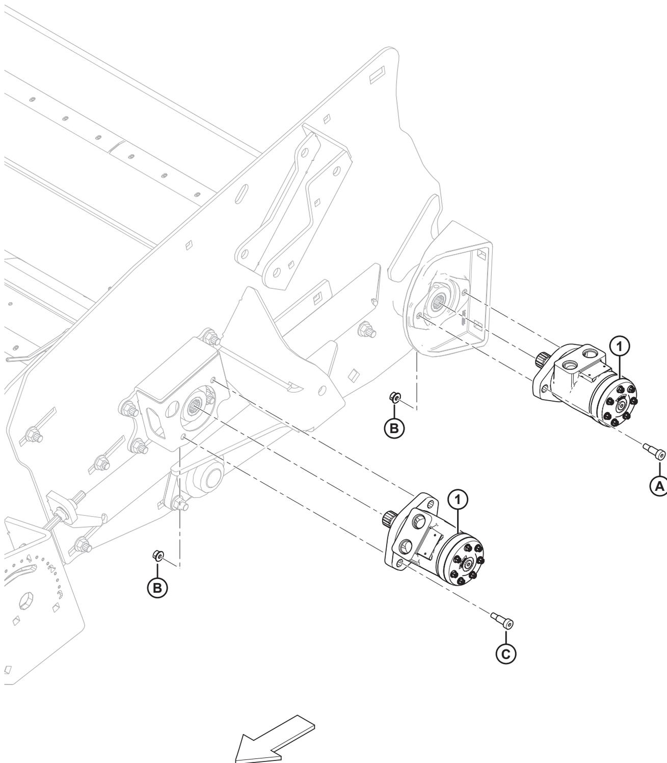
**ДЕКА — ГИДРОМОТОРЫ**
