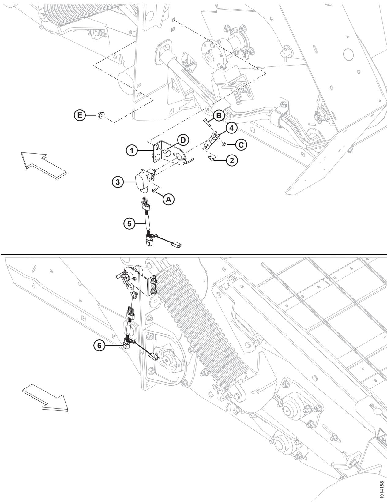
**КОМПОНОВКА ПОД КОМБАЙН — ДАТЧИКИ (NEW HOLLAND, 10 ВОЛЬТ)**
