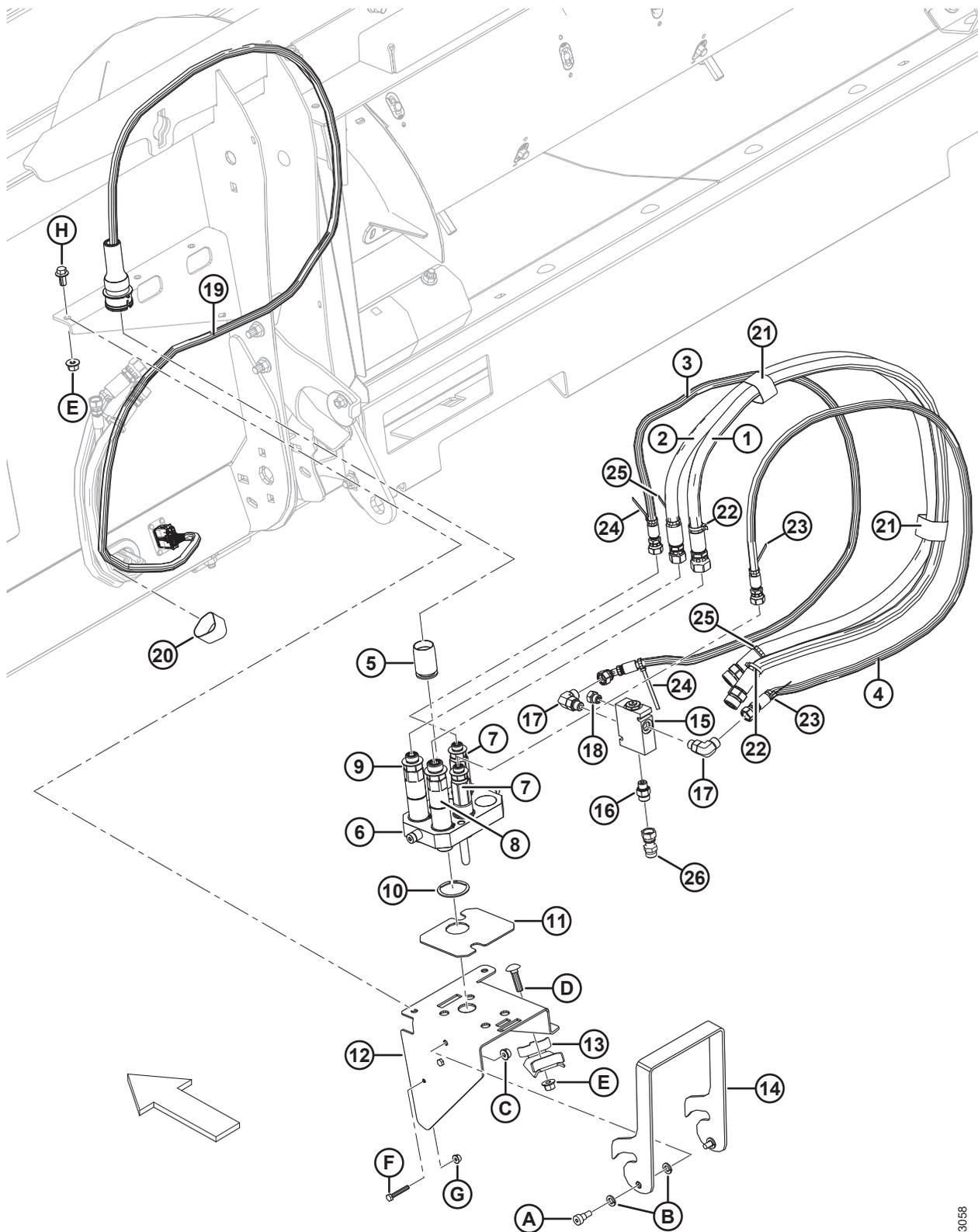
**КОМПОНОВКА ПОД КОМБАЙН — ГИДРАВЛИЧЕСКОЕ/ЭЛЕКТРИЧЕСКОЕ ОБОРУДОВАНИЕ, МОДЕЛИ 2016-ГО И ПОСЛЕДУЮЩИХ ГОДОВ ВЫПУСКА (JD)**
