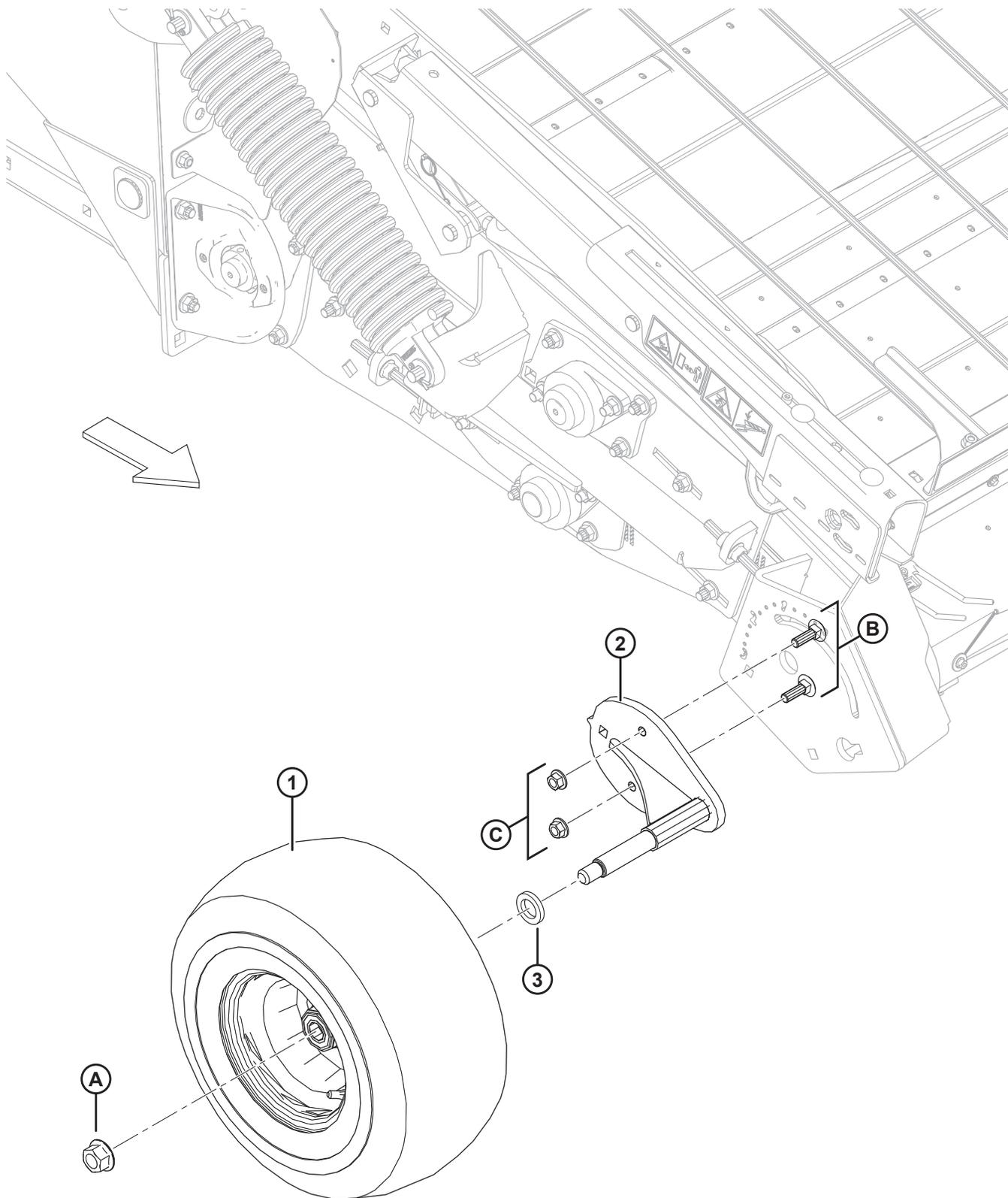
**КОЛЕСО В СБОРЕ — ФИКСИРОВАННЫЕ КОЛЕСА**
