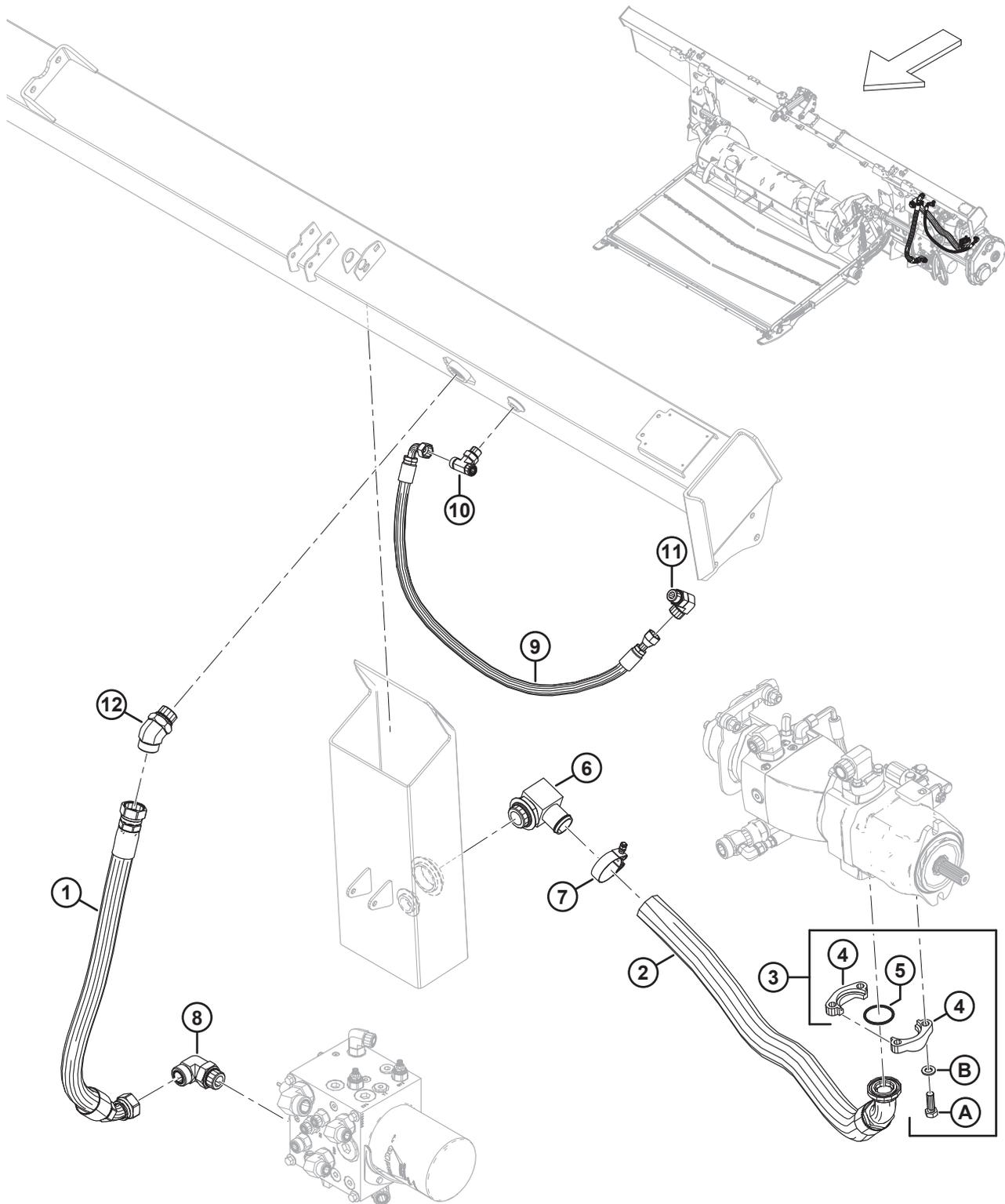
**HYDRAULIK – ANSAUGUNG UND RÜCKLAUF (MODULARES HYDRAULIKSYSTEM)**
