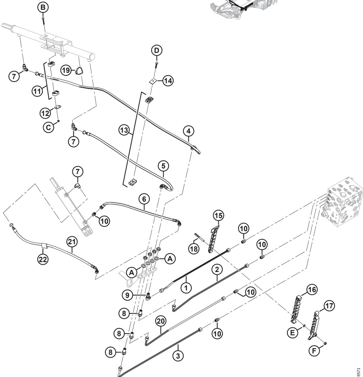
**HYDRAULIK – HUB- UND HORIZONTALVERSTELLUNG, DURCHGEHENDE HASPEL, LINKER HASPELARM (FD225)**
