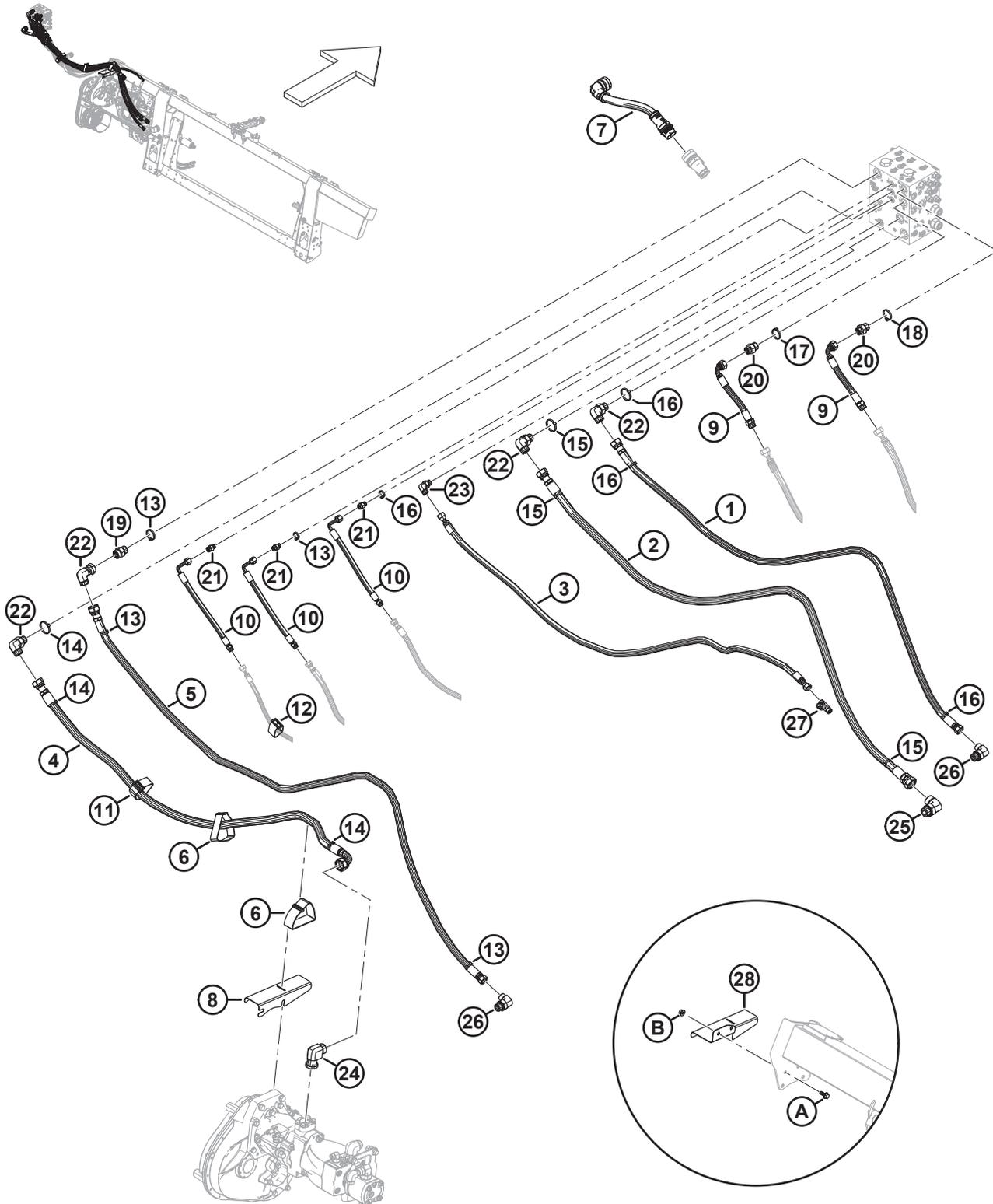
HYDRAULIK – DREITEILIGE HASPEL, FLOATMODUL AN SCHNEIDWERK-VERTEILER (MODULARES HYDRAULIKSYSTEM)
