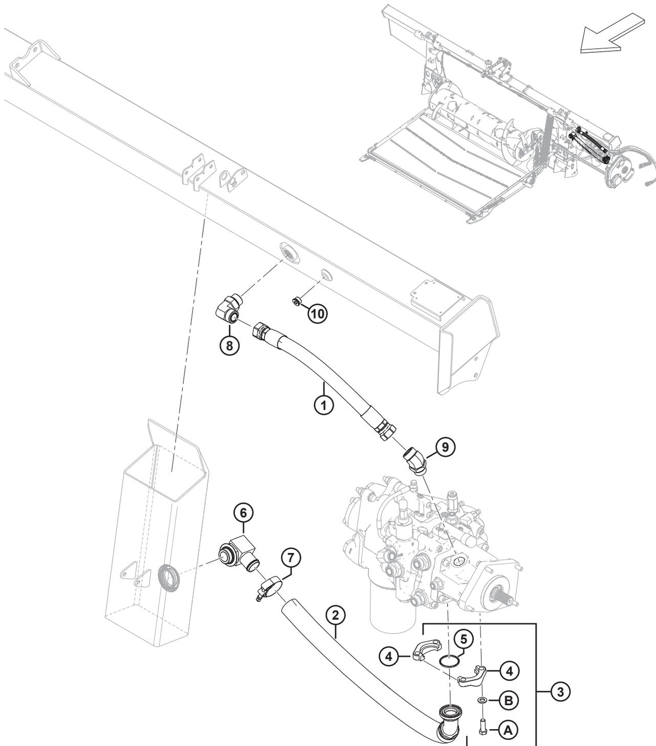
**HYDRAULIK – ANSAUGUNG UND RÜCKLAUF (INTEGRIERTES HYDRAULIKSYSTEM)**
