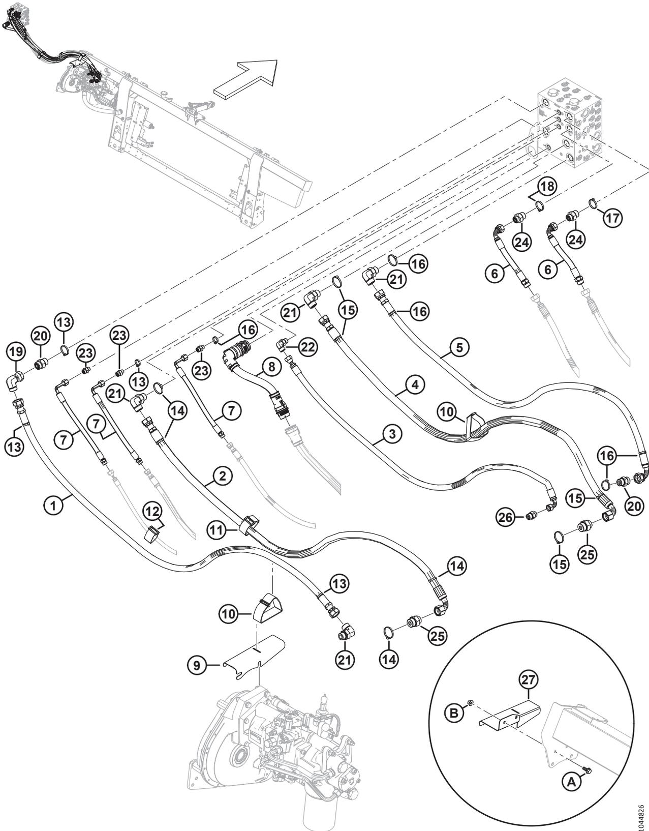
HYDRAULIK – DREITEILIGE HASPEL, FLOATMODUL AN SCHNEIDWERK-VERTEILER (INTEGRIERTES HYDRAULIKSYSTEM)
