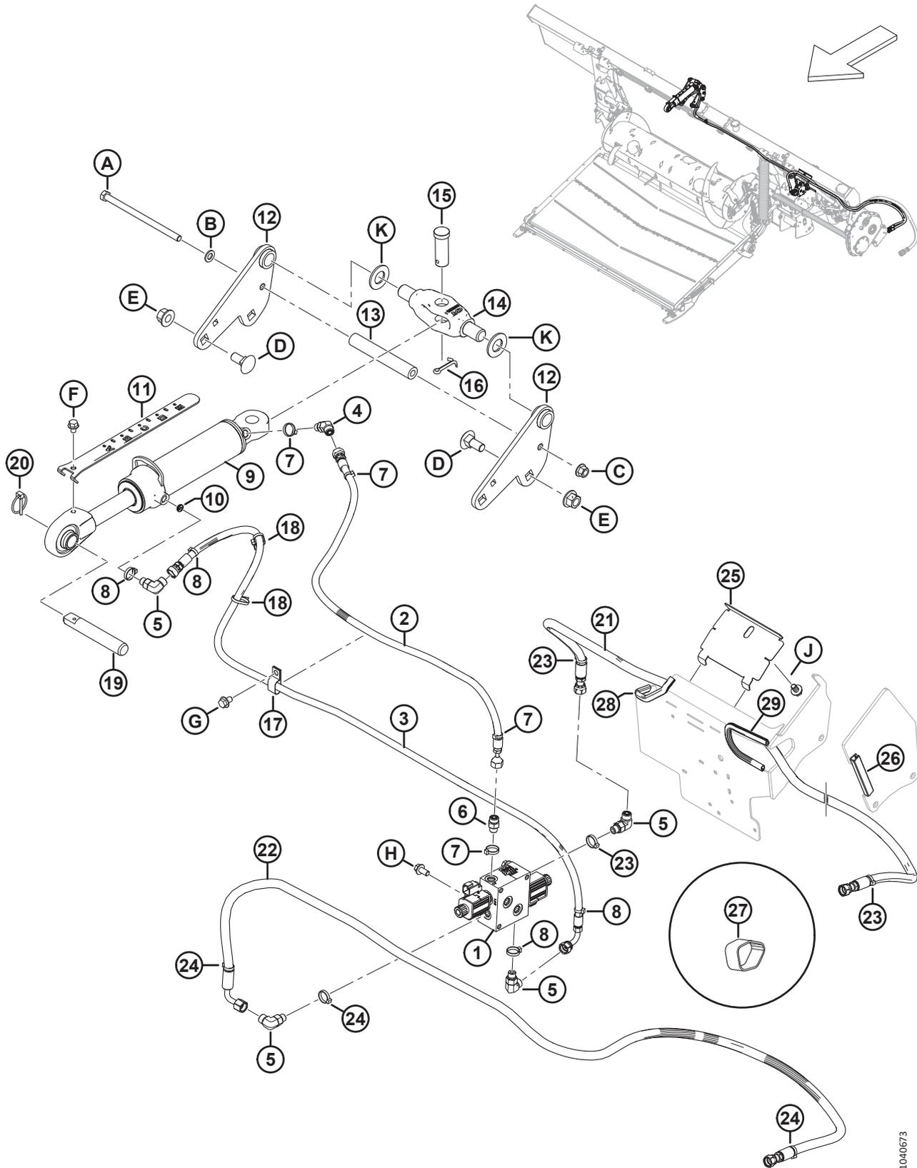
**HYDRAULIK – NEIGUNGSZYLINDER UND SCHNEIDWERKSNEIGUNG/HORIZONTALVERSTELLUNG – HASPEL**
