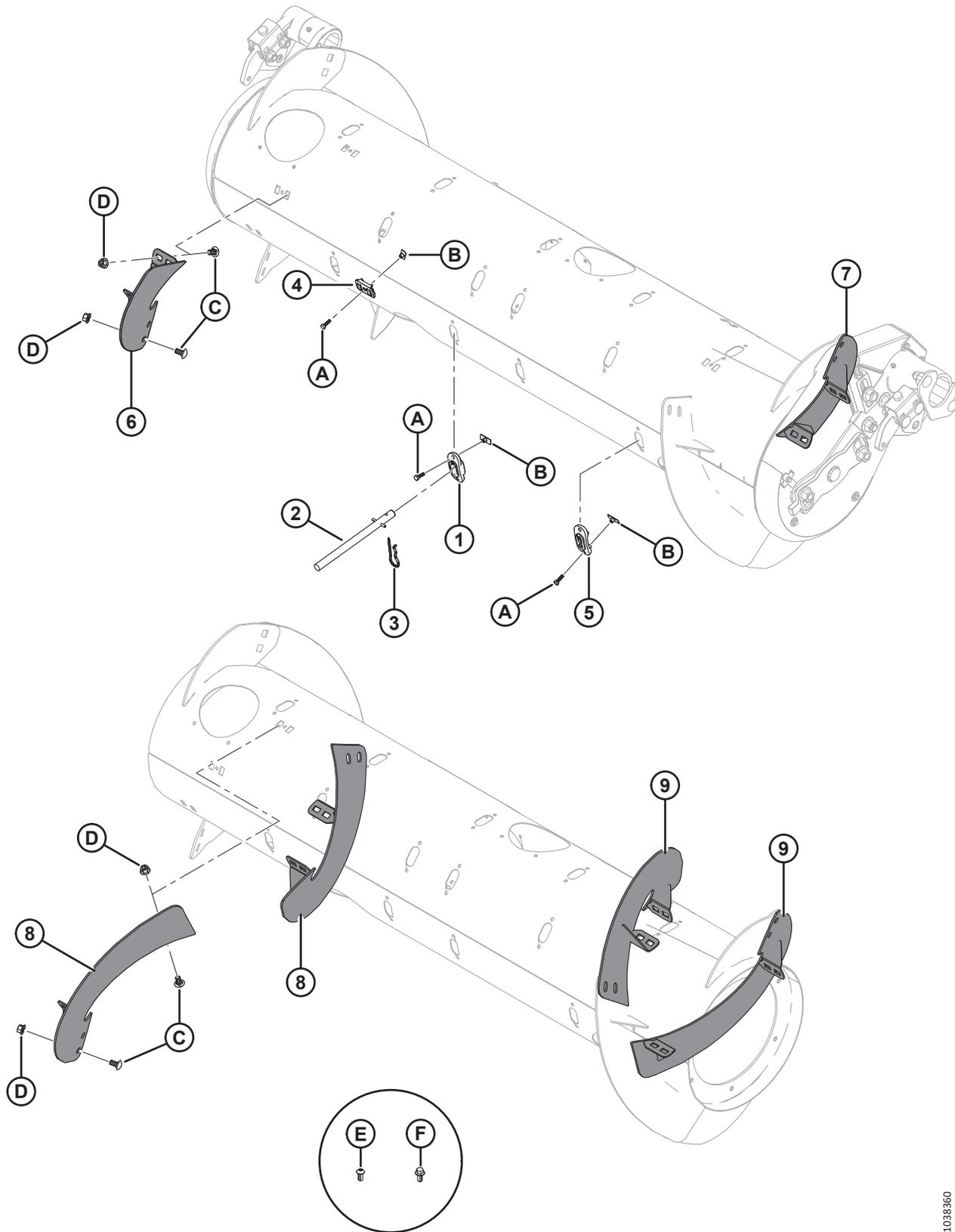
**UMRÜSTSÄTZE EINZUGSTROMMEL – FINGER UND SCHNECKENWINDUNGEN**
