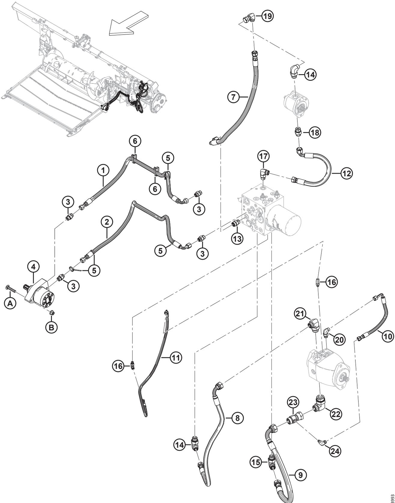
**HYDRAULIK – TRAGRAHMEN (MODULARES HYDRAULIKSYSTEM)**
