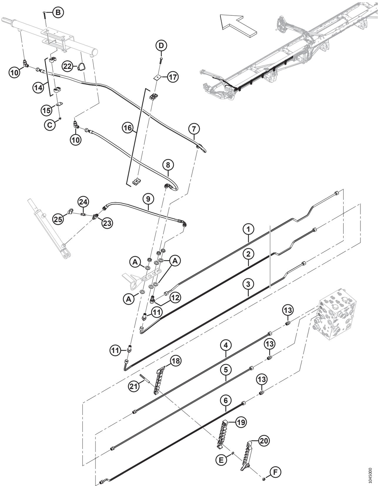
**HYDRAULIK – HUB- UND HORIZONTALVERSTELLUNG, DREITEILIGE HASPEL, LINKER HASPELARM (FD240, FD245, FD250 UND FD261)**
