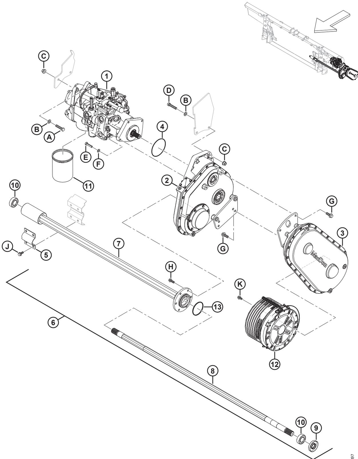
**PUMPEN-, GETRIEBE- UND EINGANGSANTRIEB (INTEGRIERTES HYDRAULIKSYSTEM)**
