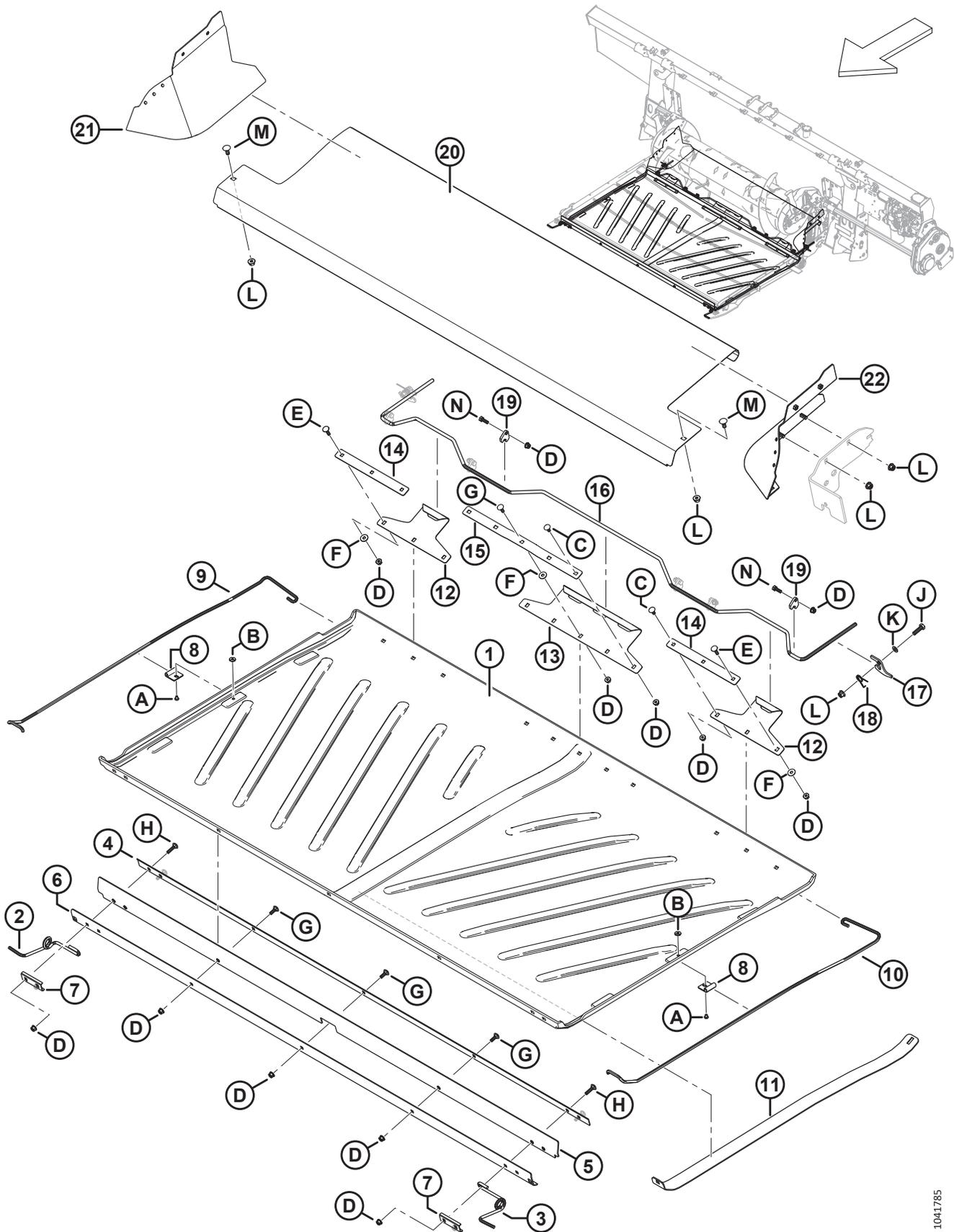
**EINZUG – BODENPLATTEN UND ZWISCHENPLATTEN**
