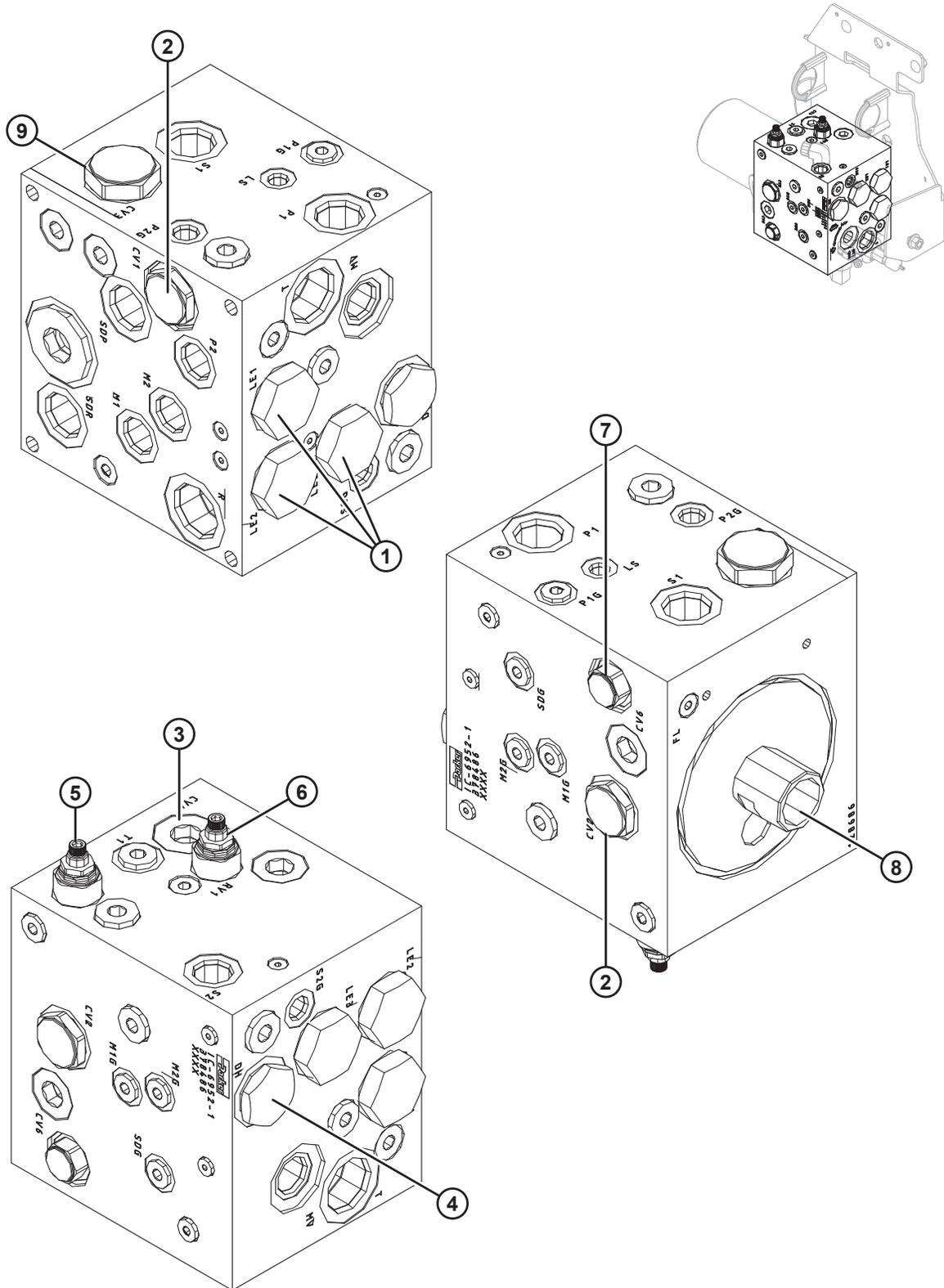
**HYDRAULIK – ANTRIEBSVERTEILERBAUGRUPPE, AUSTAUSCHTEILE (MODULARES HYDRAULIKSYSTEM)**
