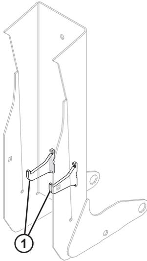
**(WAHLAUSRÜSTUNG) REPARATUR DES ANSCHLAGS DES AUSLENKGESTÄNGES**
