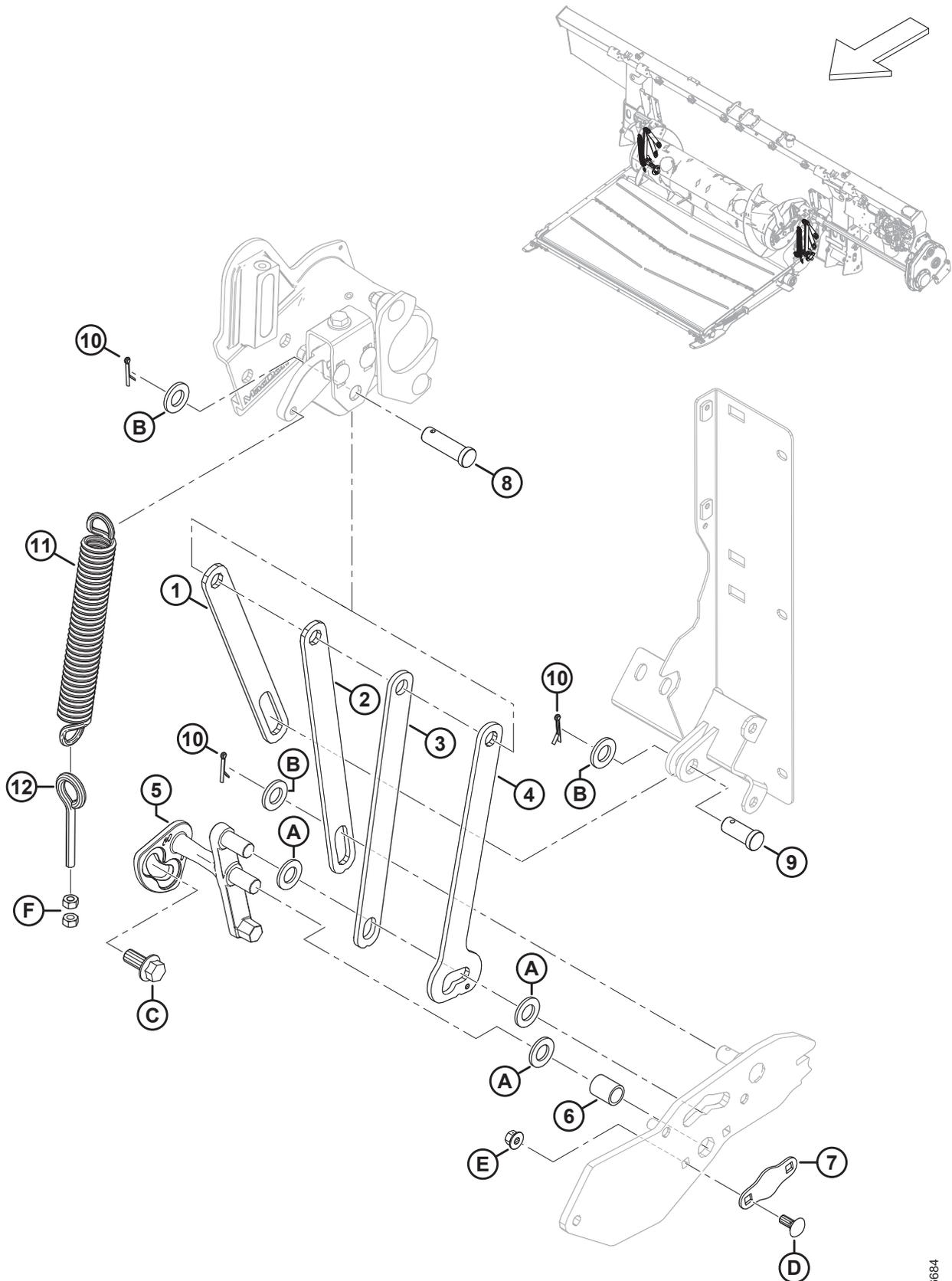
**EINZUGSTROMMEL – FLOATGESTÄNGE**
