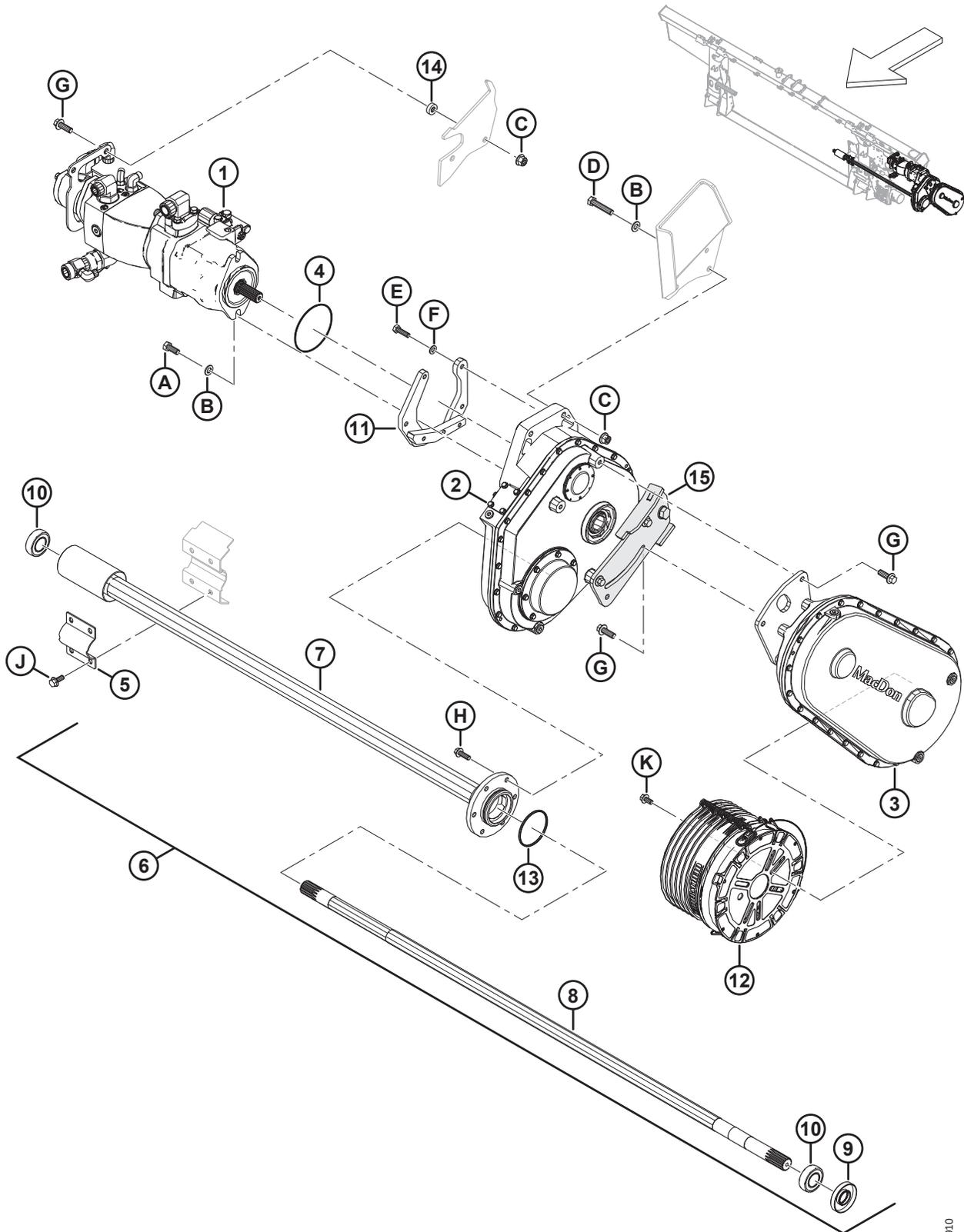
**PUMPEN-, GETRIEBE- UND EINGANGSANTRIEB (MODULARES HYDRAULIKSYSTEM)**
