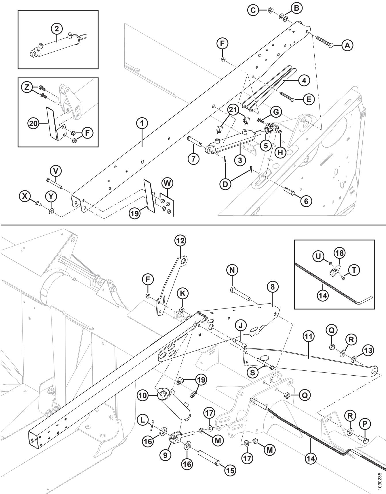
**BRAÇOS DE SUPORTE E CILINDROS DE ELEVAÇÃO DO MOLINETE**
