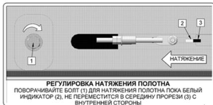
**РЕГУЛИРОВКА НАТЯЖЕНИЯ ПОЛОТНА**
