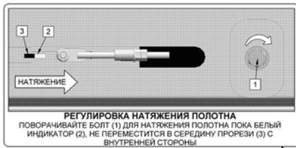
**РЕГУЛИРОВКА НАТЯЖЕНИЯ ПОЛОТНА**
