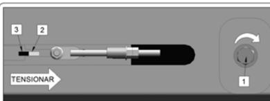
**AJUSTE DE TENSIONAMENTO DA ESTEIRA**
