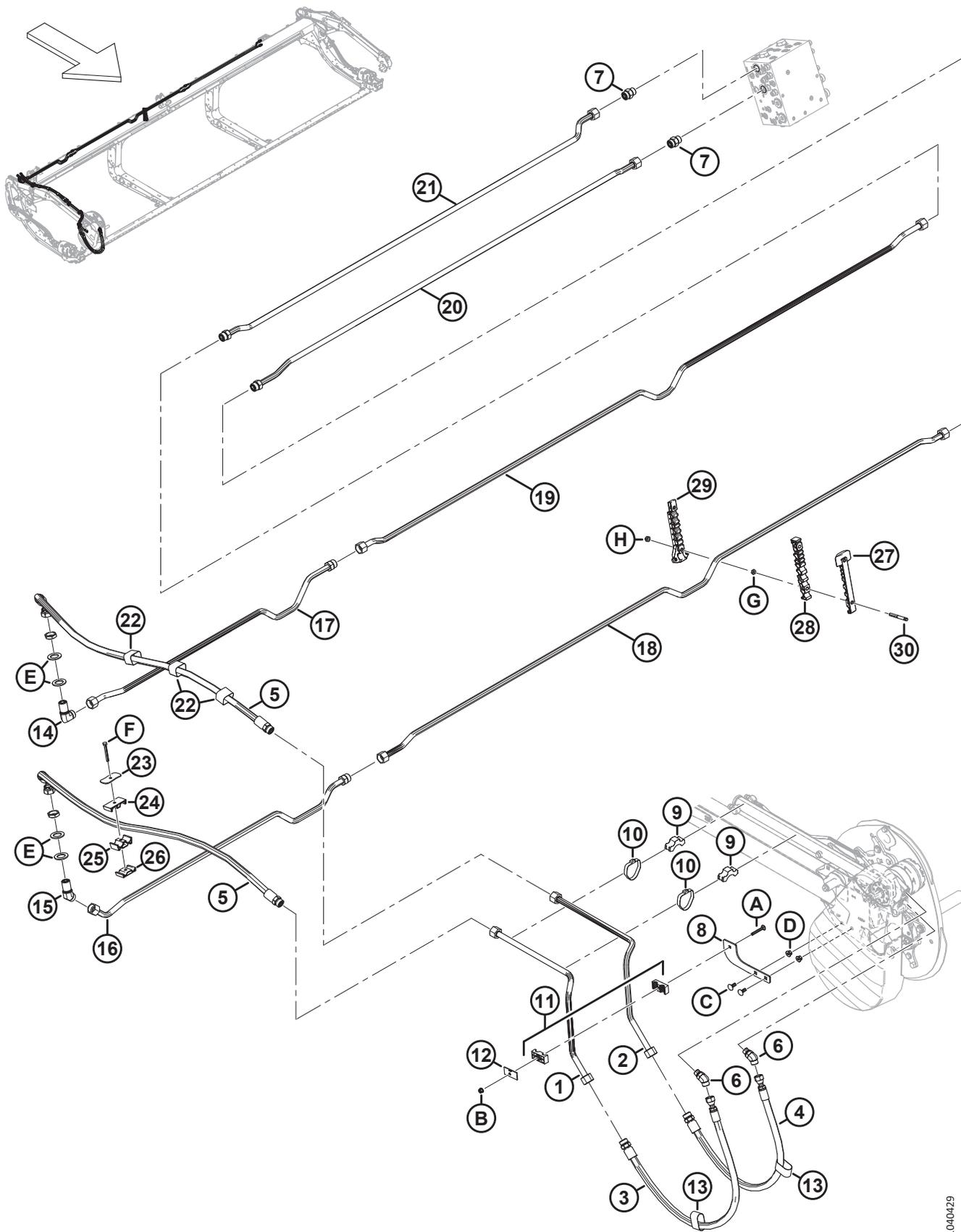
**ГИДРАВЛИКА — ПРИВОД МОТОВИЛА, ОДИНАРНОЕ МОТОВИЛО**
