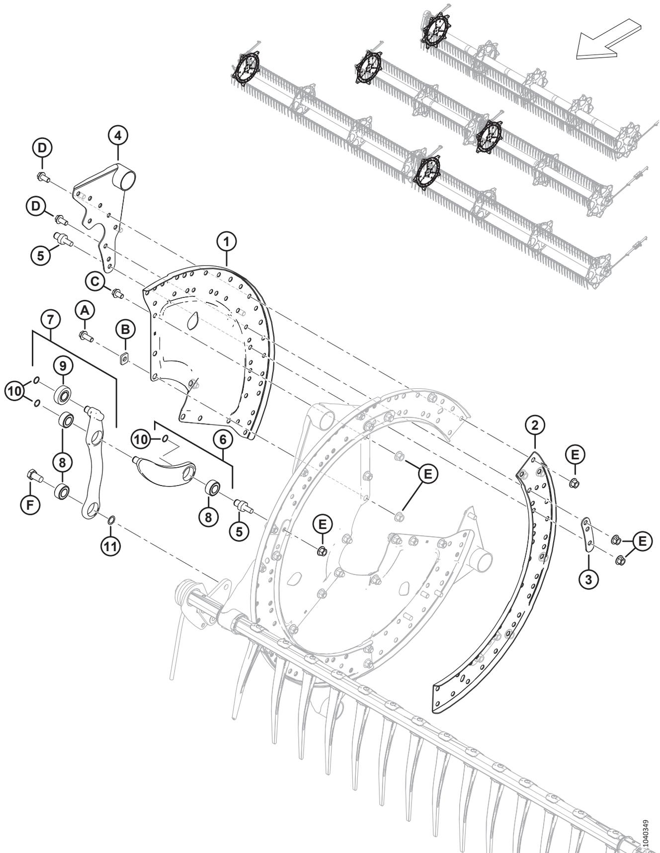
**ДИСКИ МОТОВИЛА — СТОРОНА ЭКСЦЕНТРИКА И СОЕДИНЕНИЕ**
