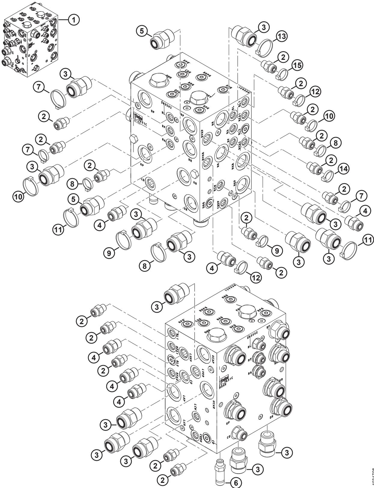
**ГИДРАВЛИЧЕСКОЕ ОБОРУДОВАНИЕ — ФИТИНГИ И КРЕПЕЖНЫЕ ДЕТАЛИ КОЛЛЕКТОРА**
