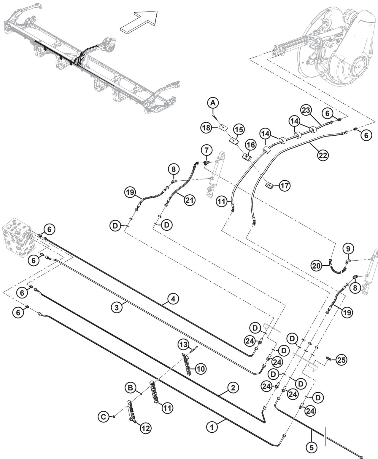
**ГИДРАВЛИЧЕСКОЕ ОБОРУДОВАНИЕ — ПОДЪЕМ И ПРОДОЛЬНОЕ ПЕРЕМЕЩЕНИЕ, СДВОЕННОЕ МОТОВИЛО,
