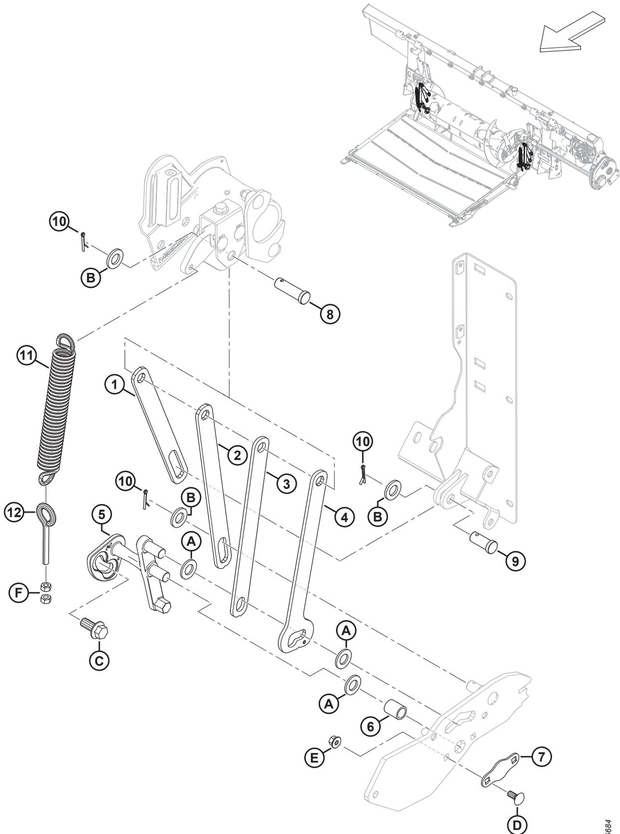
**РЫЧАЖНЫЙ МЕХАНИЗМ — ФЛОТАЦИИ ШНЕКА**
