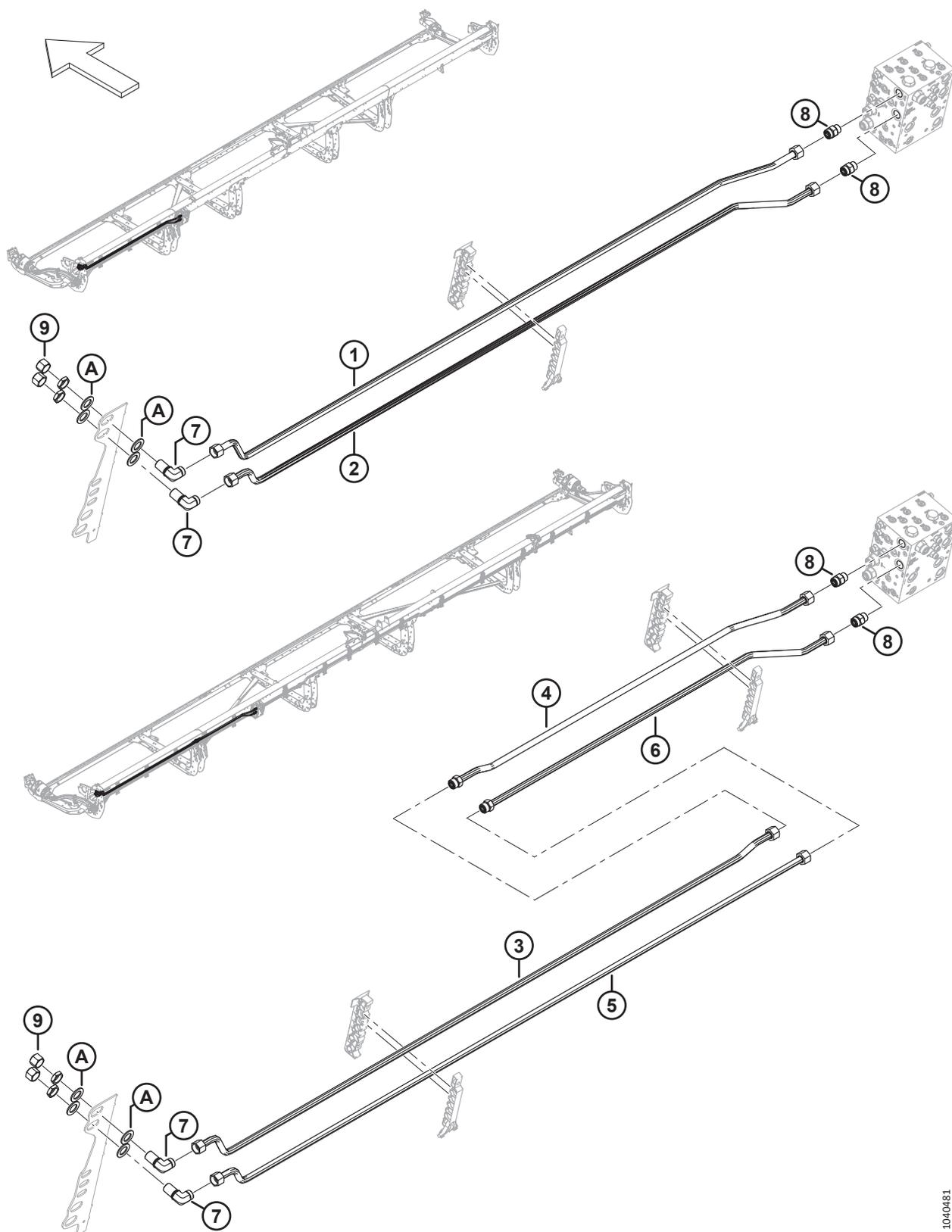
**ГИДРАВЛИЧЕСКОЕ ОБОРУДОВАНИЕ — ВЕРХНИЙ ПОПЕРЕЧНЫЙ ШНЕК**
