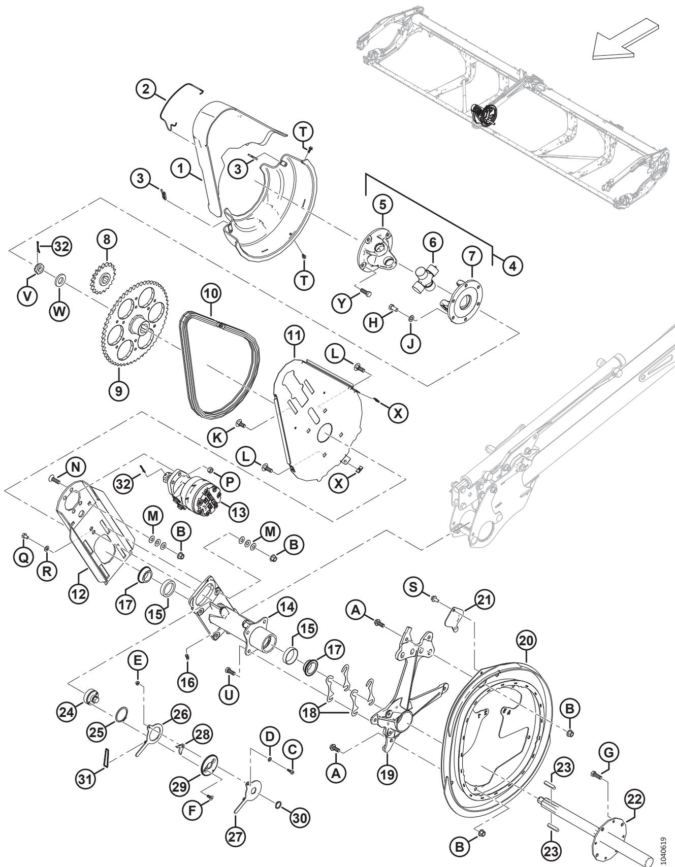
**ПРИВОД МОТОВИЛА — СДВОЕННОЕ МОТОВИЛО**
