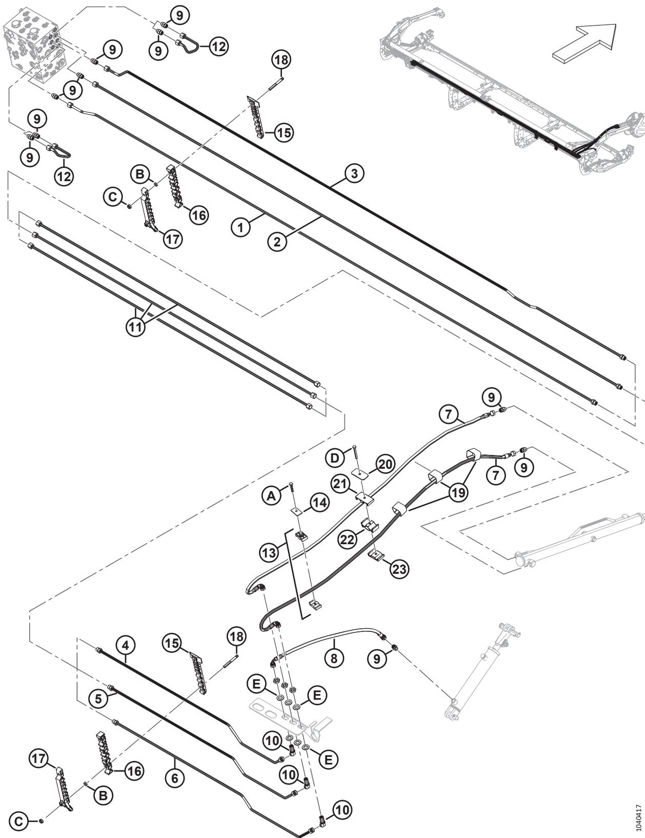
**ГИДРАВЛИЧЕСКОЕ ОБОРУДОВАНИЕ — ПОДЪЕМ И ПРОДОЛЬНОЕ ПЕРЕМЕЩЕНИЕ, ОДИНАРНОЕ МОТОВИЛО,
