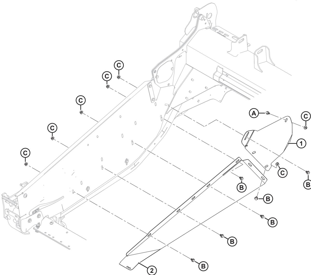
**ДЕФЛЕКТОРЫ ПОЛОТНА — УЗКИЕ**
