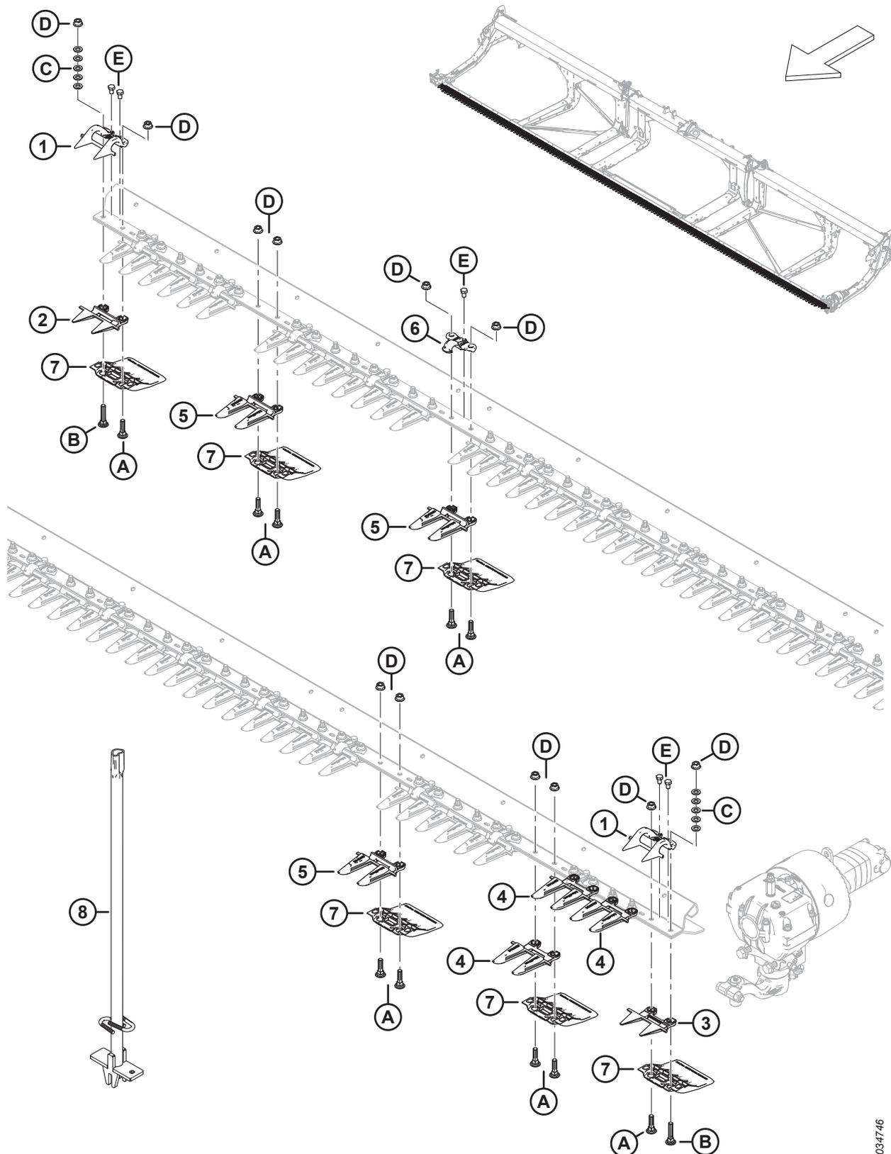
**ПРОТИВОРЕЖУЩИЕ ЗАОСТРЕННЫЕ ПАЛЬЦЫ, ПРИЖИМЫ И БАШМАКИ ПРОТИВОРЕЖУЩЕГО БРУСА —
