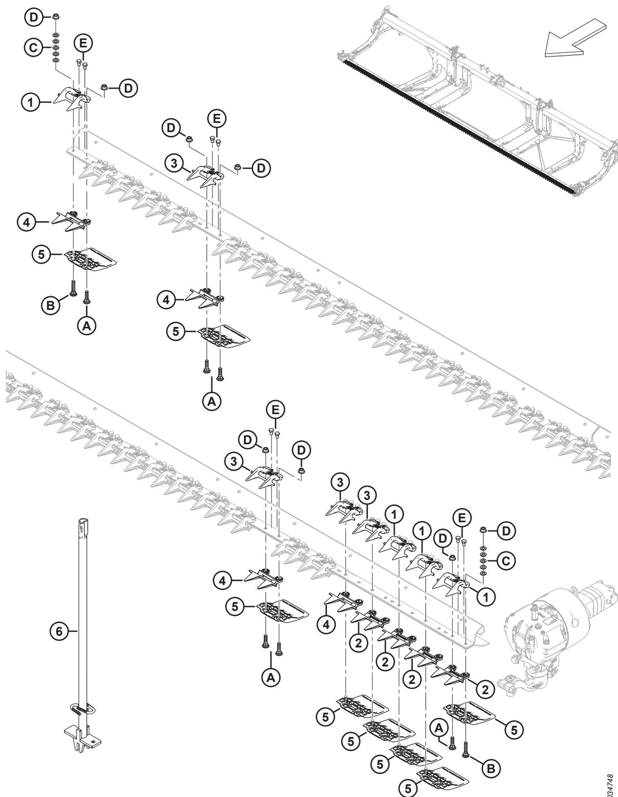
**ПРОТИВОРЕЖУЩИЕ ПАЛЬЦЫ, ПРИЖИМЫ И БАШМАКИ НОЖЕВОГО БРУСА — ОДИНАРНЫЙ НОЖ, PLUGFREE™
