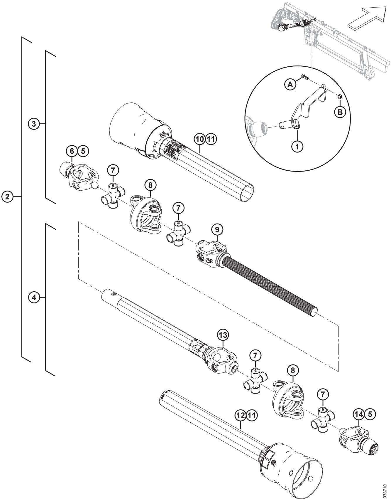
**ПРИВОДНОЙ ВАЛ И ОПОРЫ — БОЛЬШОЙ УГОЛ**
