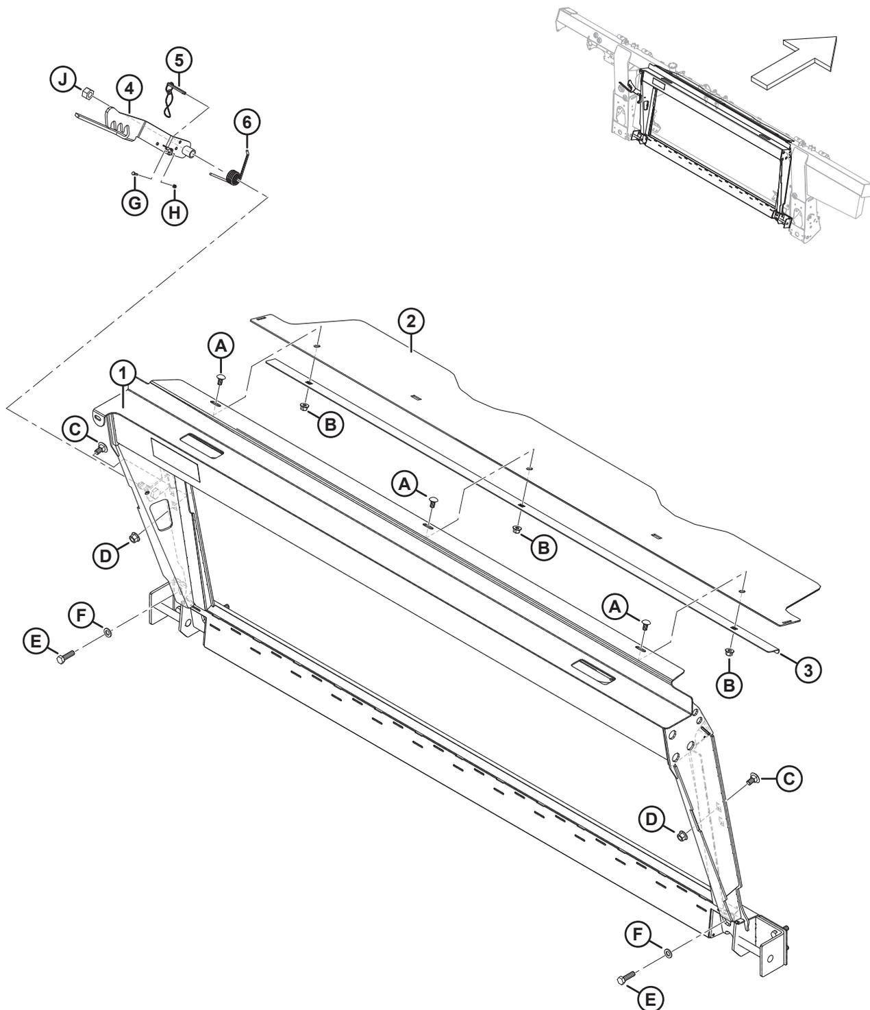
**NEW HOLLAND CR/CX — КОМПЛЕКТ ДООСНАЩЕНИЯ КОПИРУЮЩЕГО МОДУЛЯ**
