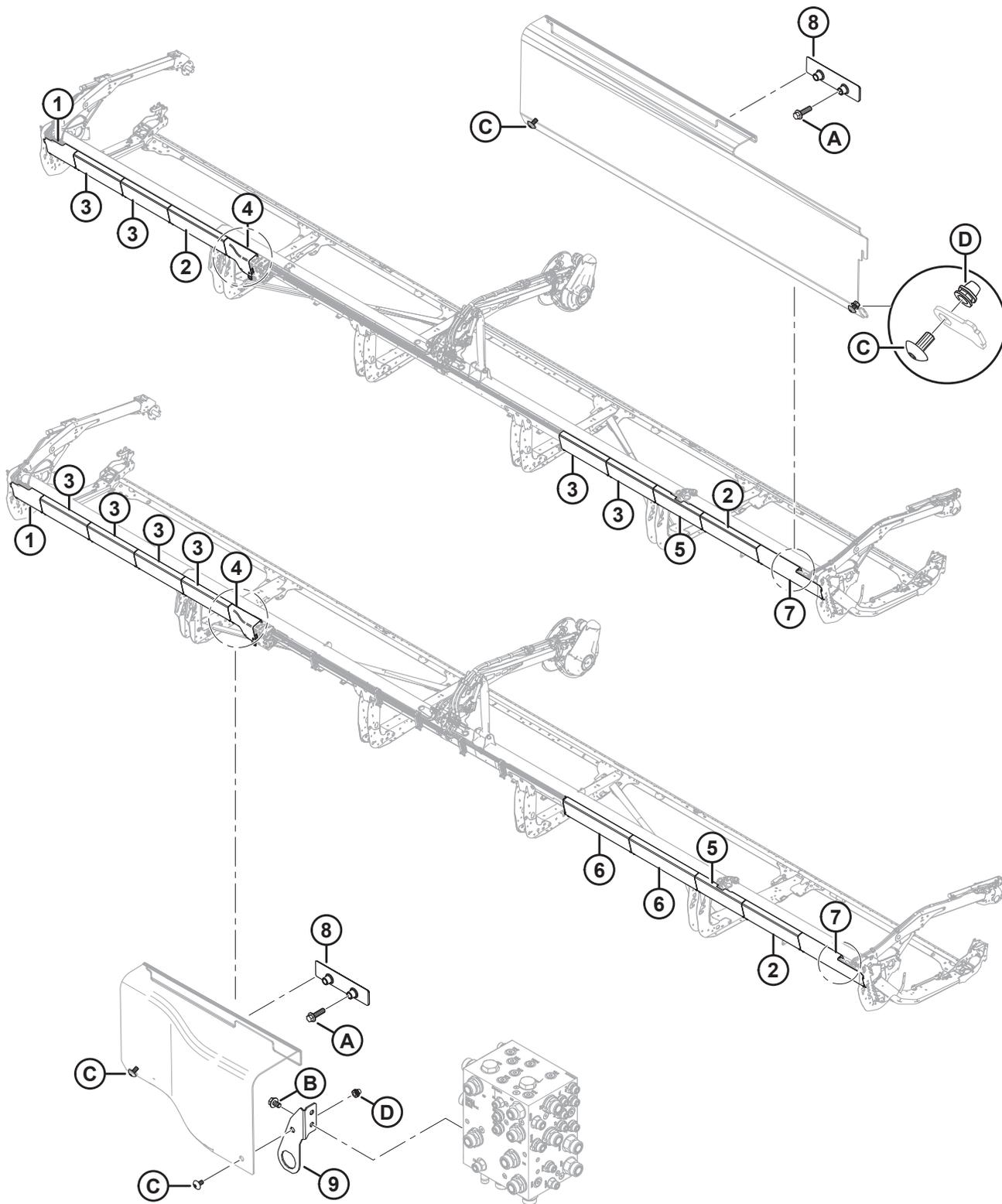
**КРЫШКИ ГИДРАВЛИЧЕСКОЙ ЛИНИИ (D241 И D245)**
