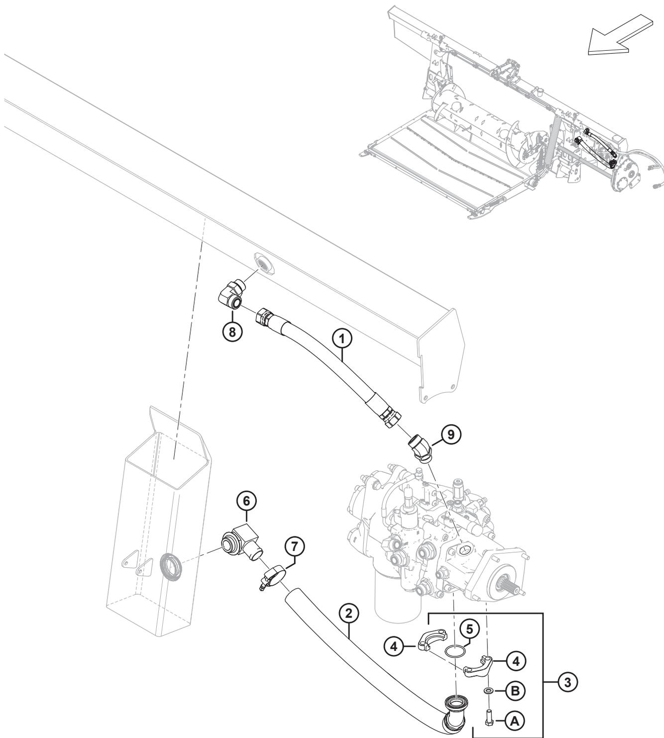
**ГИДРАВЛИЧЕСКОЕ ОБОРУДОВАНИЕ — ВСАСЫВАНИЕ И ВОЗВРАТ**
