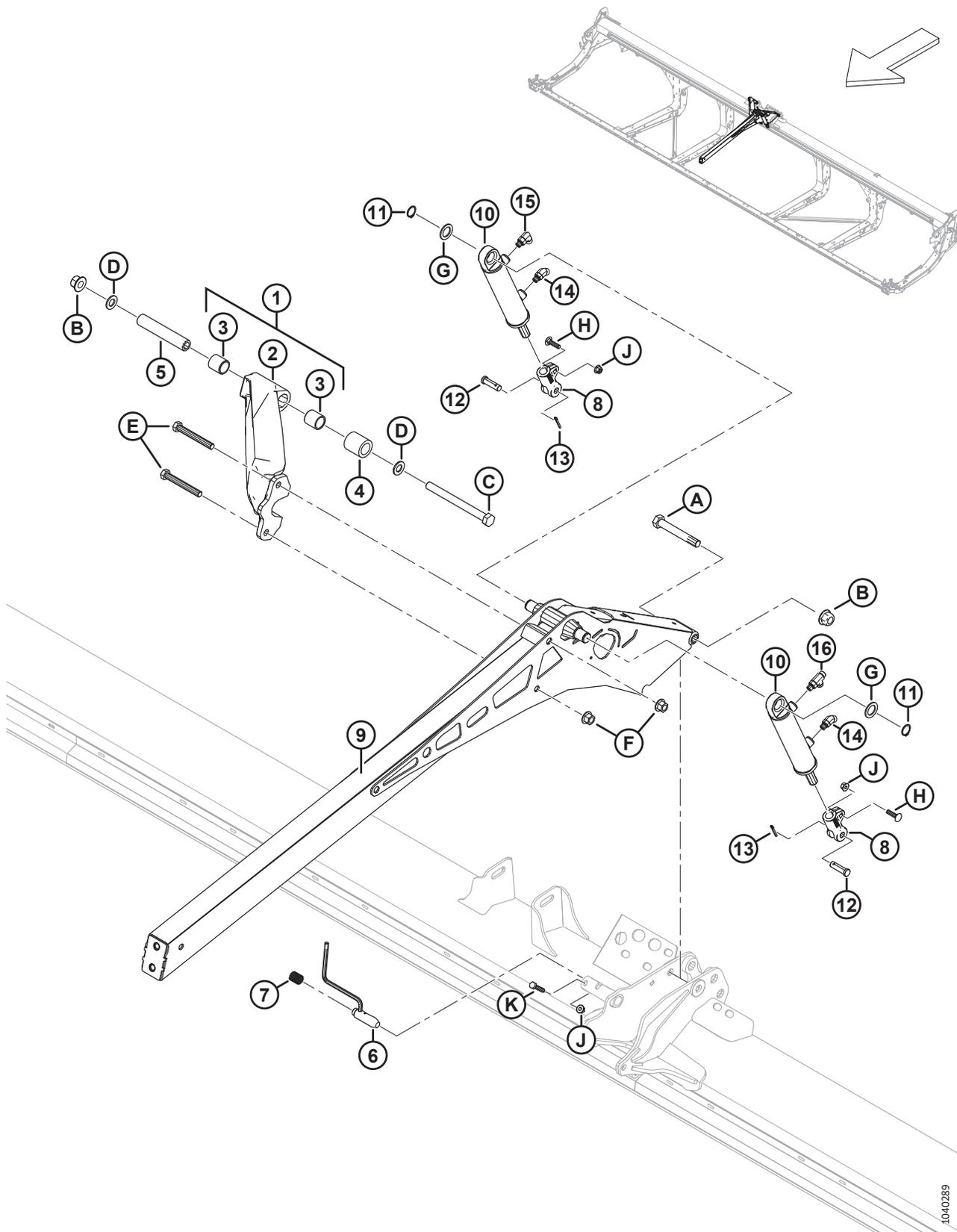
РЫЧАГ ОПОРЫ МОТОВИЛА И ПОДЪЕМНЫЕ ЦИЛИНДРЫ — ЦЕНТРАЛЬНЫЙ РЫЧАГ, СДВОЕННОЕ МОТОВИЛО
