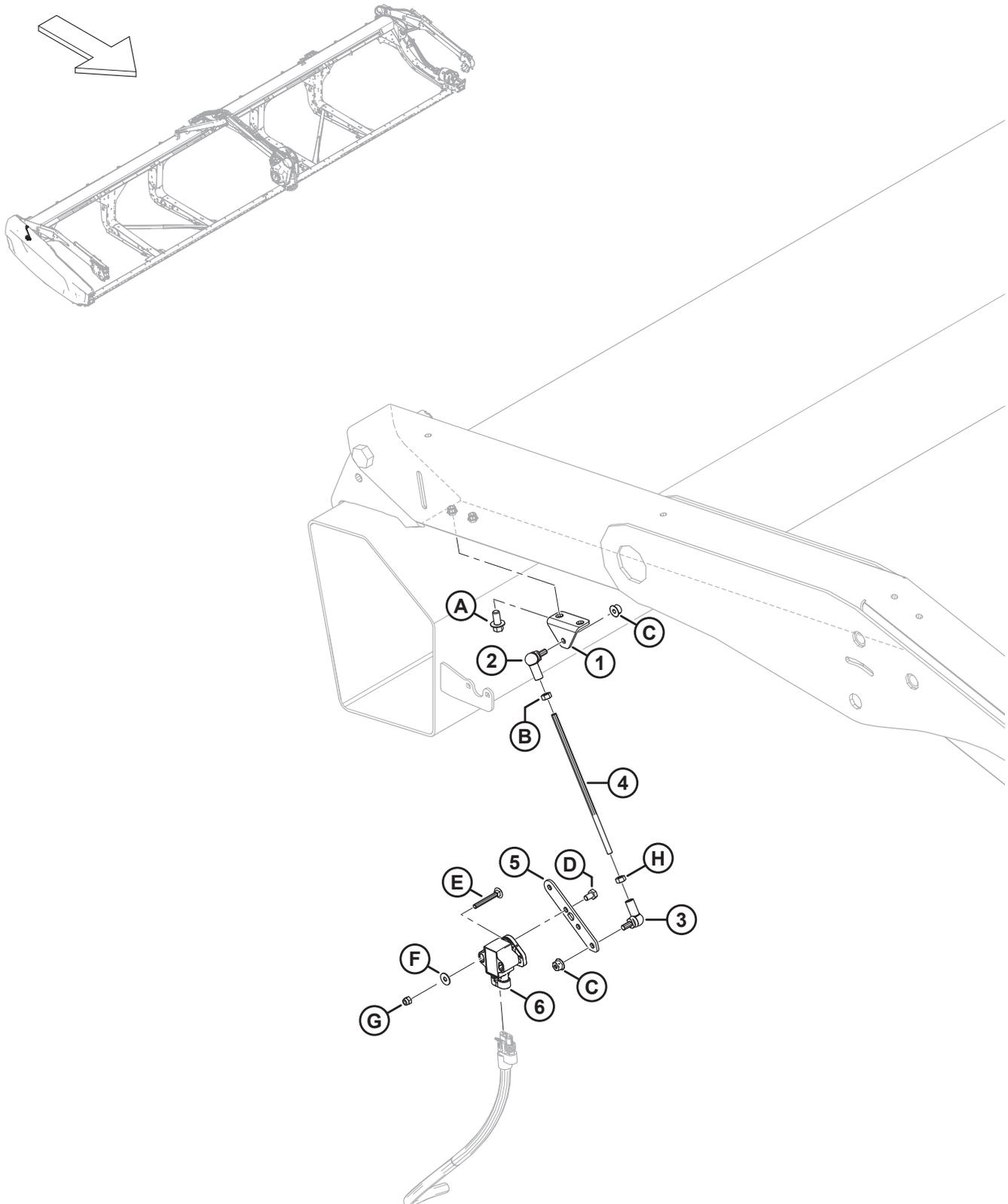
**ЭЛЕКТРИЧЕСКОЕ ОБОРУДОВАНИЕ — ДАТЧИК ВЫСОТЫ МОТОВИЛА**
