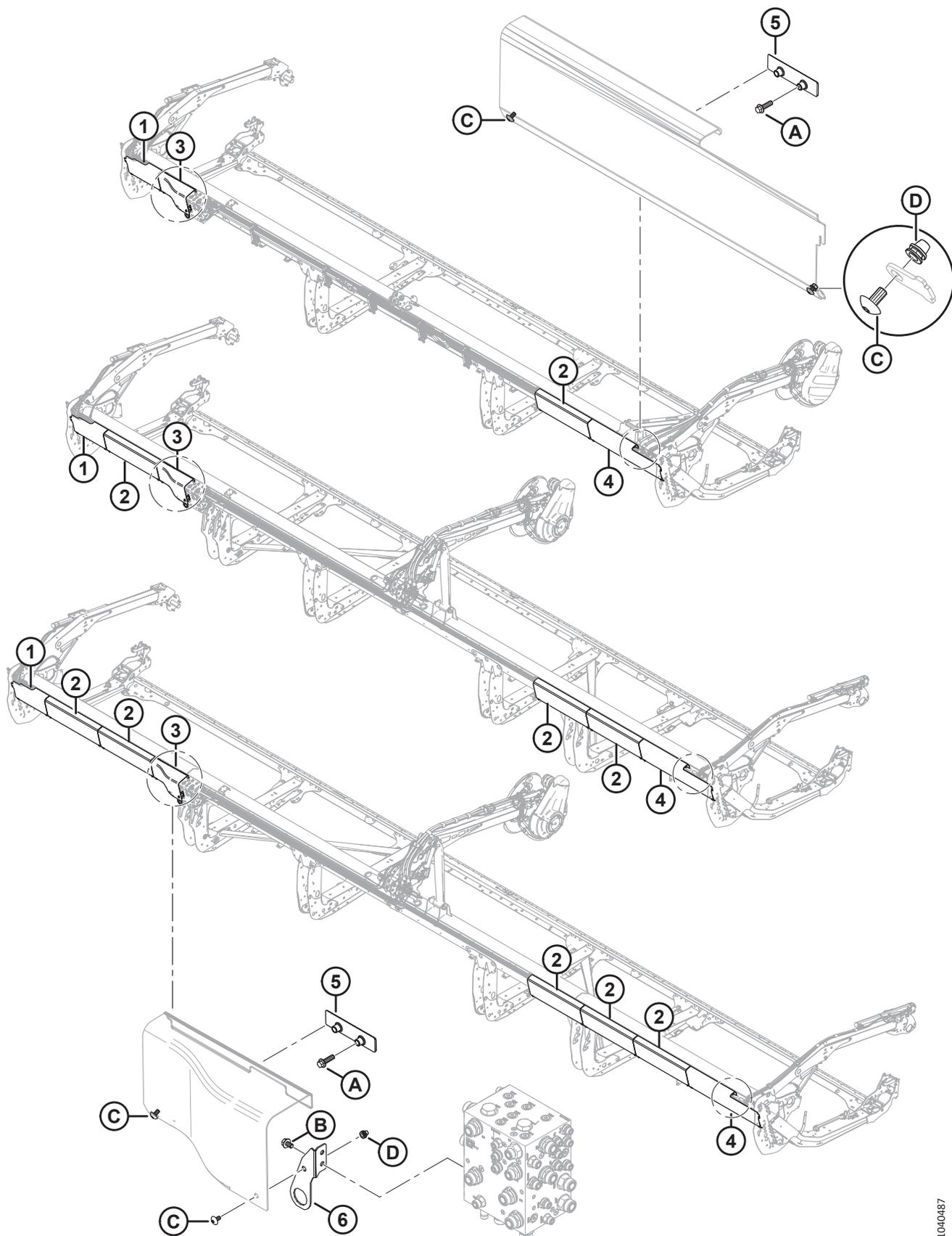
**КРЫШКИ ГИДРАВЛИЧЕСКОЙ ЛИНИИ (D225, D230 И D235)**
