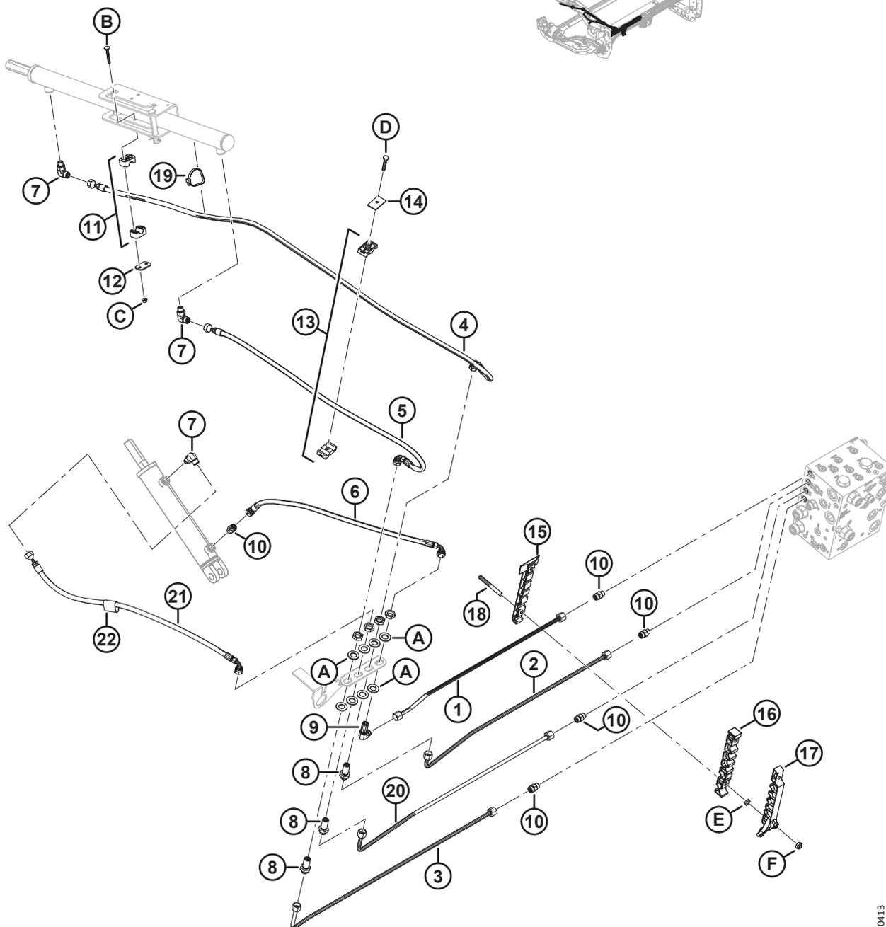
**ГИДРАВЛИЧЕСКОЕ ОБОРУДОВАНИЕ — ПОДЪЕМ И ПРОДОЛЬНОЕ ПЕРЕМЕЩЕНИЕ, ОДИНАРНОЕ МОТОВИЛО,
