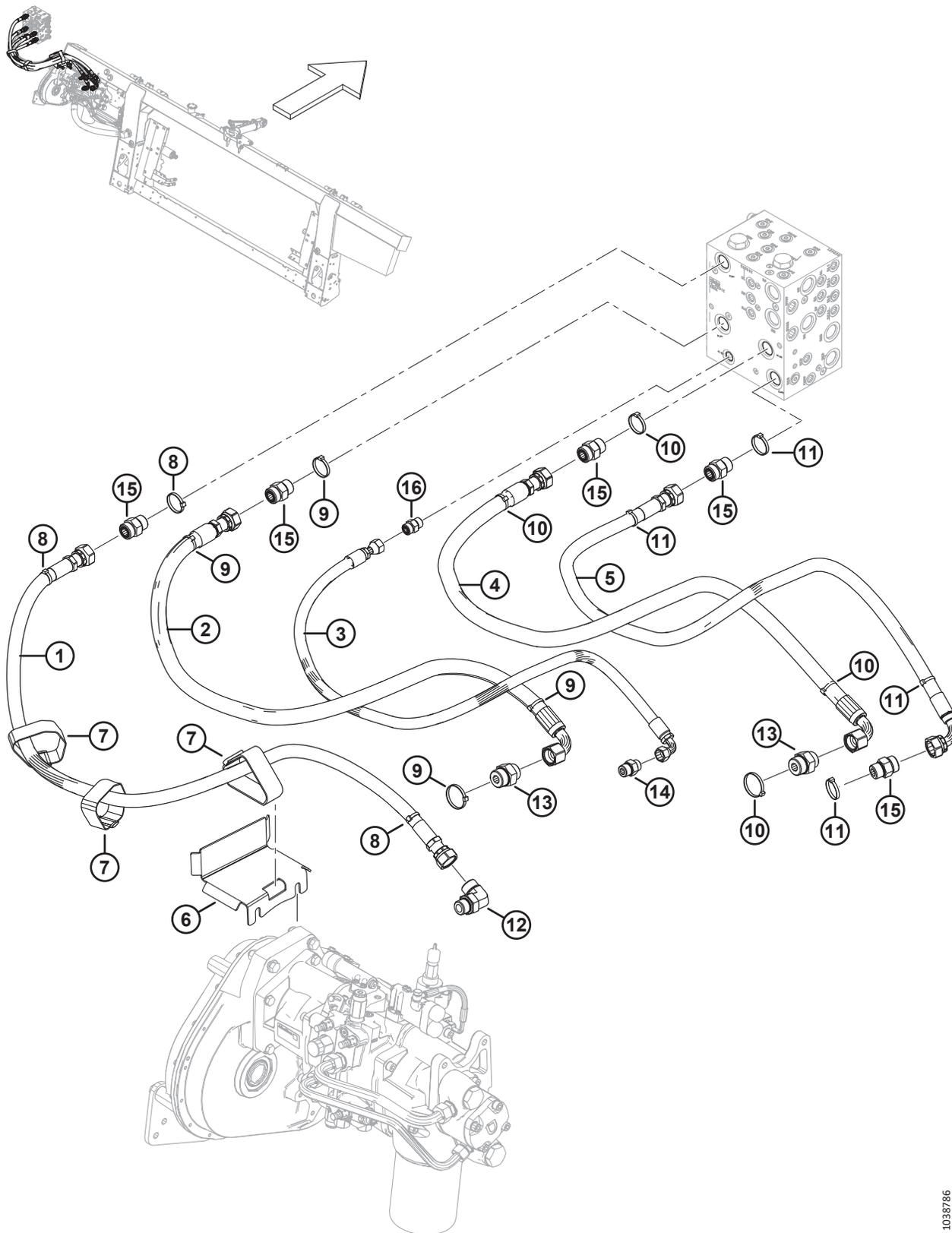
**ГИДРАВЛИЧЕСКОЕ ОБОРУДОВАНИЕ — ОТ КОПИРУЮЩЕГО МОДУЛЯ ДО РАСПРЕДЕЛИТЕЛЯ ЖАТКИ**
