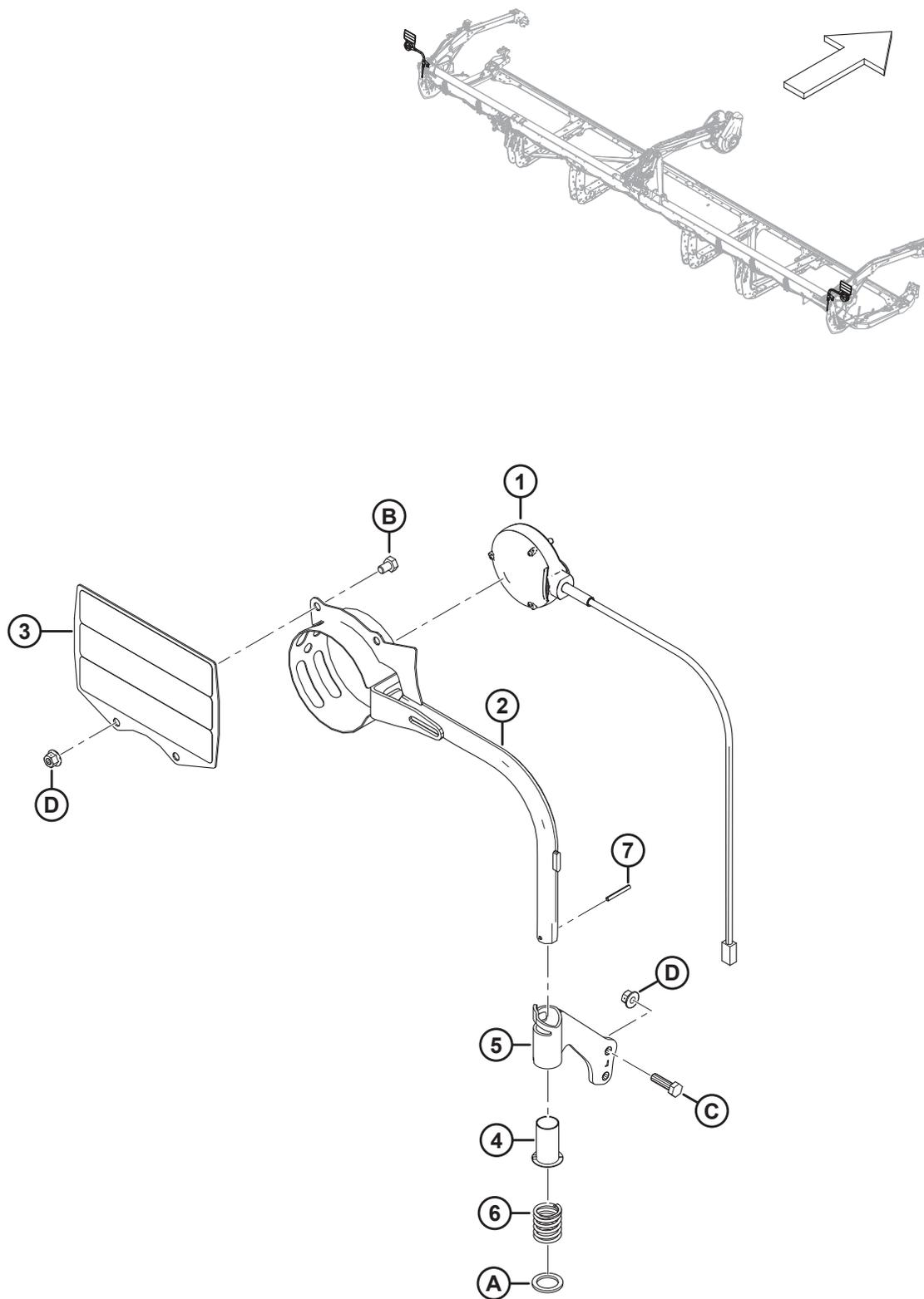
**ЭЛЕКТРИЧЕСКОЕ ОБОРУДОВАНИЕ — ГАБАРИТНЫЕ ФОНАРИ**
