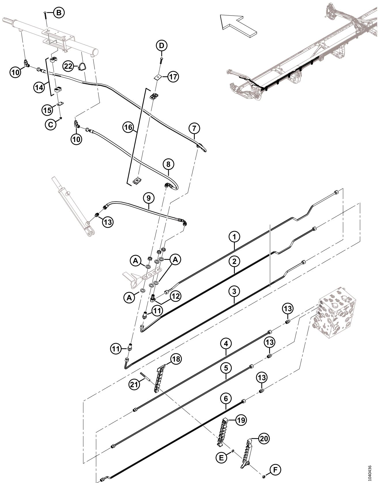
**SYSTÈME HYDRAULIQUE – LEVAGE ET MARCHE AVANT-ARRIÈRE, RABATTEUR DOUBLE, BRAS GAUCHE (D245)**
