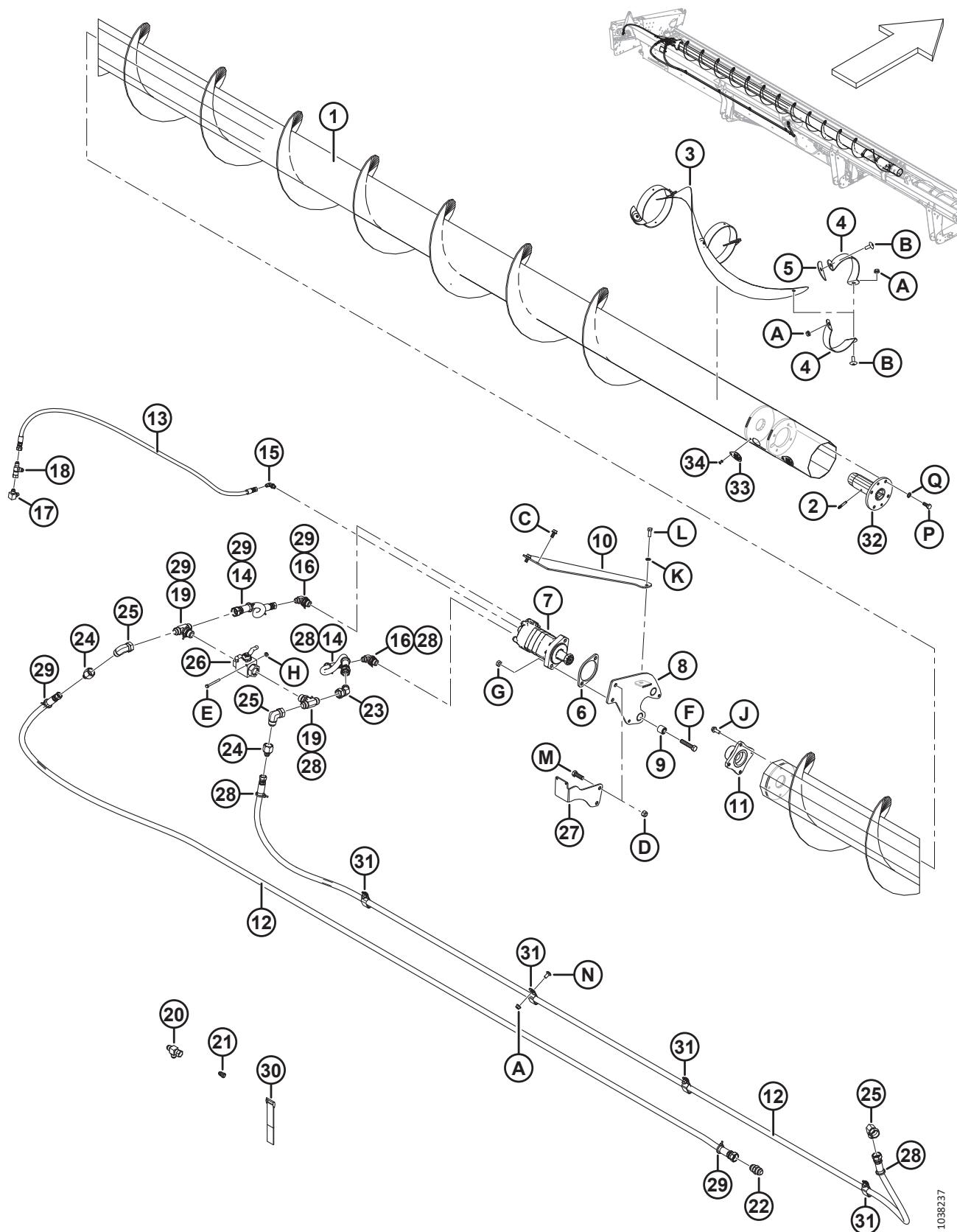
( 选件 ) 辅助螺旋输送套件 - 左端 , D145 ( 2022 年及以后制造的型号 )
