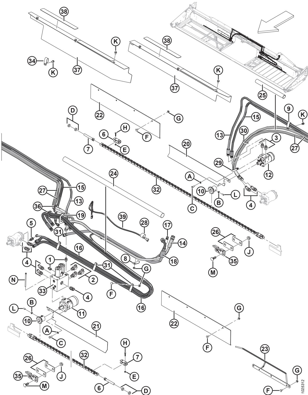
输送带驱动装置 - 液压输送带支承平移 ( D130、D135 和 D140 )
