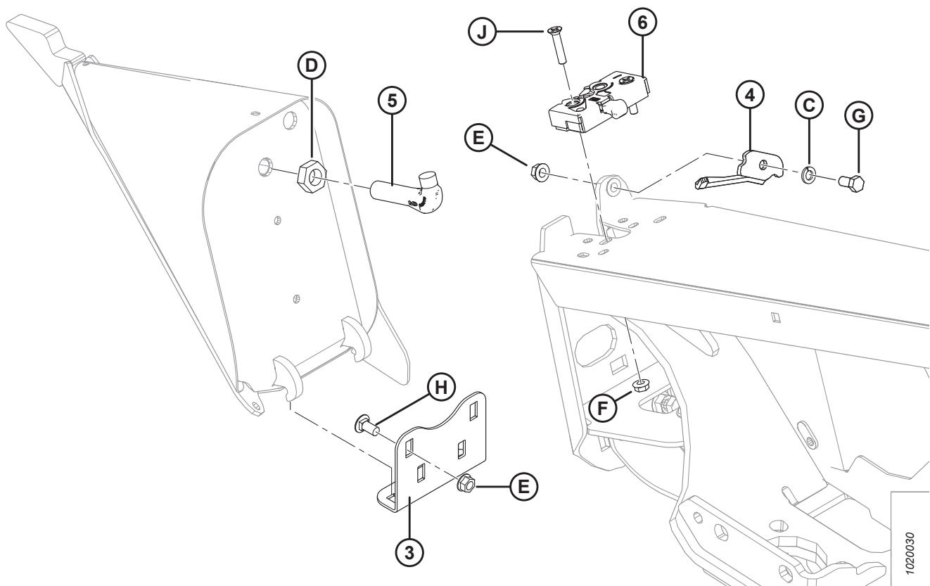
(选件) 适用于中间拨禾轮臂的短支架套件/分禾器闩锁
