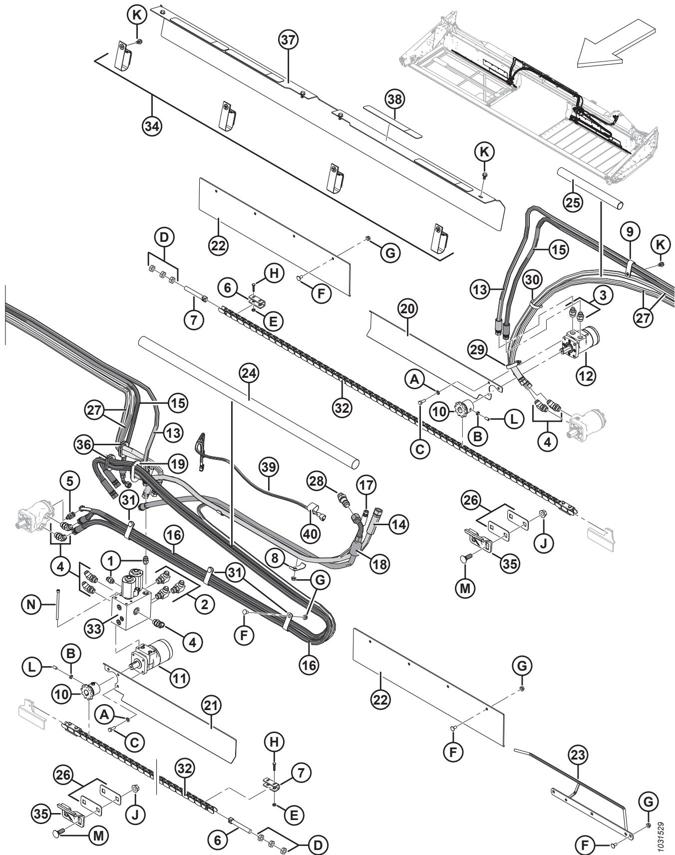
输送带驱动装置 – 液压输送带支承平移 (**D125**) – 2019 年及以前的型号
