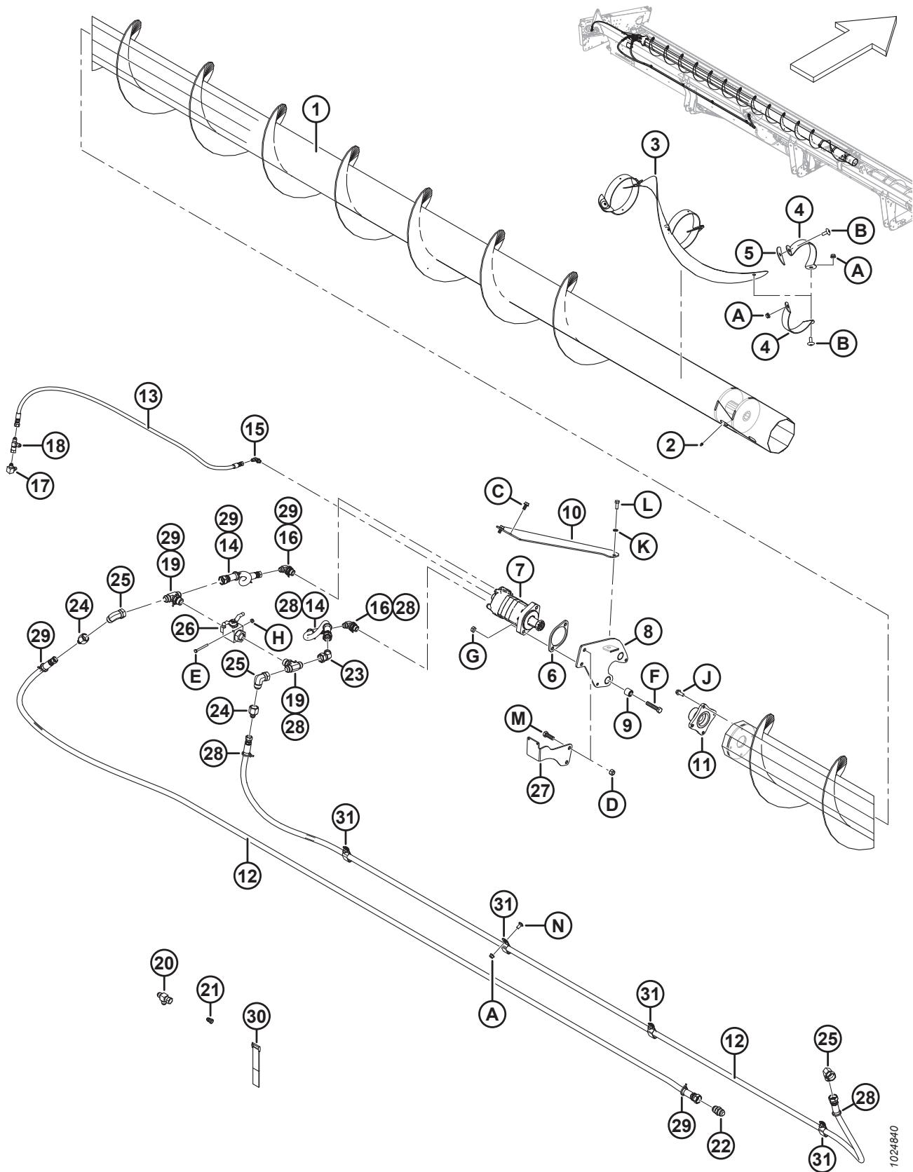
(选件) 辅助螺旋输送套件 - 左端, D145 (2021 年及以前制造的型号)
