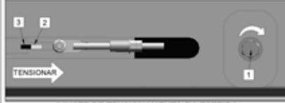
**AJUSTE DE TENSIONAMENTO DA ESTEIRA**
