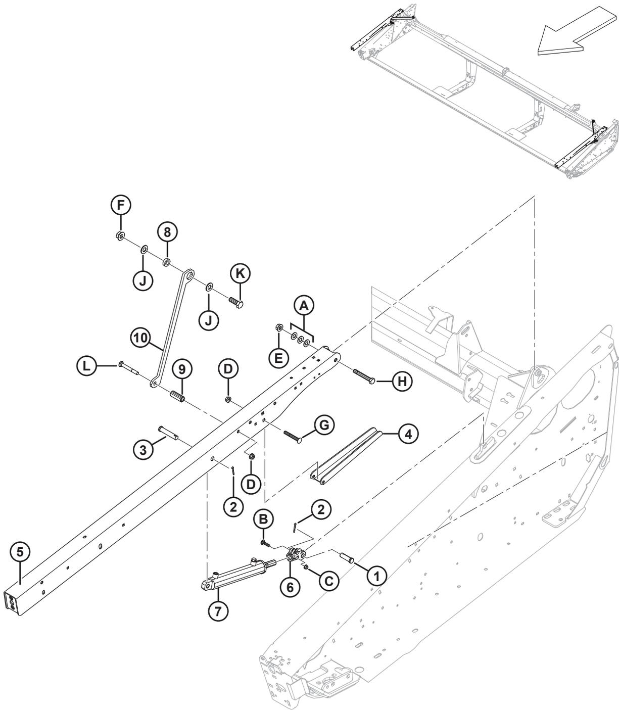
**TĪTAVU BALSTA SVIRAS UN CELŠANAS CILINDRI**
