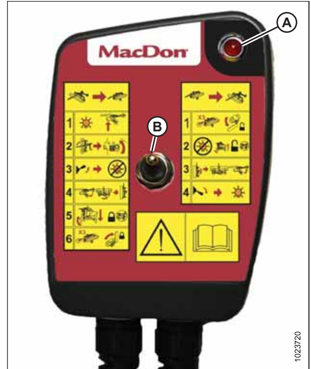
Figure 5.27: Commande à distance du transport
