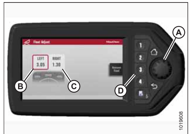
Рисунок 8.7: Настройки правой/левой флотации НРТ
