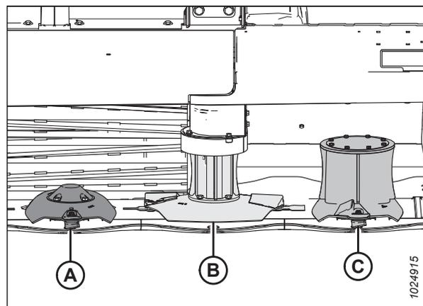
Figure 4.187: Ensemble du disque de la barre de coupe –R116 PT illustré, R113 PT identique
