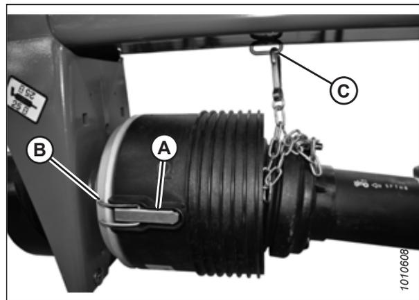
Figure 4.214: Cône de protection de la transmission et verrou de fixation à levier
