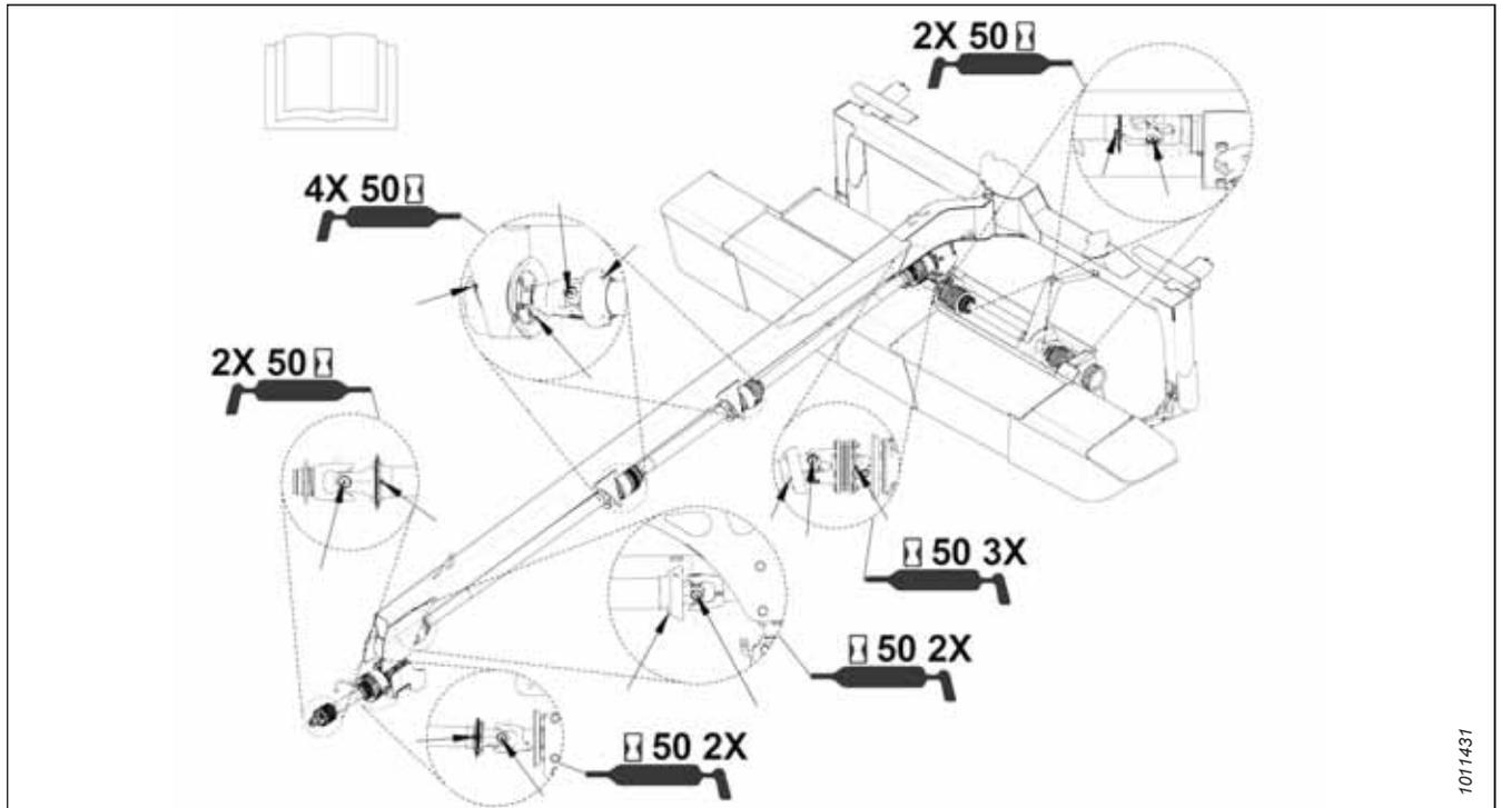
Figure 4.13: Emplacement de graissage (toutes les 50 heures)
