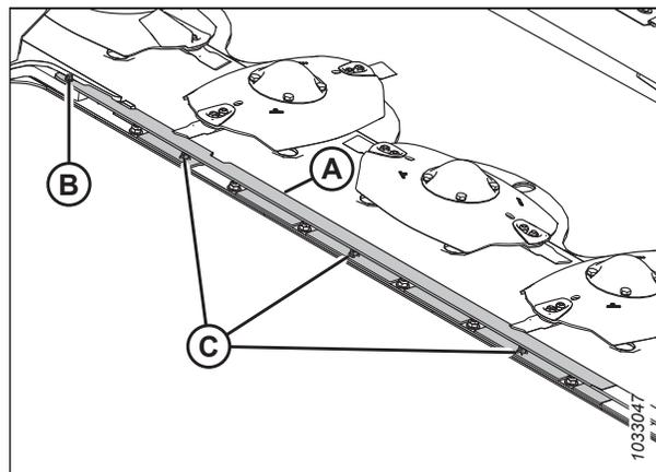
Figure 3.113: Déflecteur de la barre de coupe – Côté gauche
