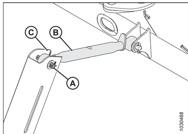
Figure 4.364: Vérin d'inclinaison mécanique
