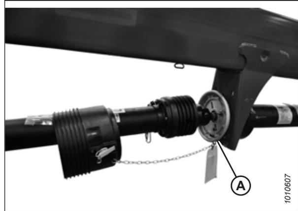
Figure 4.213: Cône de protection de la transmission retiré de la plaque métallique
