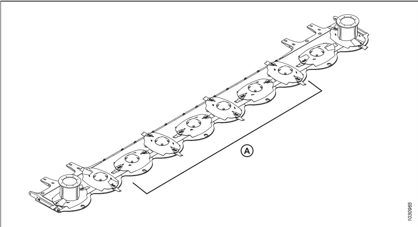
Figure 4.44: Disques de la barre de coupe interchangeables
