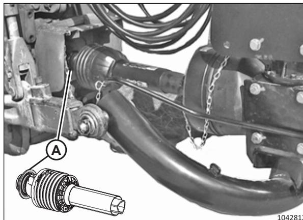
Figure 3.28: Transmission fixée à la PF du tracteur
