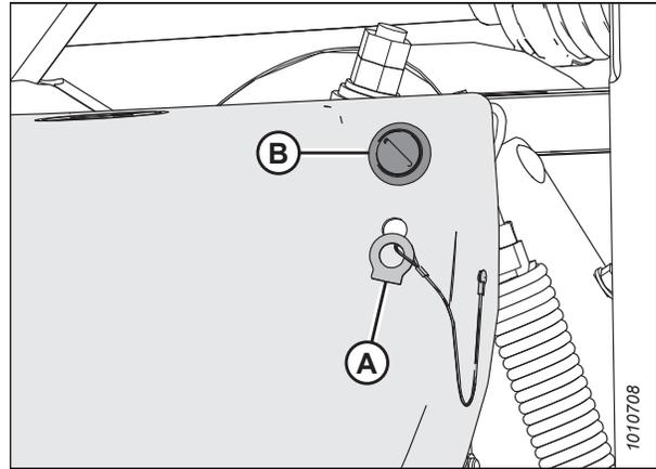
Figure 4.204: Outil pour déverrouiller le carter de transmission et le verrou
