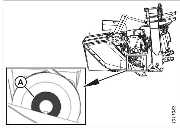
Figure 4.322: Roulement gauche du conditionneur à rouleaux
