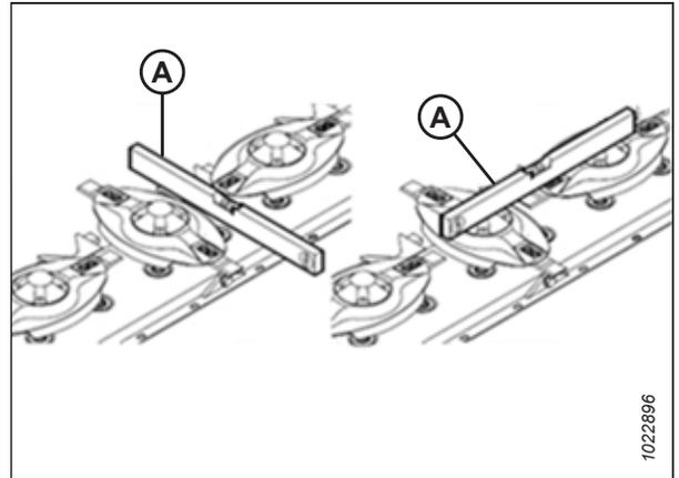
Figure 4.38: Niveau à bulle sur la barre de coupe
