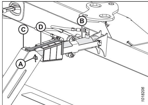
Figure 4.339: Vérin d'inclinaison hydraulique et indicateur
