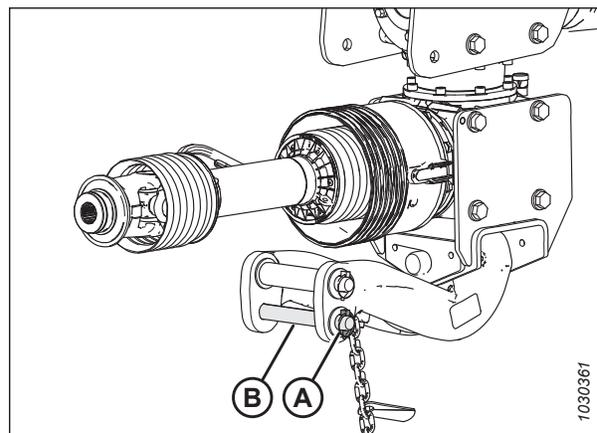
Figure 3.20: Attelage de la faucheuse à disques de type tracté
