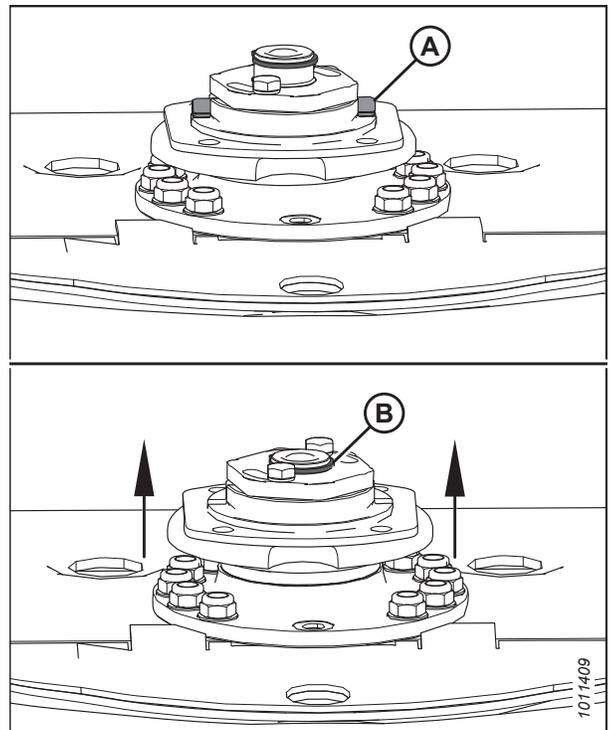
Figure 4.185: Pivots de la barre de coupe
