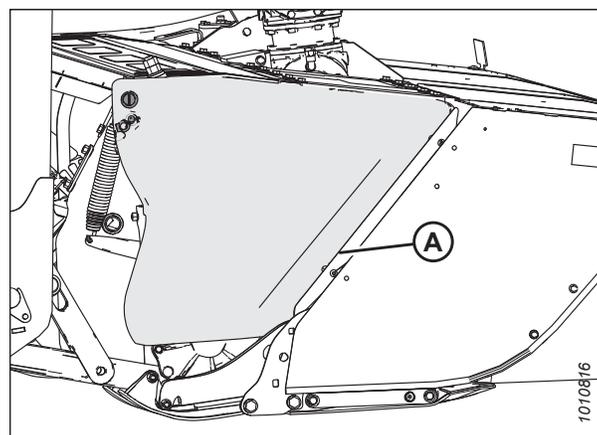
Figure 4.286: Blindage de la transmission du côté droit
