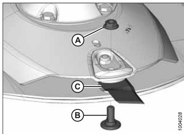
Figure 4.88: Lame de disques
