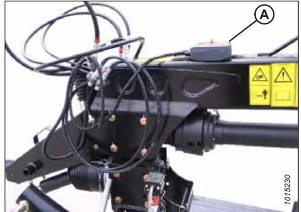
Figure 3.34: Boîtier de commande
