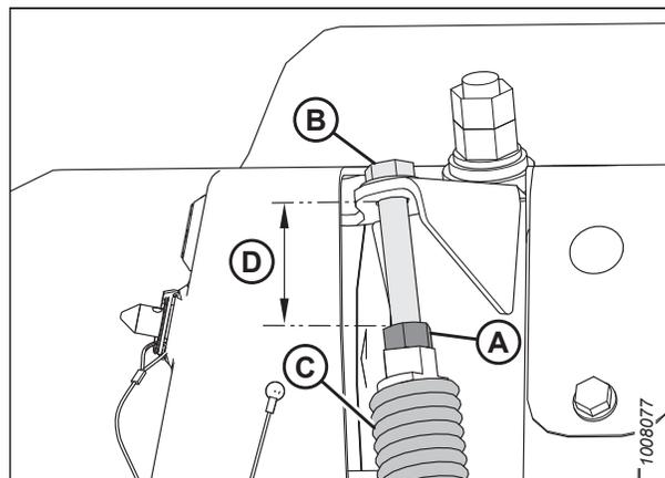
Figure 3.123: Réglage de la tension des rouleaux
