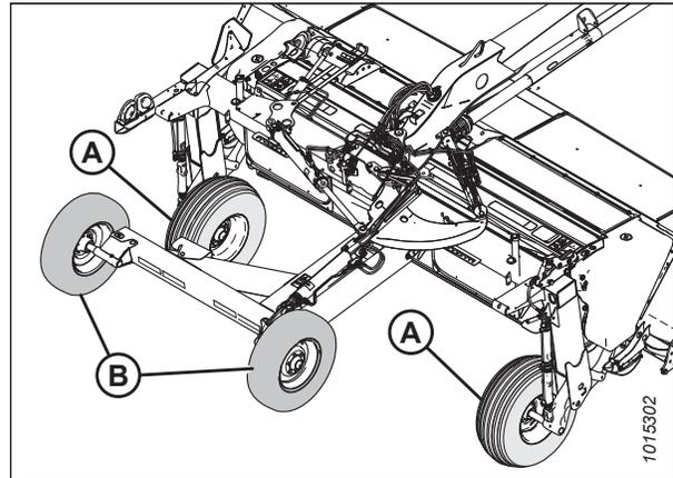
Figure 4.314: Roues de travail et roues de transport
