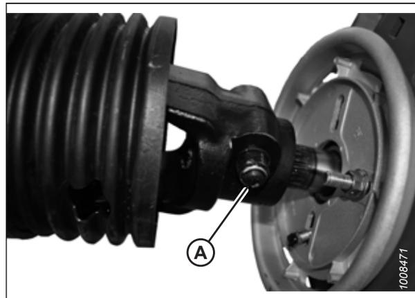
Figure 4.219: Boulon fixant la transmission à la boîte de vitesses
