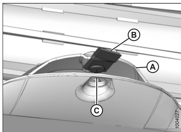
Figure 4.87: Lame de disques alignée avec le trou dans la jupe pare-pierres
