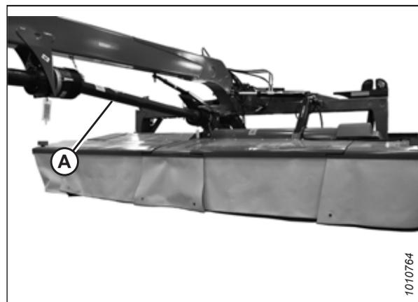
Figure 4.242: Transmission de l'embrayage
