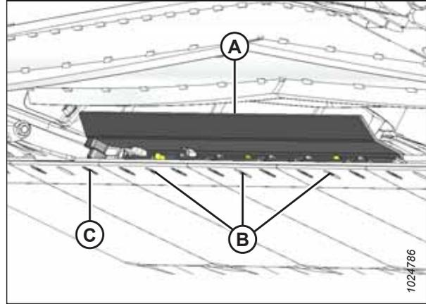
Figure 3.112: Déflecteur gauche de la barre de coupe vu du dessous de la barre de coupe
