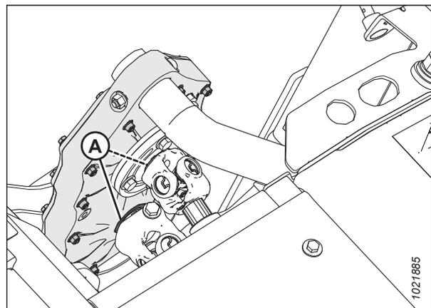
Figure 4.324: Roulements de la boîte de vitesses de synchronisation des rouleaux
