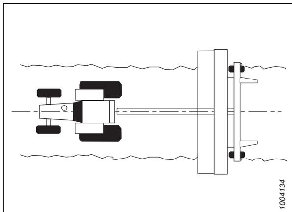
Figure 3.99: Faucheuse à disques de type tracté centré à l'arrière du tracteur
