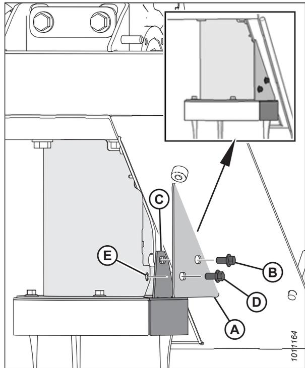
Figure 4.175: Plaque de recouvrement et plaque supérieure
