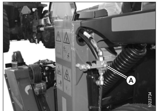
Figure 4.375: Clapets de verrouillage du vérin de levage – position fermée
