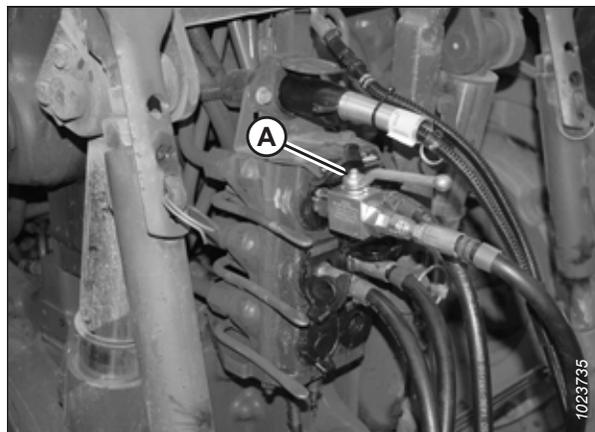
Figure 3.72: Vanne de verrouillage de la direction en position ouverte
