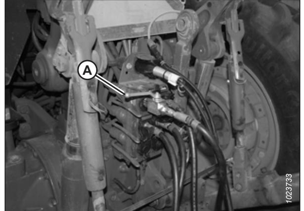
Figure 3.71: Clapet de verrouillage de rotation d'attelage montré en position fermée
