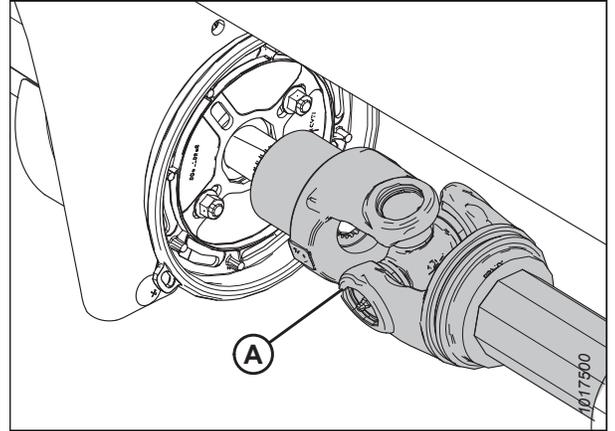
Figure 4.227: Fourche de l'arbre de transmission intermédiaire
