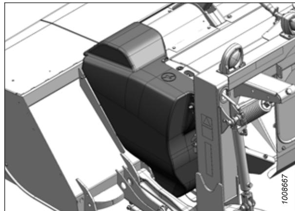
Figure 4.328: Blindage d'entraînement – côté gauche
