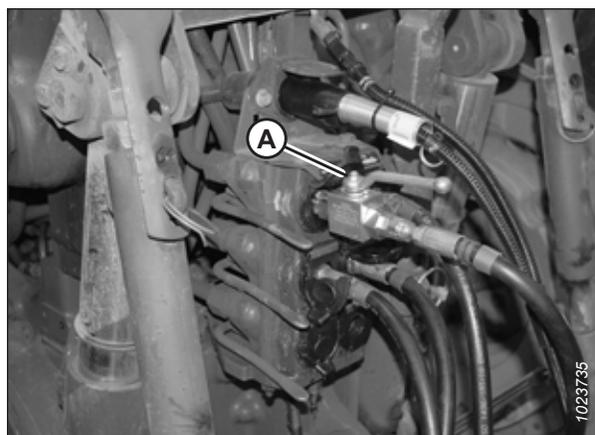
Figure 3.55: Vanne du circuit de direction en position de travail (ouverte)
