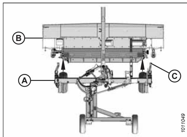
Figure 4.360: Châssis porteur aligné avec la plateforme
