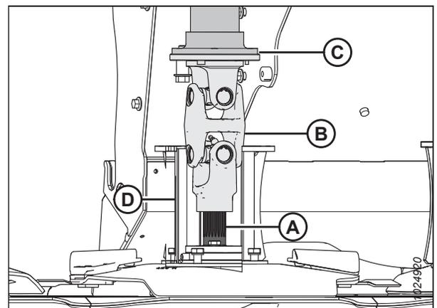
Figure 4.142: Connexion entre l'entraînement de moyeu et la transmission
