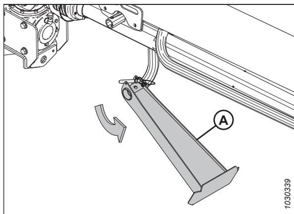
Figure 3.30: Repositionnement de la béquille d'attelage
