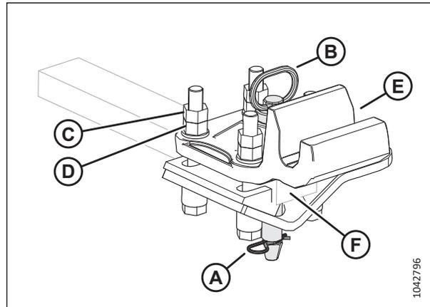
Figure 3.18: Adaptateur du crochet d'attelage de catégorie 3
