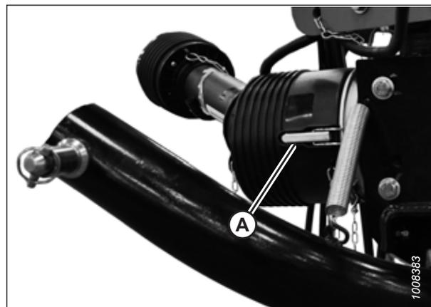
Figure 4.218: Cône de protection de la transmission et verrou de fixation à levier
