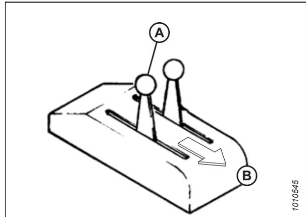
Figure 3.60: Levier de commande de direction du tracteur
