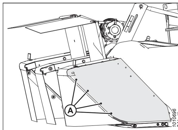
Figure 4.36: Plateau d'extrémité gauche
