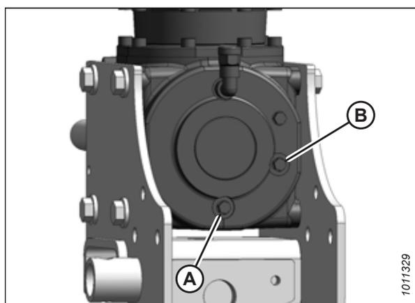
Figure 4.306: Bouchon de vidange de la boîte de vitesses
