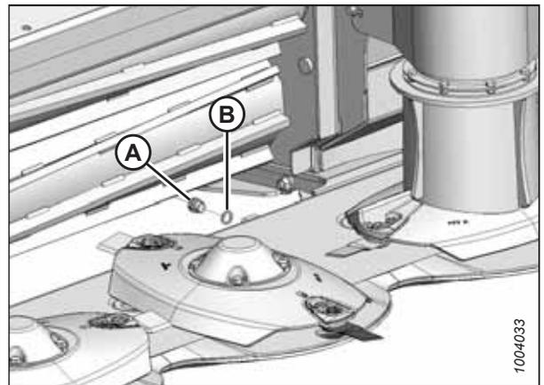
Figure 4.39: Bouchon d'inspection d'huile de barre de coupe
