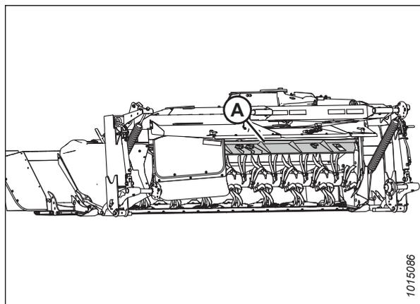
Figure 3.141: Déflecteur arrière, conditionneur à peigne
