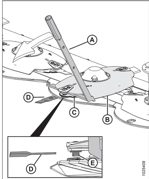
Figure 4.104: Installation des lames à changement rapide
