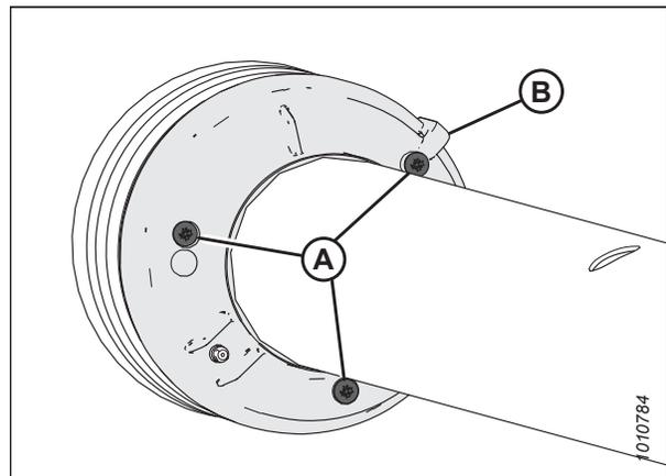
Figure 4.269: Vis cruciformes installées sur le cône de base
