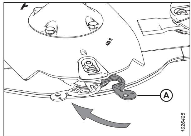
Figure 4.94: Vérification des boulons de retenue
