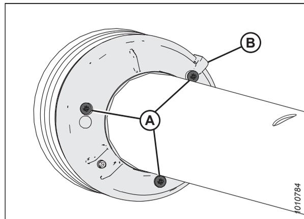
Figure 4.275: Vis cruciformes installées sur le cône de base
