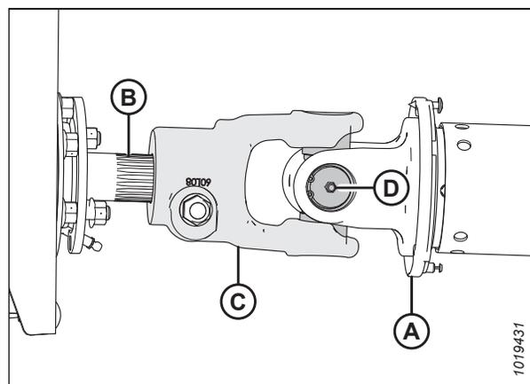
Figure 4.251: Transmission de l'embrayage du R116 PT
