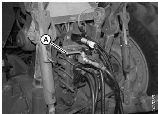
Figure 3.74: Clapet de verrouillage de la direction en position fermée
