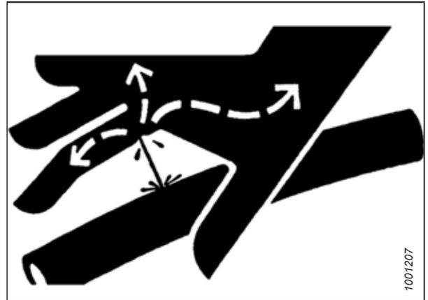
Figure 4.315: Risque lié à la pression hydraulique
