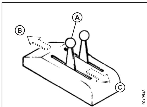
Figure 3.56: Positions du levier de commande de direction du tracteur
