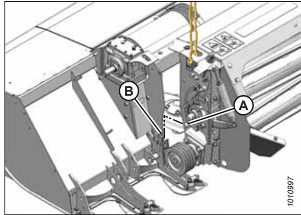
Figure 4.353: Goupilles de la conditionneuse
