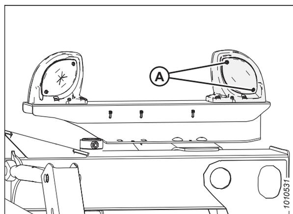
Figure 4.317: Optique en plastique et vis
