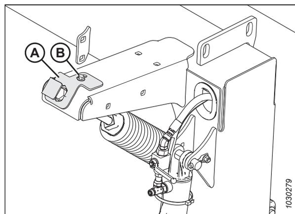
Figure 3.103: Plaque de recouvrement du boulon de réglage
