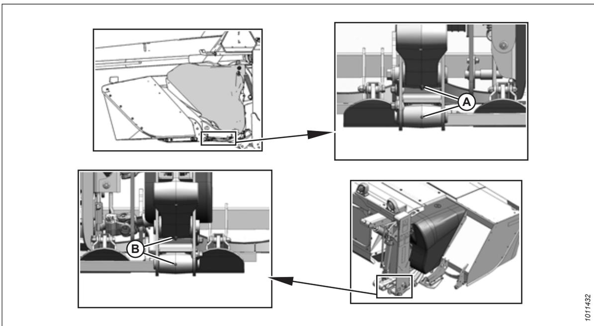
Figure 4.12: Emplacement de graissage (toutes les 25 heures)
