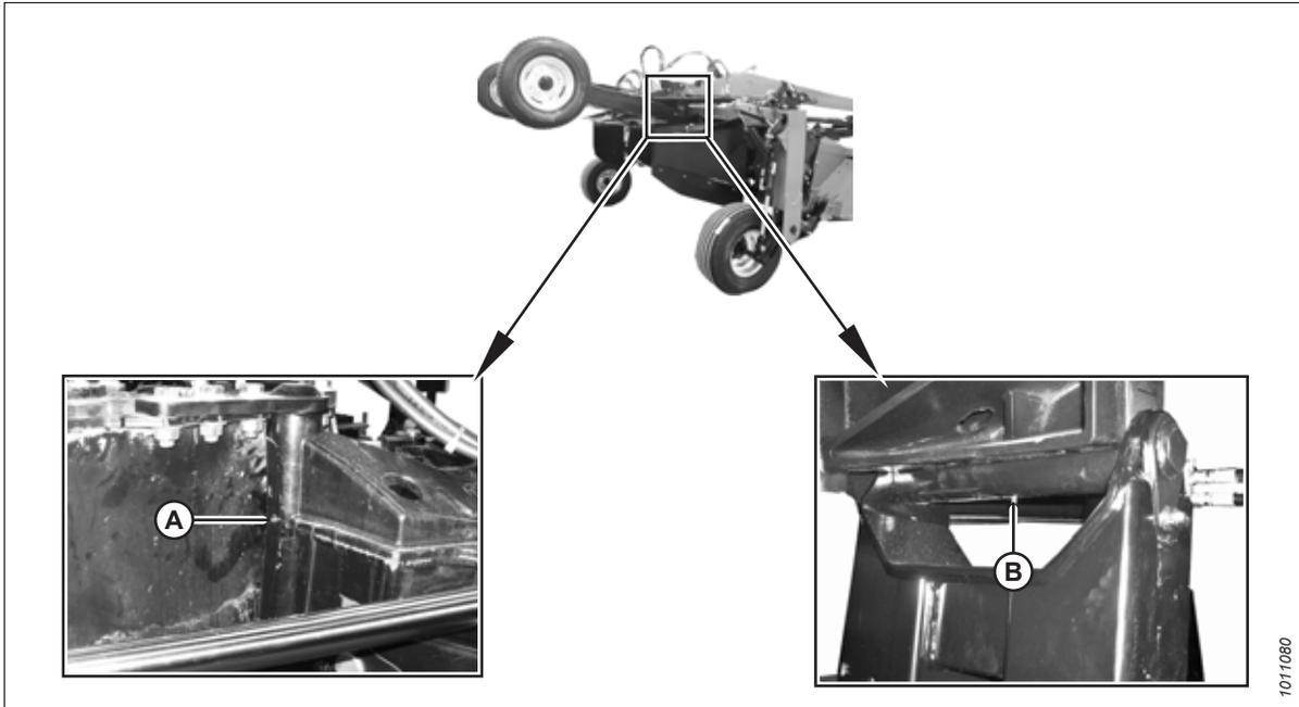
Figure 4.11: Emplacement de graissage (toutes les 25 heures)
