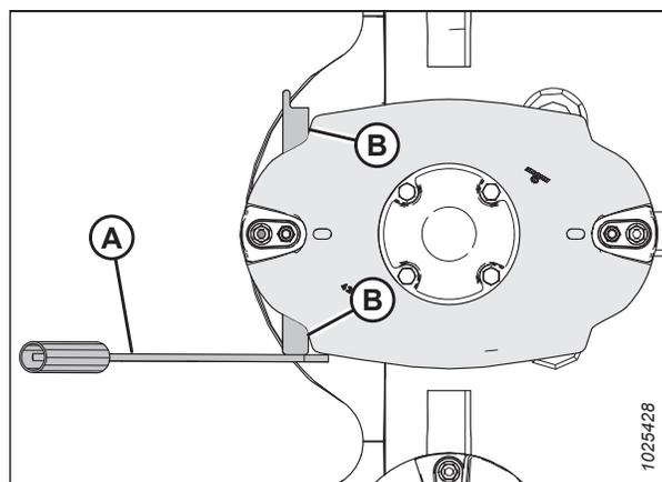
Figure 4.103: Positionnement correct de l'outil de changement rapide de la lame
