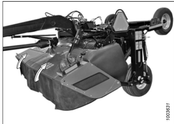
Figure 4.31: Portes de barre de coupe – Type tracté à disques rotatifs série R1
