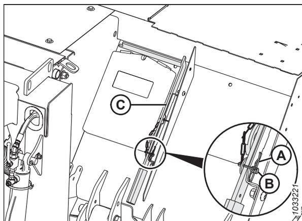
Figure 4.100: Emplacement de stockage l'outil de changement de lame
