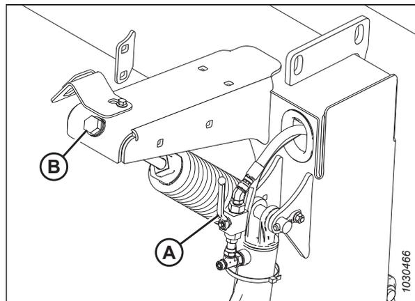
Figure 4.334: Réglage du flottement de droite
