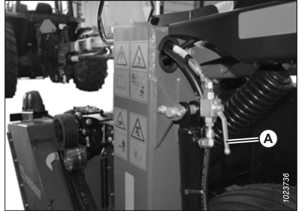
Figure 4.379: Clapets de verrouillage du vérin de levage – position ouverte
