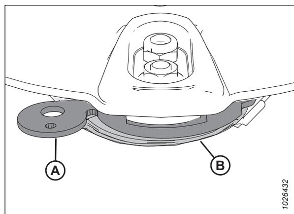
Figure 4.99: Jauge et plaque de changement non alignées
