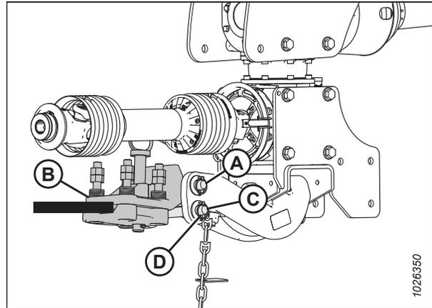
Figure 3.44: Attelage du type tracté à disques rotatifs
