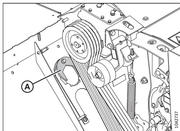
Figure 4.189: Emplacement de la clé de l'écrou de pivot Safecut
