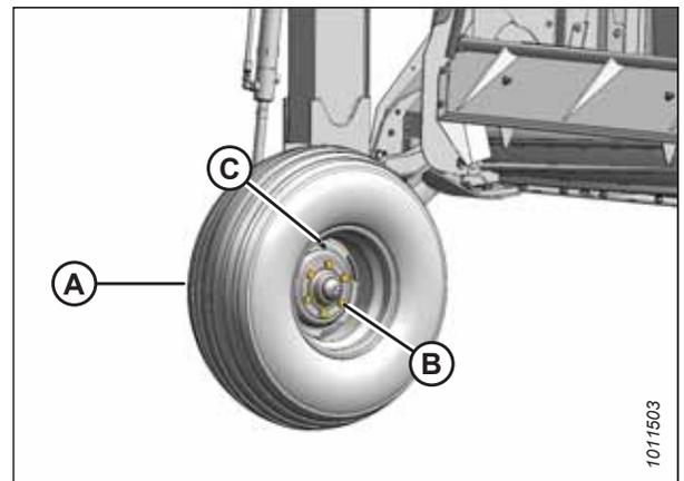
Figure 4.311: Installation des boulons de roue
