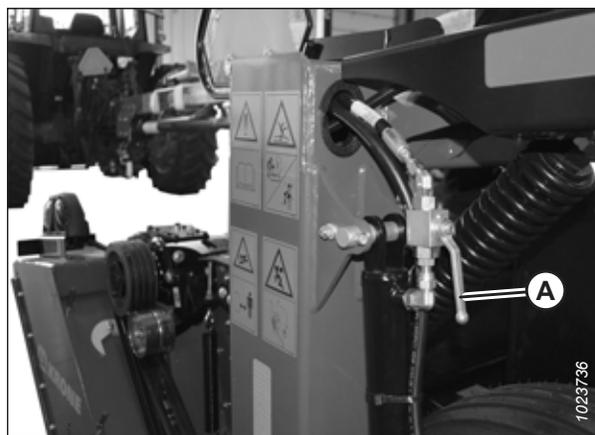
Figure 3.73: Clapet de verrouillage de la direction en position ouverte
