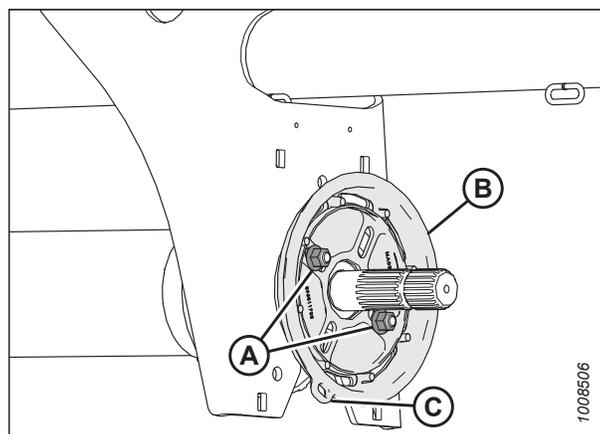
Figure 4.239: Plaque métallique fixée au support central
