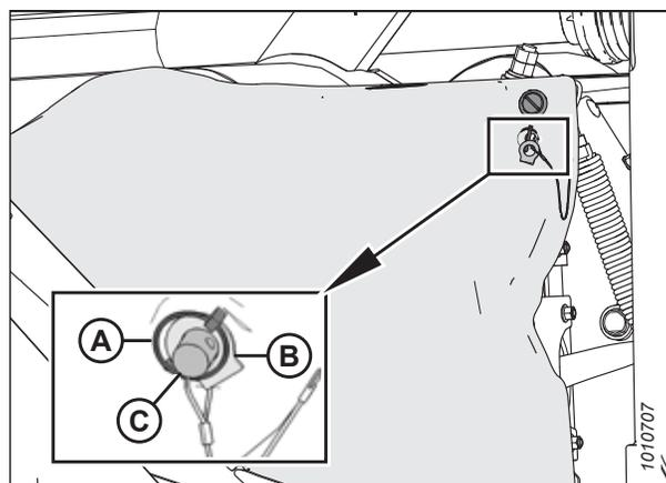
Figure 4.207: Outil pour déverrouiller la protection de la transmission
