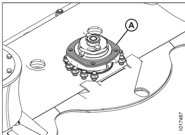
Figure 4.51: Pivot du disque
