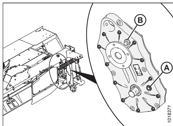
Figure 4.287: Boîte de vitesses de synchronisation des rouleaux
