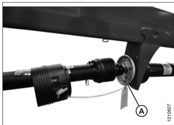
Figure 4.212: Soufflet de protection de la transmission retiré de la plaque métallique
