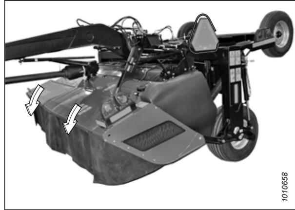
Figure 4.303: Portes de la barre de coupe en position fermée
