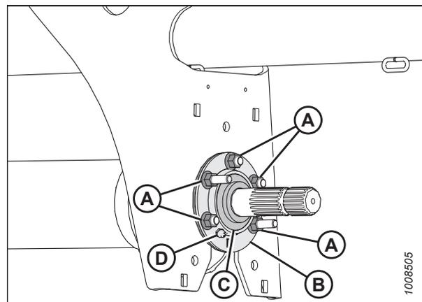
Figure 4.237: Bride, roulement et graisseur
