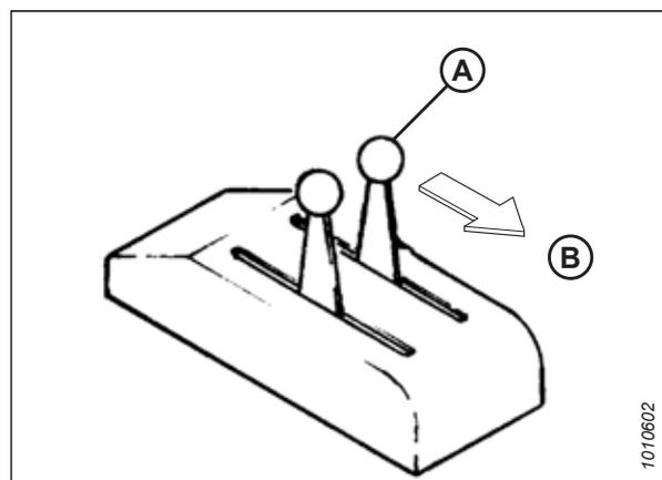
Figure 3.1: Levier de commande du vérin du tracteur
