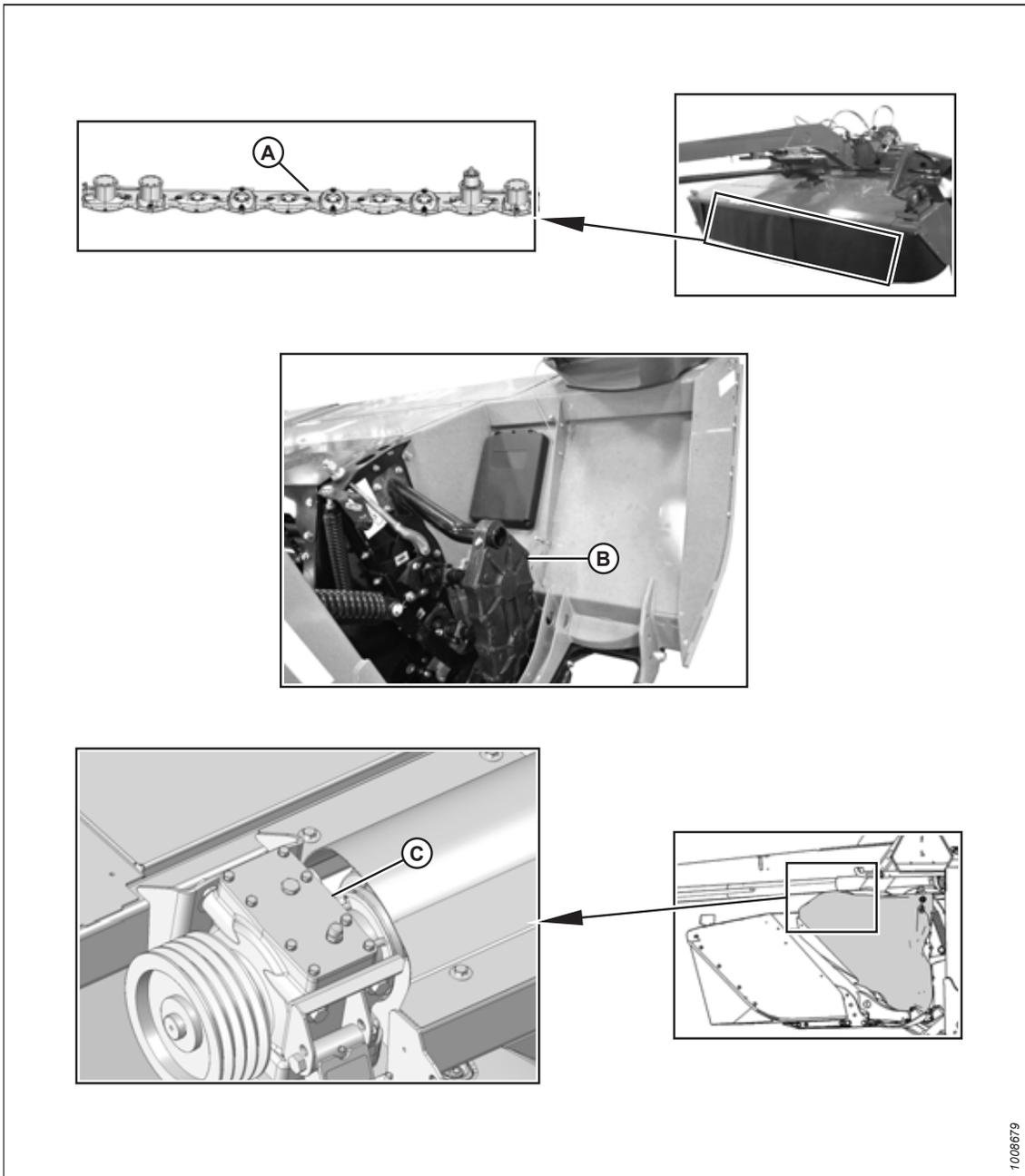
Figure 4.16: Emplacement de lubrification (toutes les 250 heures)
