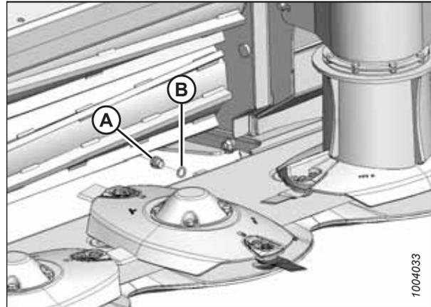
Figure 4.40: Bouchon d'inspection d'huile de barre de coupe
