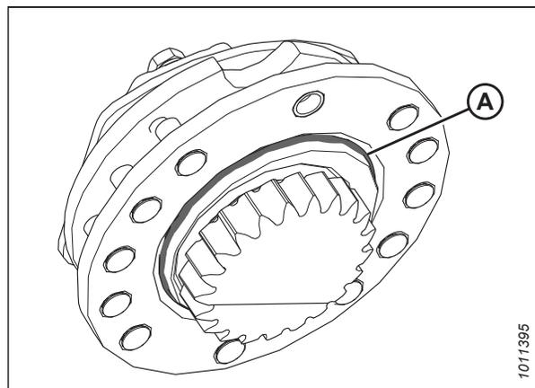
Figure 4.67: Joint torique du pivot gauche
