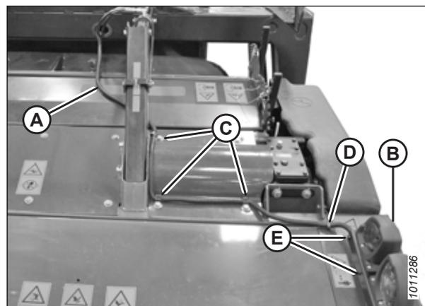
Figure 4.341: Faisceau électrique
