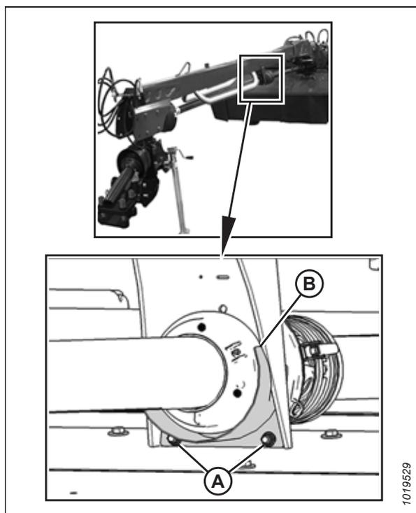
Figure 4.226: Capot et protection de la transmission installés sur le support central
