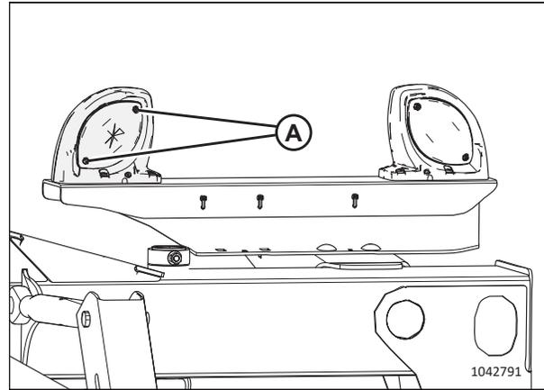
Figure 4.319: Optique en plastique et vis
