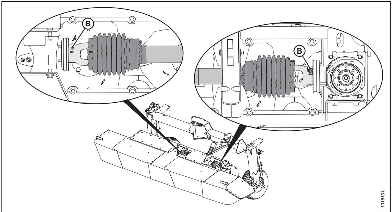
Figure 4.267: Emplacements des goupilles coniques de l'arbre de la transmission transversale
