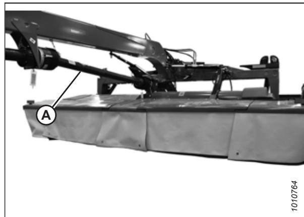
Figure 4.241: Transmission de l'embrayage installée sur le support central
