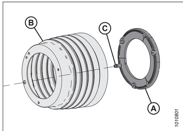
Figure 4.273: Support de protection et cône externe
