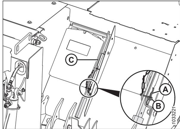
Figure 4.95: Installation des lames à changement rapide
