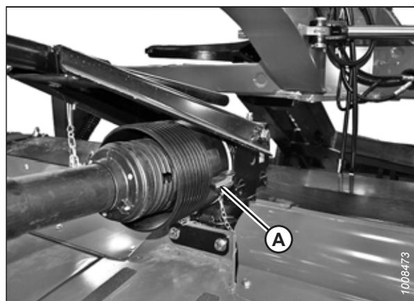
Figure 4.246: Cône de protection de la transmission
