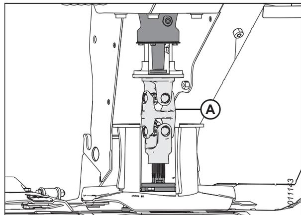
Figure 4.166: Connexion entre l'entraînement de moyeu et la transmission
