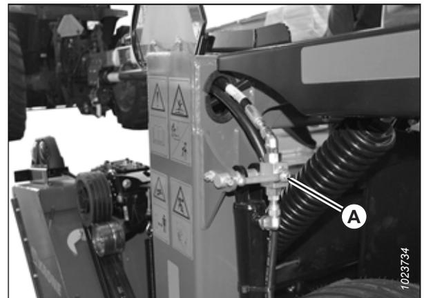
Figure 4.370: Clapets de verrouillage des vérins de levage
