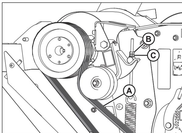
Figure 3.137: Contre-écrou et écrou de réglage du côté gauche du type tracté à disques rotatifs
