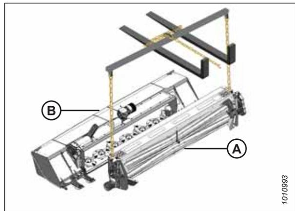
Figure 4.349: Levage de la conditionneuse
