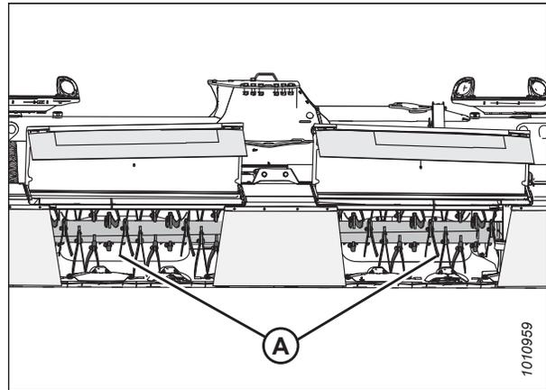
Figure 4.327: Doigts du rotor
