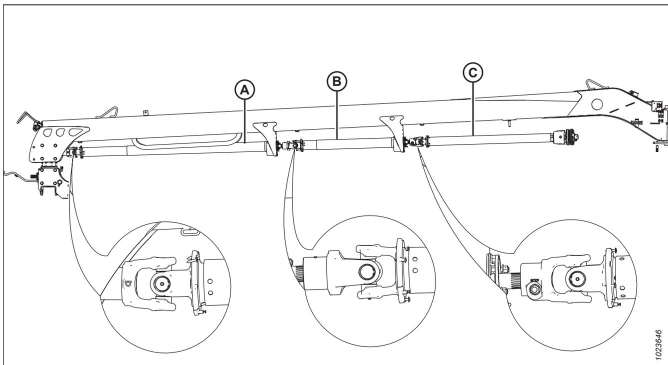
Figure 4.216: Mise en phase de la transmission du type tracté
