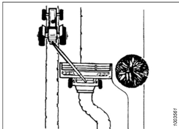
Figure 3.61: Contournement d'un obstacle par le type tracté à disques rotatifs
