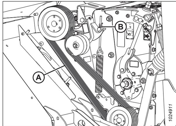
Figure 4.344: Entraînement de la conditionneuse
