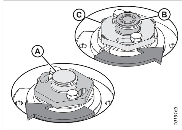
Figure 4.190: Pivots de la barre de coupe
