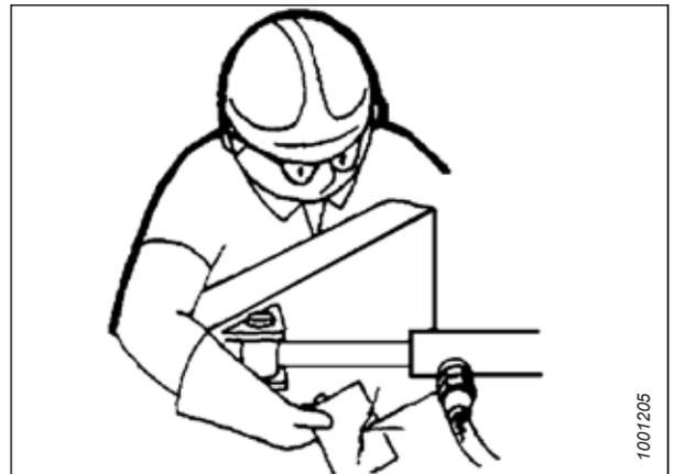
Figure 4.316: Test de fuites hydrauliques
