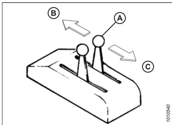
Figure 3.54: Levier de commande du vérin du tracteur
