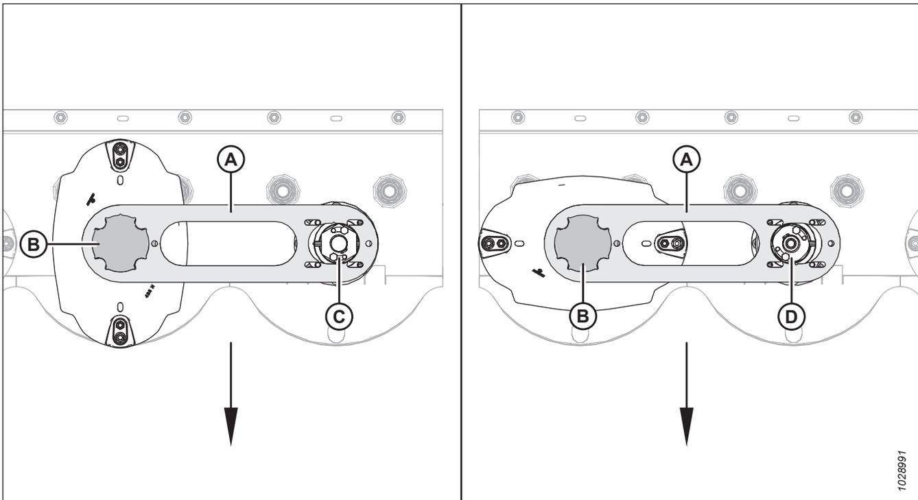
Figure 4.65: Vérification de la synchronisation à l'aide de l'outil de synchronisation des disques – Vue du dessus
