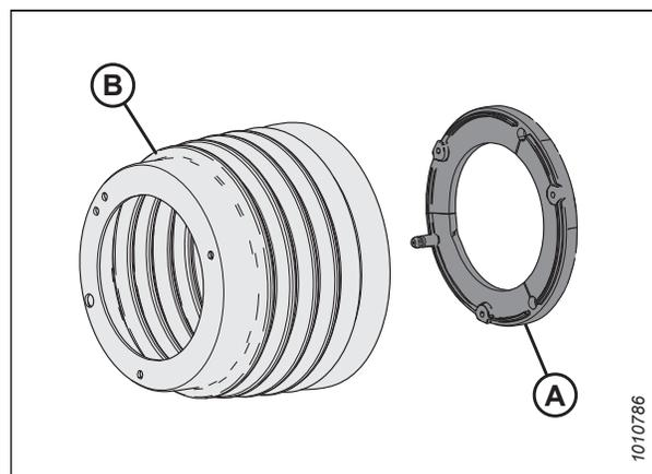
Figure 4.271: Support de protection retiré du cône externe
