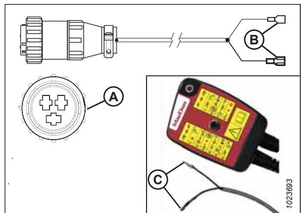
Figure 3.36: Connecteur auxiliaire à trois broches
