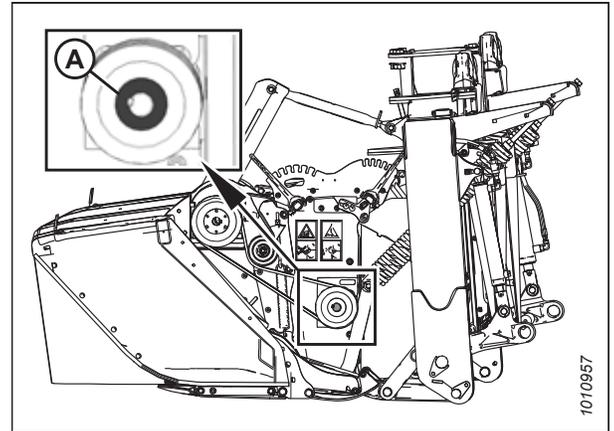
Figure 4.329: Roulement du rotor du côté gauche
