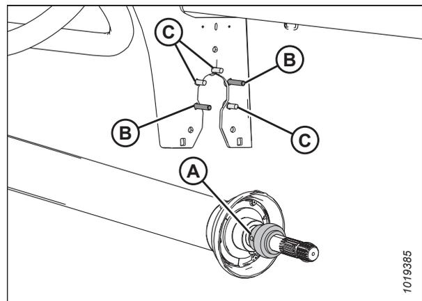
Figure 4.231: Bague d'arrêt du roulement
