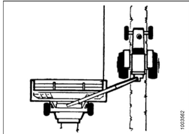
Figure 3.59: Manœuvre sur le côté gauche du tracteur
