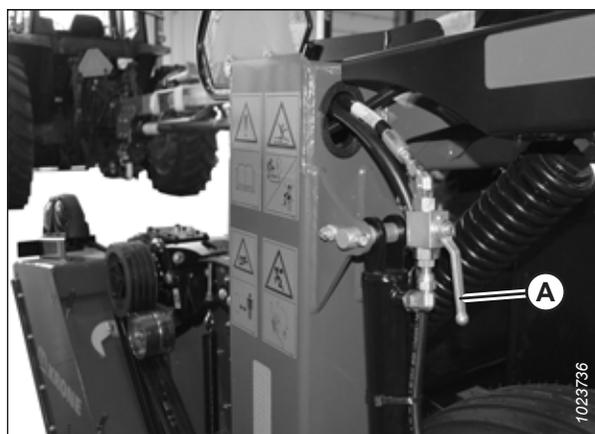
Figure 3.90: Clapet de verrouillage du vérin de levage
