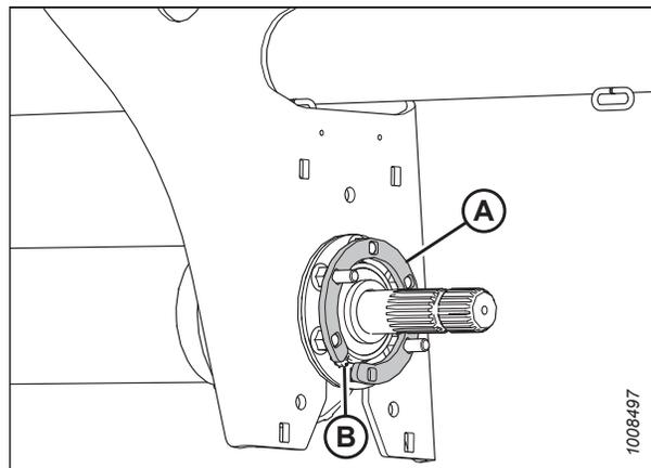
Figure 4.238: Entretoise installée sur le support central
