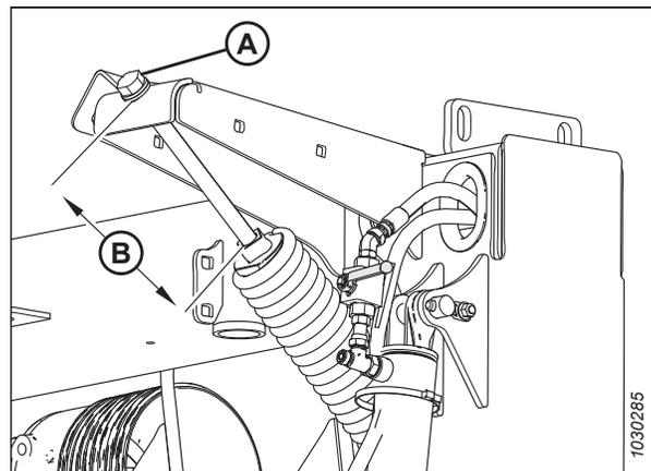
Figure 3.102: Boulon de réglage
