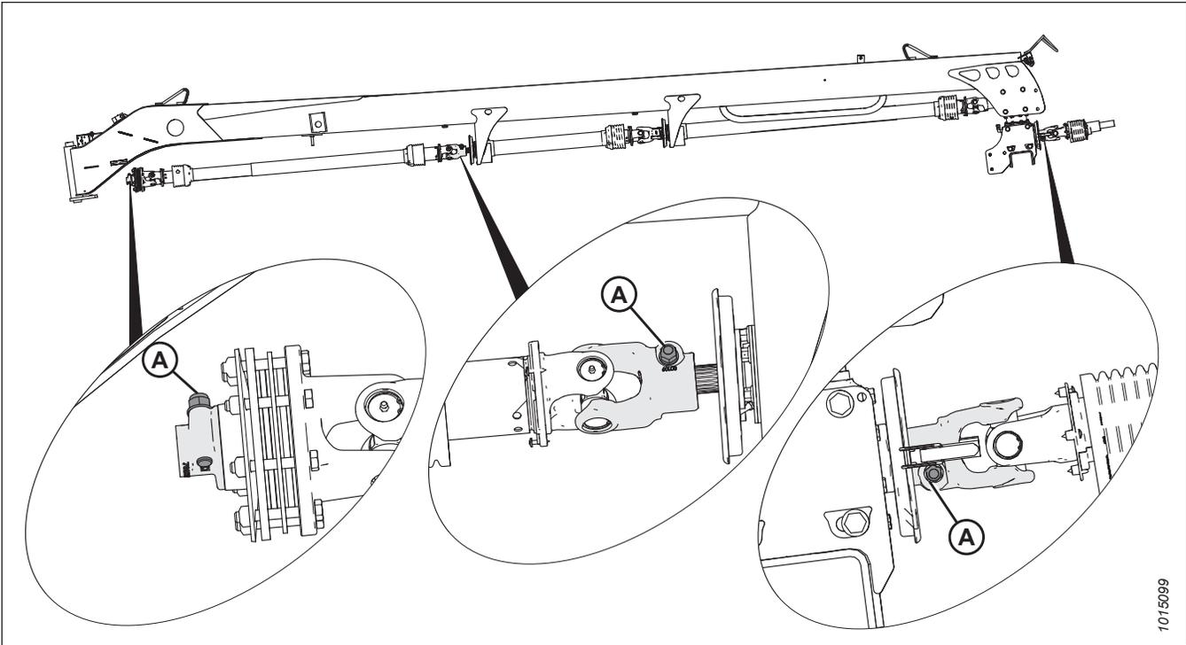
Figure 4.266: Emplacements des goupilles coniques de l'attelage
