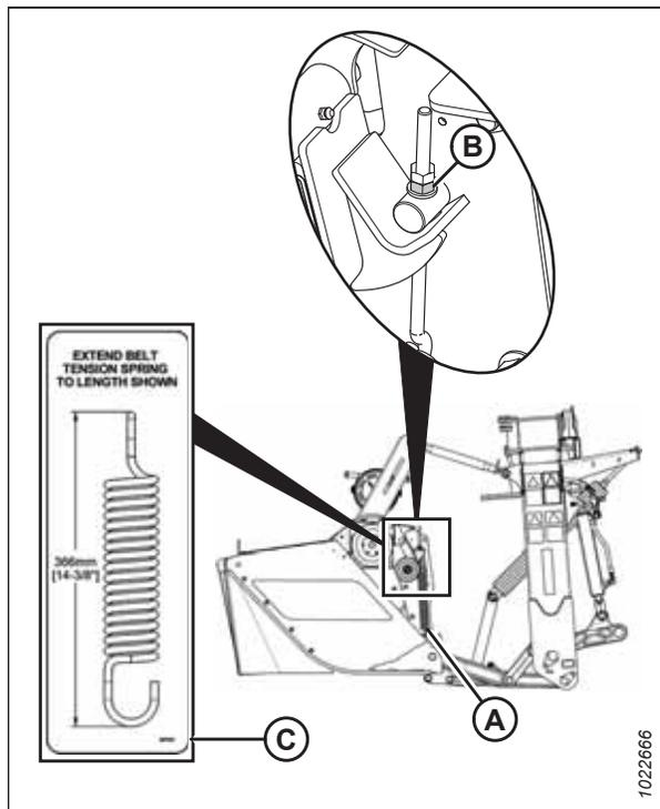
Figure 3.138: Autocollant de tension du ressort
