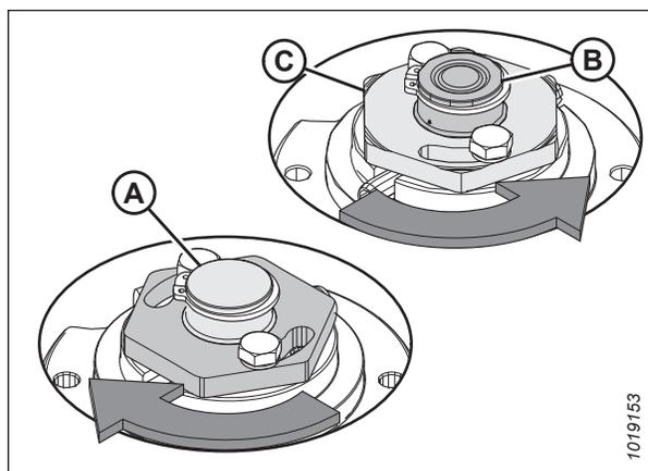
Figure 4.77: Pivots de la barre de coupe
