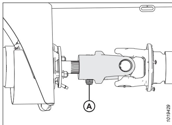
Figure 4.252: Transmission de l'embrayage du R113 PT
