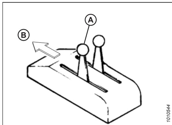
Figure 3.58: Levier de commande de direction du tracteur
