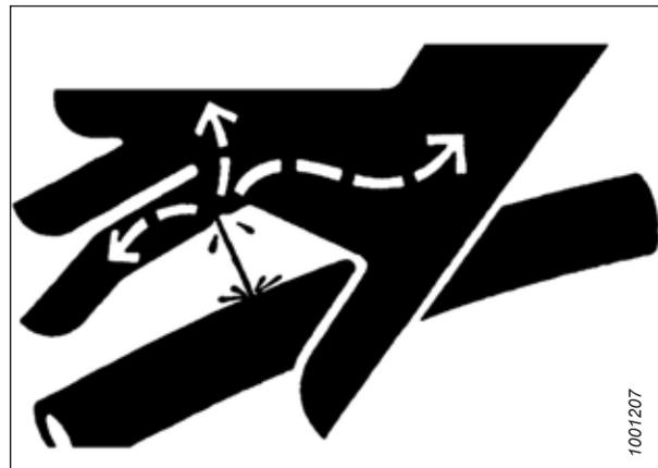
Figure 1.13: Risque lié à la pression hydraulique
