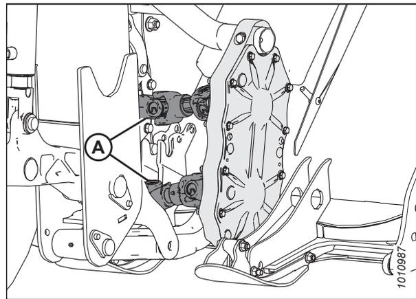
Figure 4.323: Joints universels d'entraînements du conditionneur
