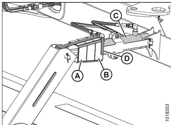
Figure 3.109: Vérin d'inclinaison hydraulique
