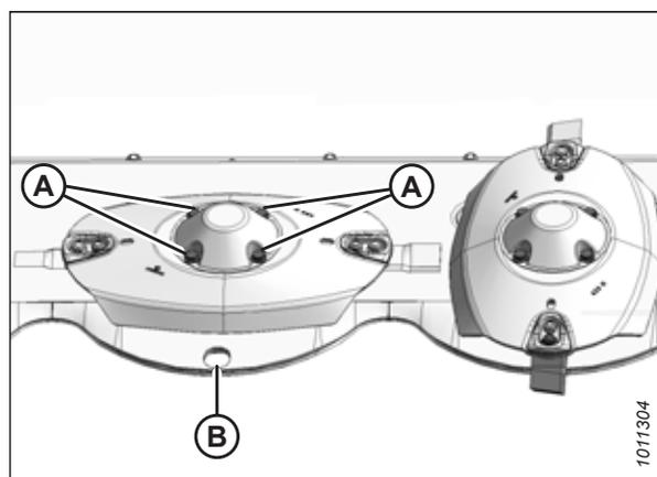
Figure 4.49: Boulons du disque de la barre de coupe
