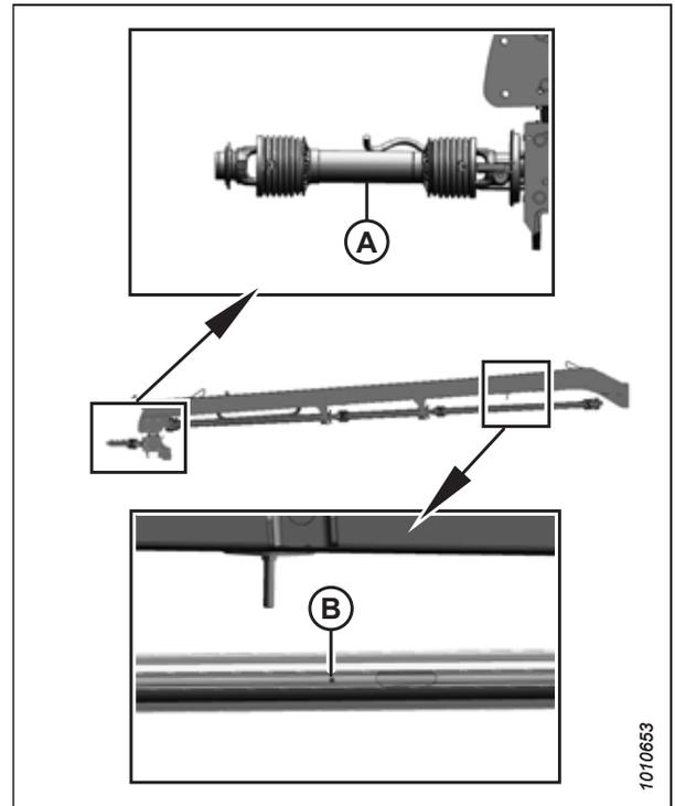
**Figure 4.10: Emplacement de la graisse (toutes les 25 heures)**
