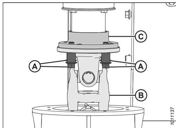
Figure 4.171: Connexion entre l'entraînement de moyeu et la transmission
