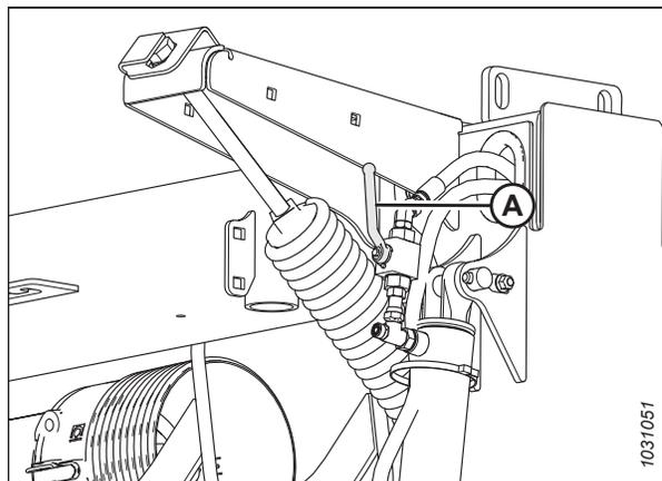
Figure 3.104: Clapet de verrouillage du vérin – Position ouverte
