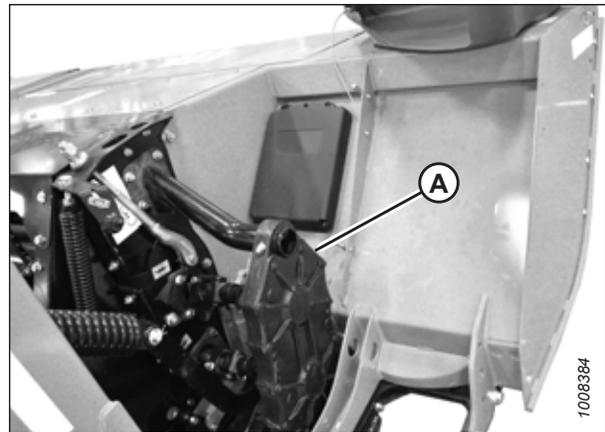
Figure 4.285: Boîte de vitesses de synchronisation des rouleaux du conditionneur
