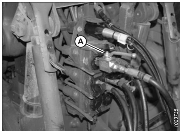
Figure 3.89: Vanne de verrouillage de la direction
