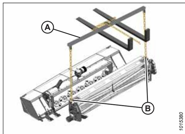
Figure 4.352: Levage de la conditionneuse
