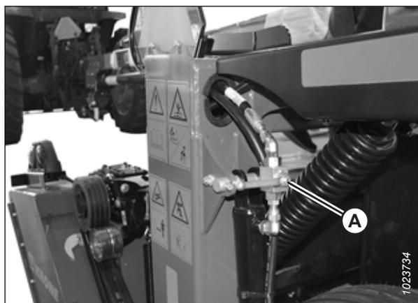
Figure 3.75: Clapet de verrouillage du vérin de levage en position fermée
