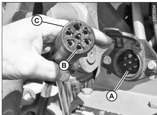
Figure 3.33: Faisceau de câblage électrique et prise femelle
