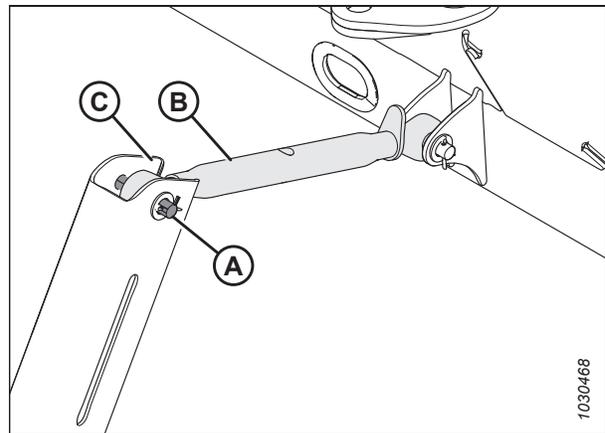
Figure 4.338: Vérin d'inclinaison mécanique
