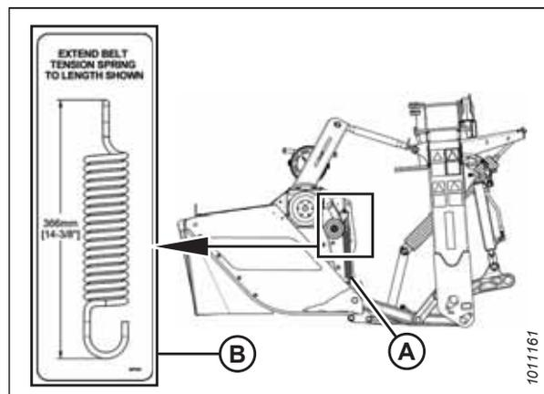
Figure 4.280: Autocollant de tension du ressort
