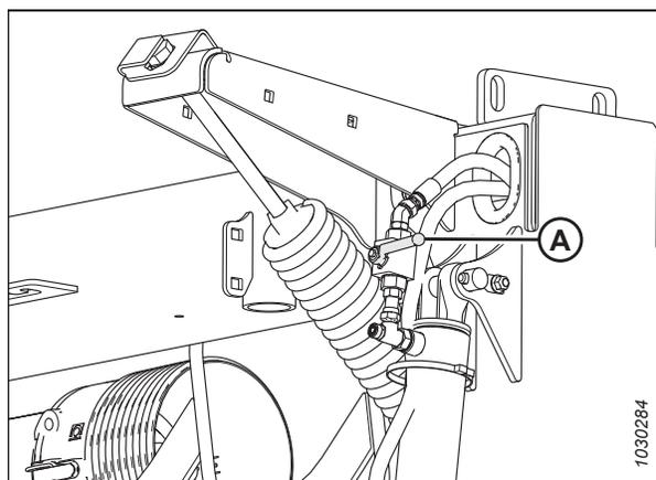
Figure 3.100: Clapet de verrouillage du vérin – Position fermée
