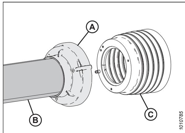
Figure 4.270: Cône de base et tube de protection séparés du cône externe
