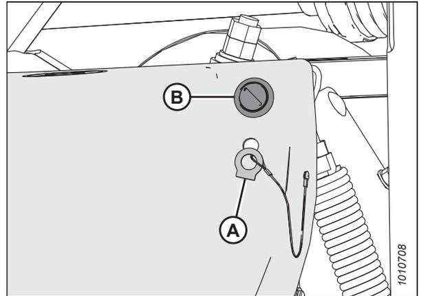
Figure 3.7: Loquet du blindage de la transmission
