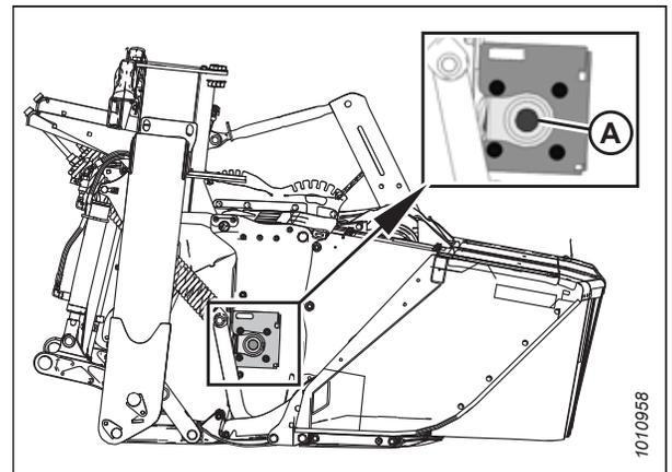
Figure 4.330: Roulement du rotor droit
