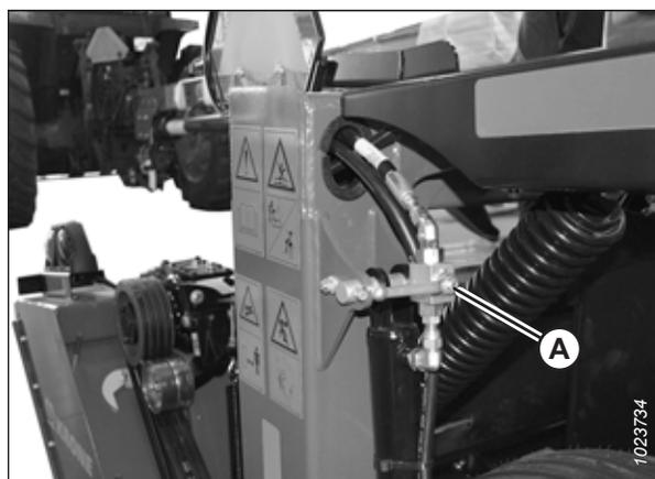
Figure 3.70: Clapet de verrouillage du vérin en position fermée
