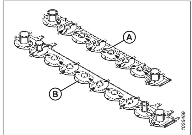
Figure 3.144: Barres de coupe de la R113 et R116
