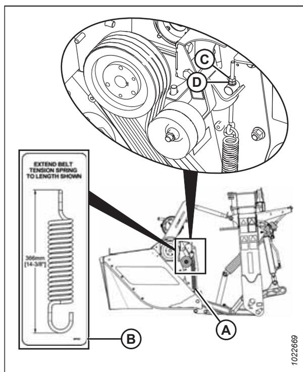
Figure 4.283: Autocollant de tension du ressort
