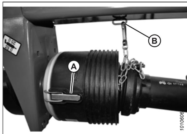
Figure 4.211: Soufflet de protection de la transmission et verrou à levier
