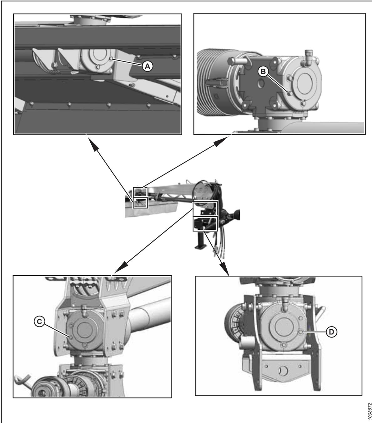
**Figure 4.14: Emplacement de lubrification (toutes les 100 heures)**
