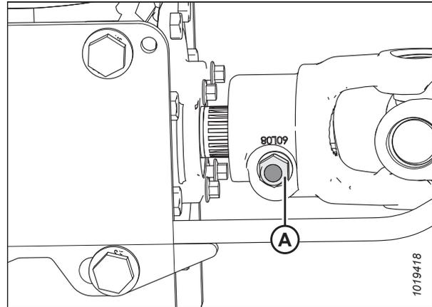
Figure 4.221: Goupille conique installée dans la fourche d'articulation
