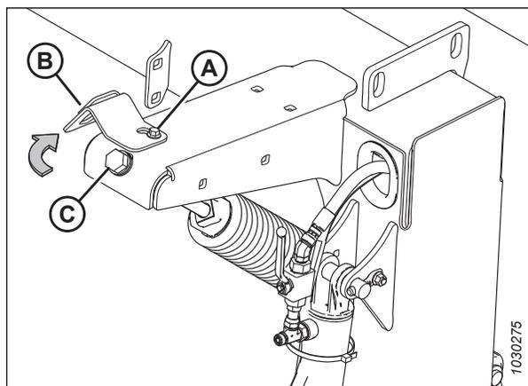
Figure 3.101: Ressort de flottement – Côté droit
