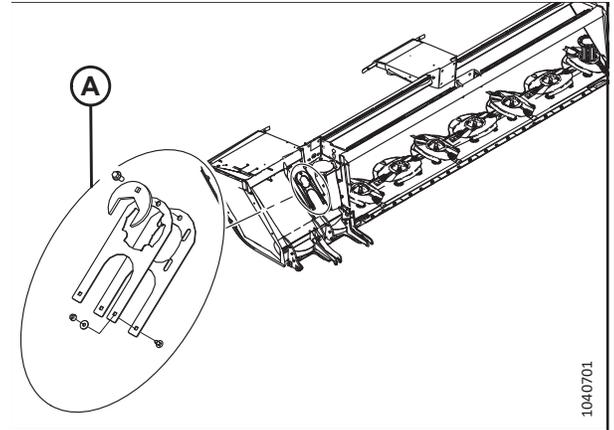
Figure 4.63: Emplacement de l'outil de synchronisation des disques de série R1 – Côté arrière gauche
