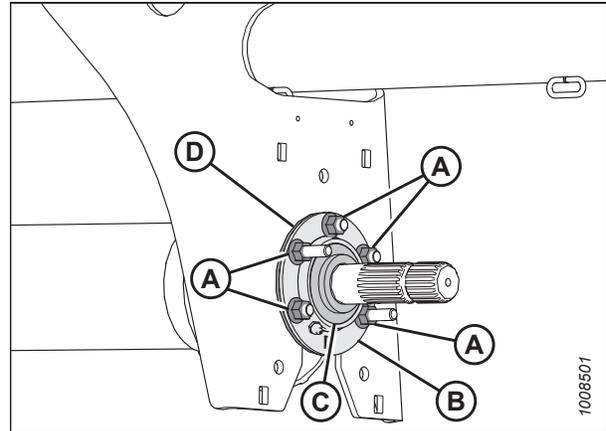
Figure 4.230: Roulement à billes et brides
