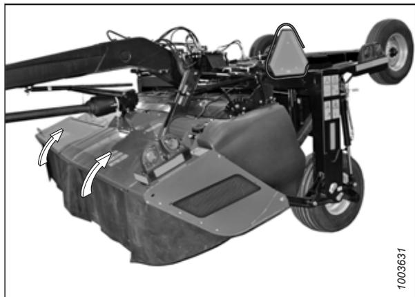
Figure 4.25: Portes de barre de coupe – Type tracté à disques rotatifs série R1
