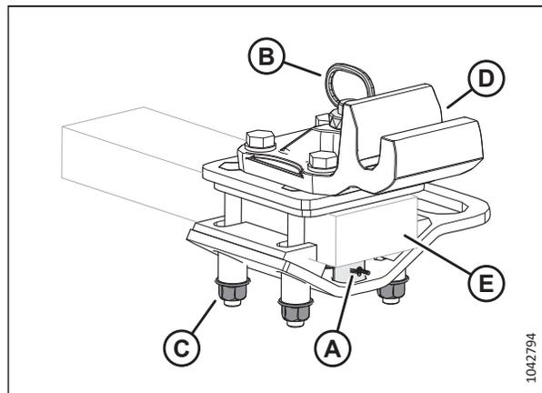
Figure 3.19: Adaptateur du crochet d'attelage de catégorie 4
