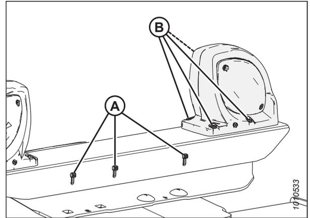
Figure 4.318: Feu de détresse orange et support de montage
