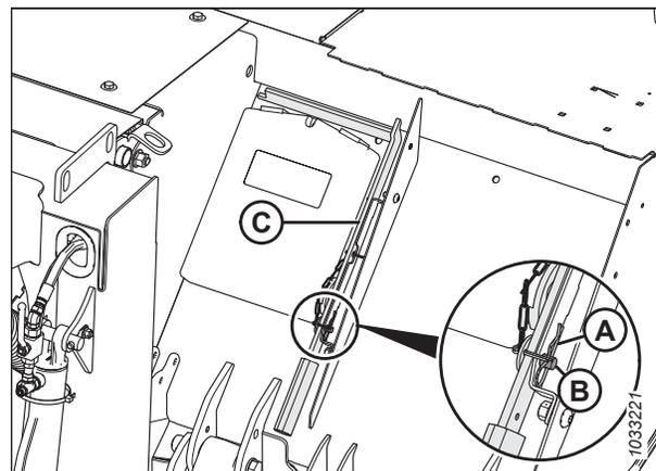
Figure 4.92: Installation des lames à changement rapide
