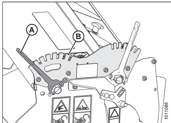
Figure 3.133: Levier de réglage du déflecteur d'intensité interne
