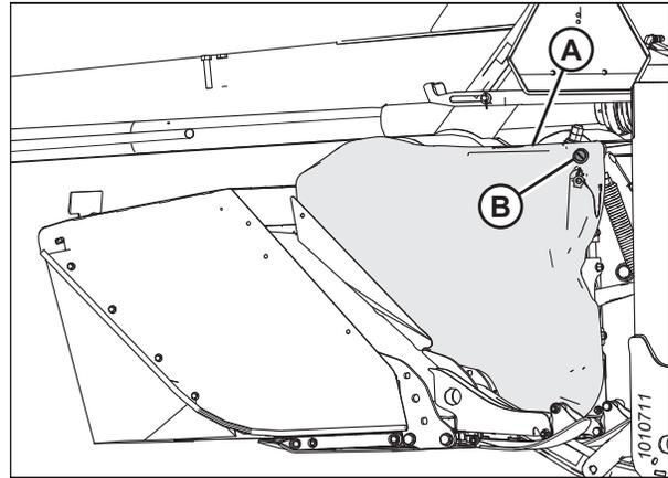
Figure 3.9: Blindage de la transmission et loquet
