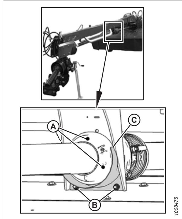
Figure 4.240: Capot et protection de la transmission installés sur le support central
