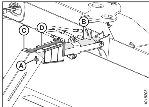
Figure 4.365: Vérin d'inclinaison hydraulique et bielles de l'indicateur
