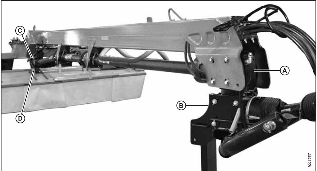
Figure 4.17: Emplacement de lubrification (toutes les 250 heures)
