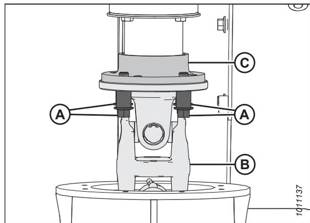
Figure 4.165: Connexion entre l'entraînement de moyeu et la transmission
