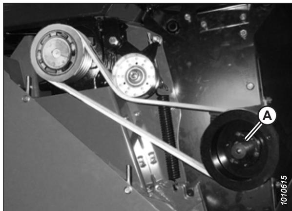
Figure 3.136: Courroie d'entraînement et poulies du côté gauche – Type tracté à disques rotatifs
