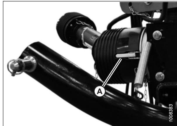
Figure 4.222: Soufflet attaché à la transmission
