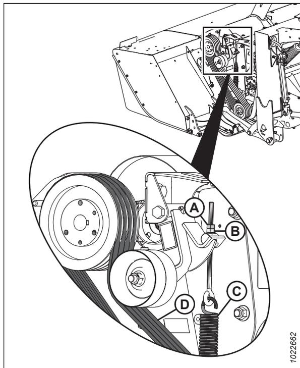
Figure 3.134: Courroie d'entraînement et poulies du côté gauche – Type tracté à disques rotatifs
