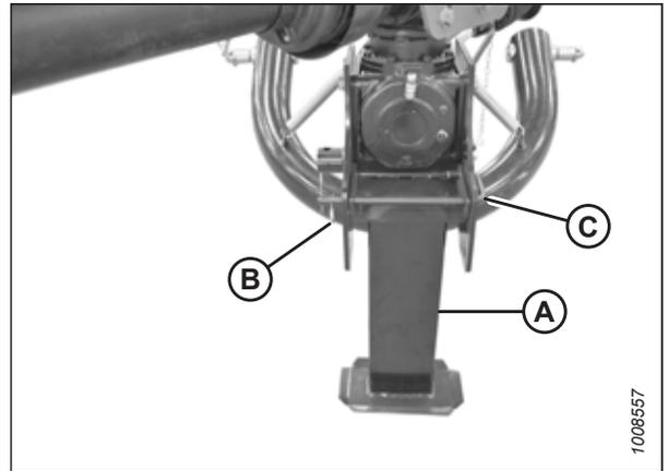
Figure 3.51: Béquille d'attelage en position abaissée
