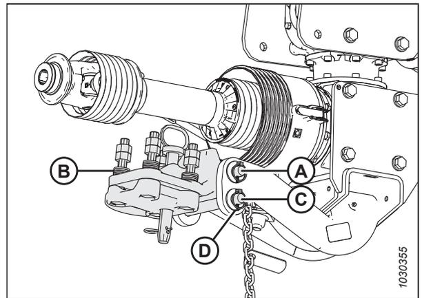
Figure 3.22: Attelage de la faucheuse à disques de type tracté
