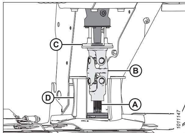
Figure 4.170: Connexion entre l'entraînement de moyeu et la transmission
