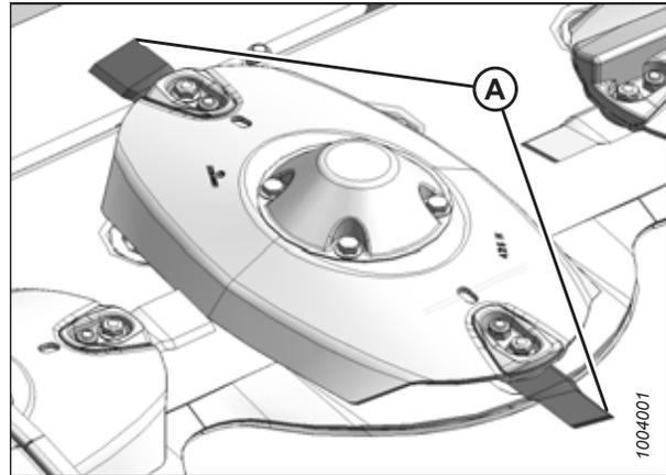
Figure 4.80: Lames de disques
