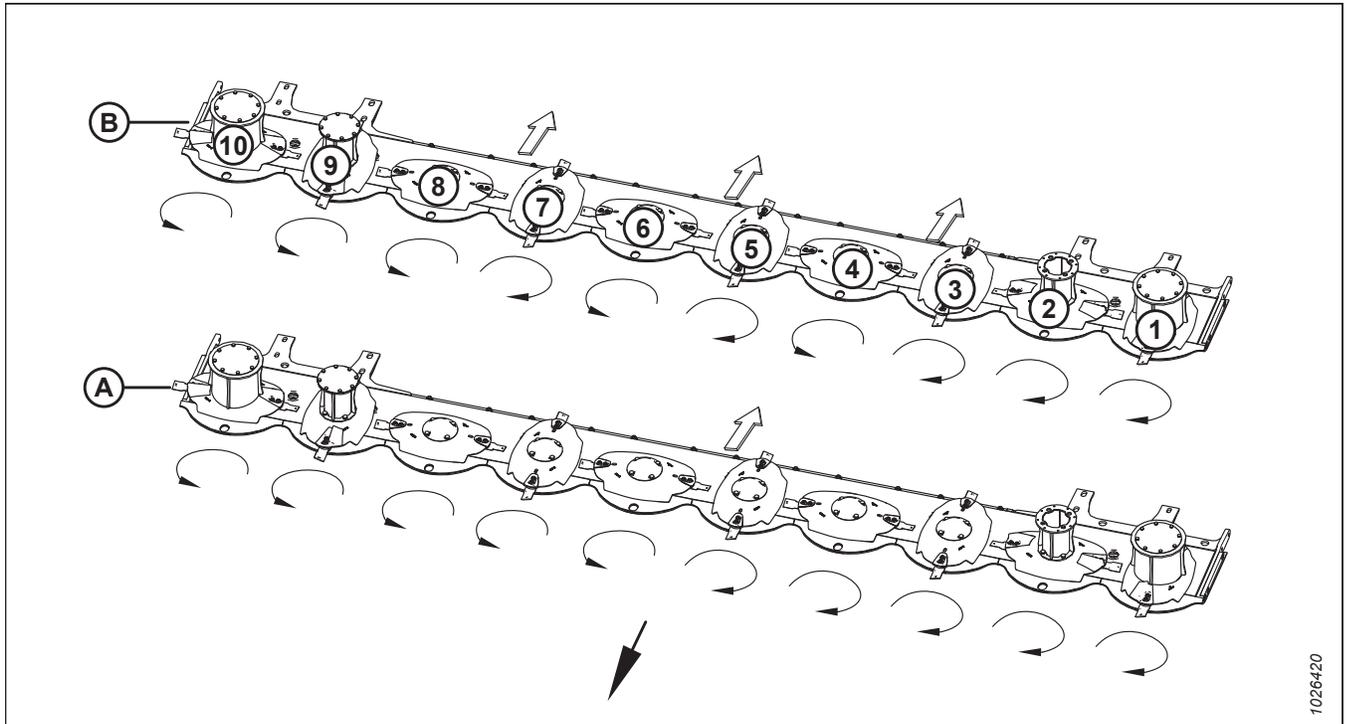
Figure 4.79: Configuration de la rotation des pivots (10 disques) R116 PT et flux de matières
