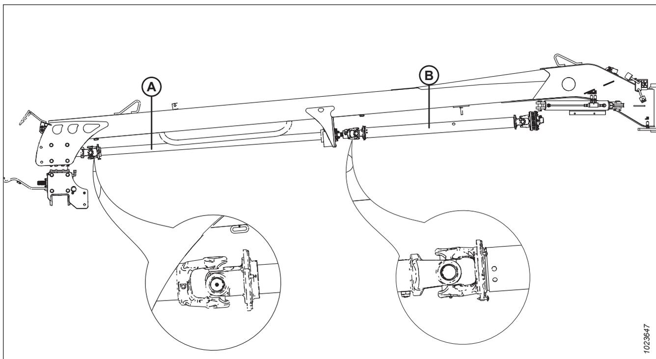
Figure 4.215: Mise en phase de la transmission du type tracté à disques rotatifs R113
