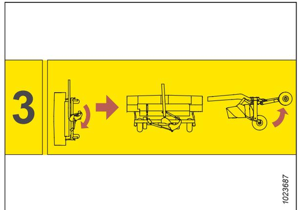
Figure 3.92: Rotation de la faucheuse à disques de type tracté
