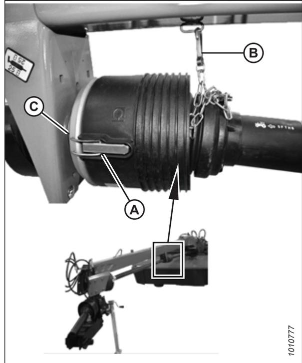
Figure 4.243: Cône de protection de la transmission
