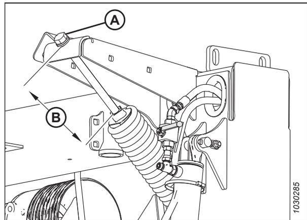
Figure 4.333: Boulon de réglage
