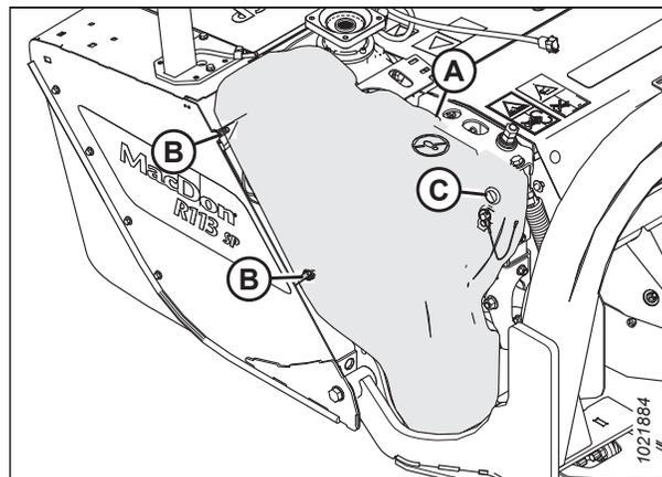
Figure 4.206: Blindage de la transmission et loquet
