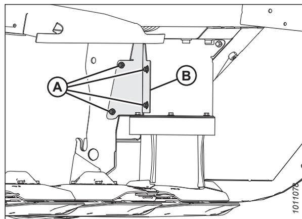
Figure 4.302: Protection verticale de l'entraînement
