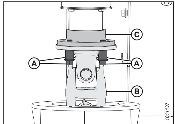
Figure 4.138: Connexion entre l'entraînement de moyeu et la transmission
