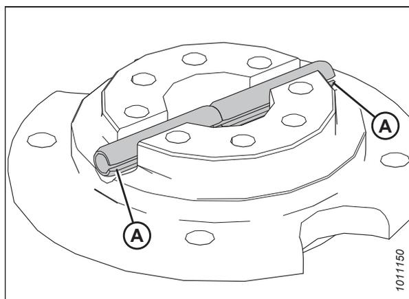
Figure 4.195: Orientation de la goupille de cisaillement
