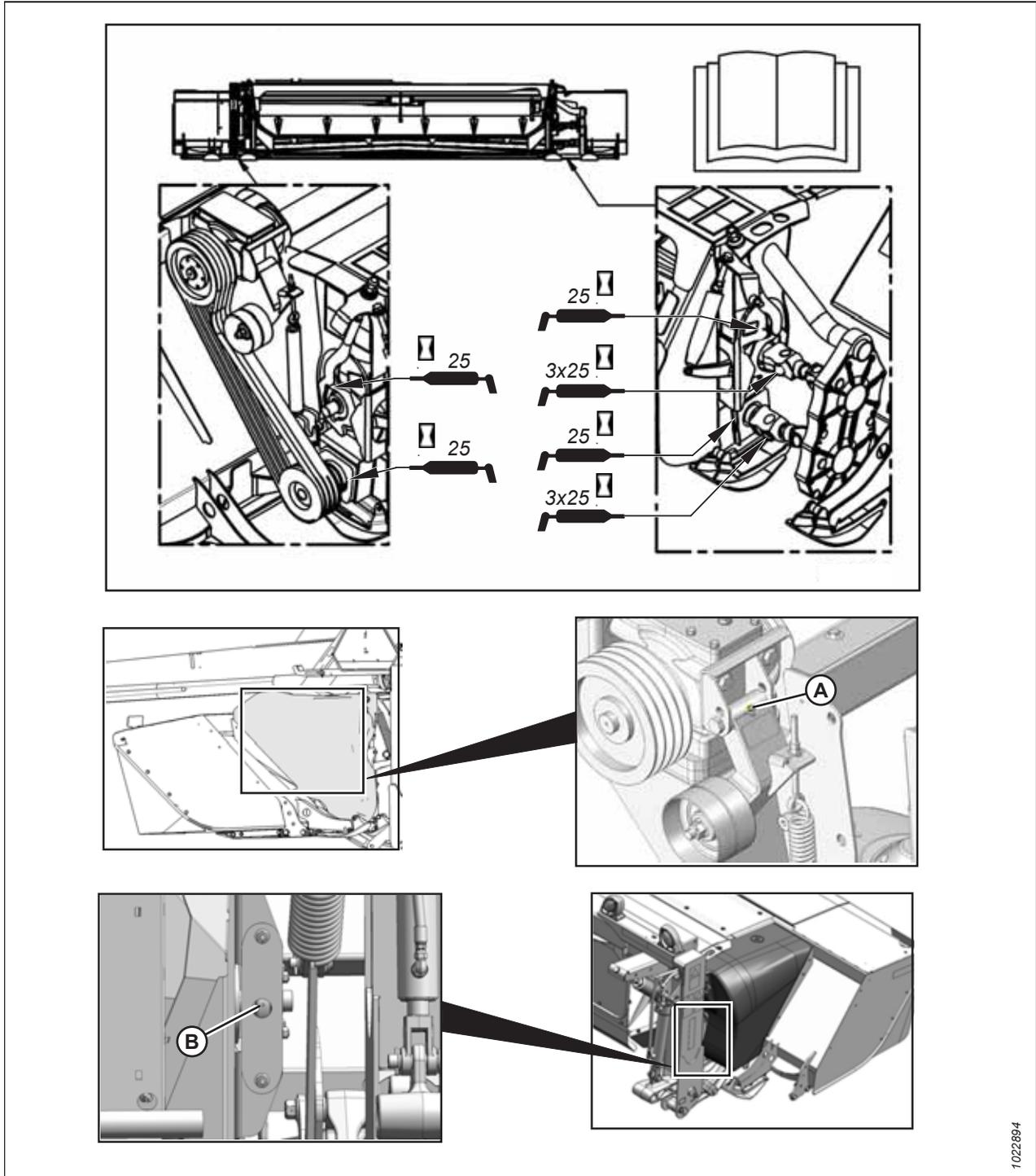
Figure 4.8: Emplacement de graissage (toutes les 25 heures)
