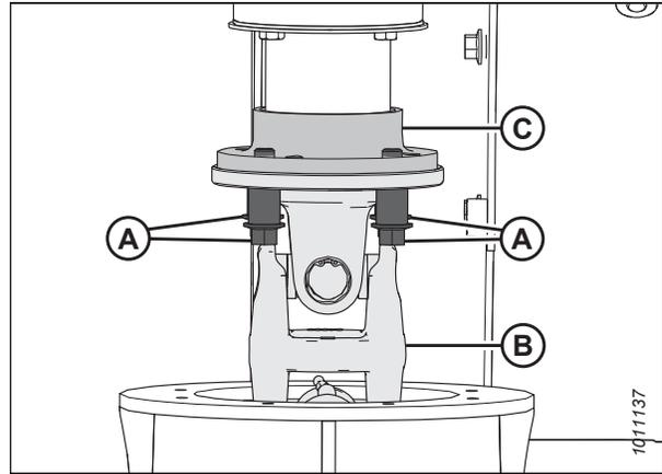
Figure 4.143: Connexion entre l'entraînement de moyeu et la transmission
