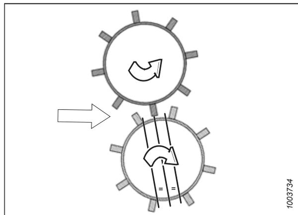
Figure 3.124: Rouleaux synchronisés correctement
