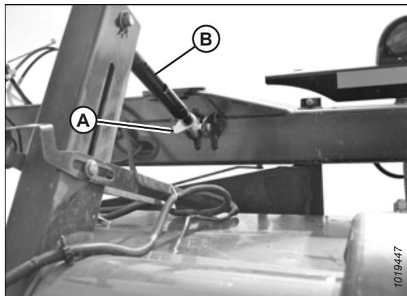
Figure 3.108: Vérin d'inclinaison mécanique
