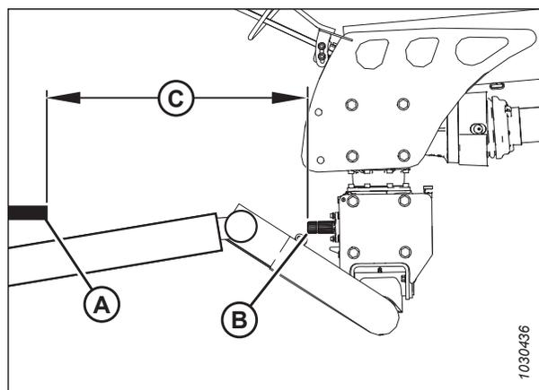
**Figure 3.27:** Longueur admissible de la transmission
