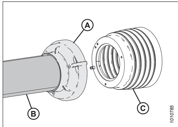
Figure 4.274: Cône de base, gaine rigide et cône externe
