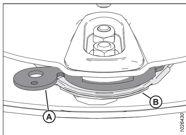
Figure 4.98: Jauge et plaque de changement alignées
