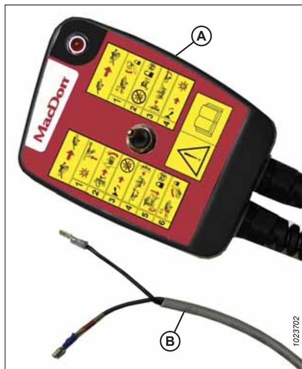
Figure 3.46: Boîtier de commande
