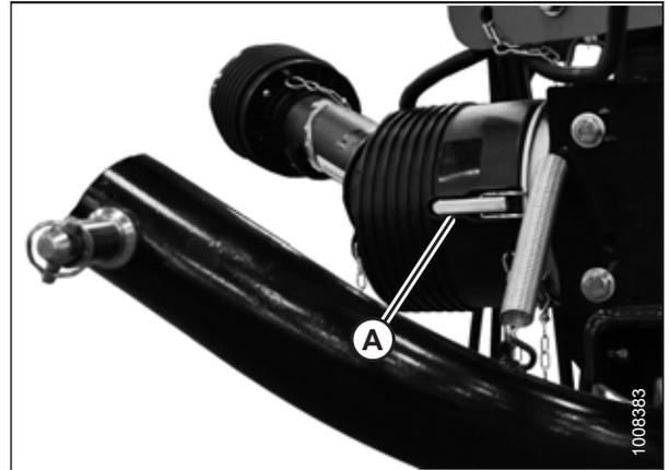
Figure 4.208: Cône de protection de la transmission et verrou de fixation à levier
