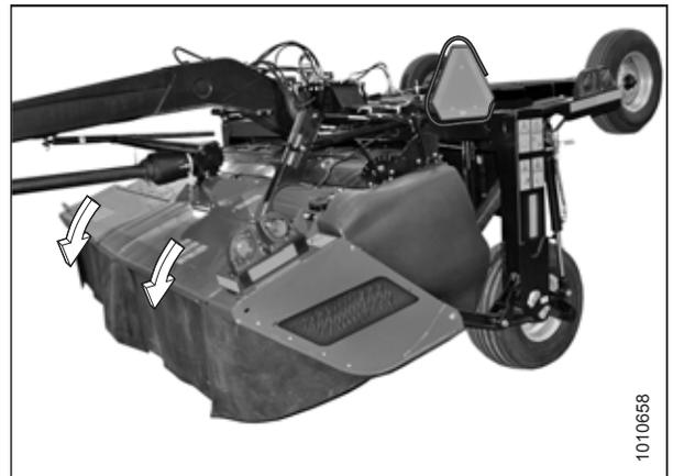
Figure 4.299: Portes de la barre de coupe en position fermée
