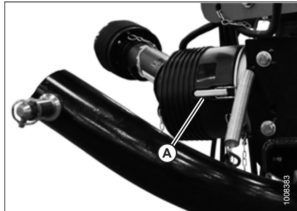
Figure 4.212: Soufflet attaché à la transmission
