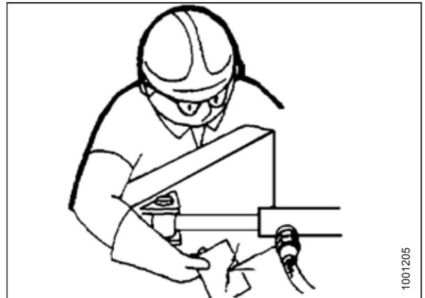
Figure 4.312: Test de fuites hydrauliques
