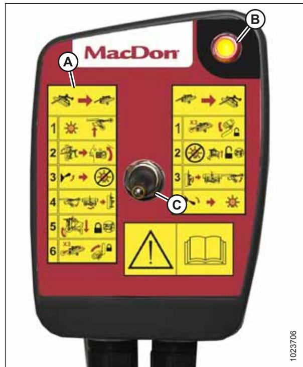
Figure 3.78: Boîtier de commande
