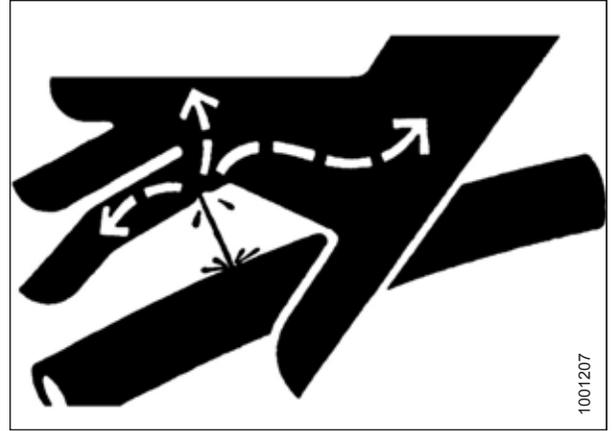
Figure 4.311: Risque lié à la pression hydraulique
