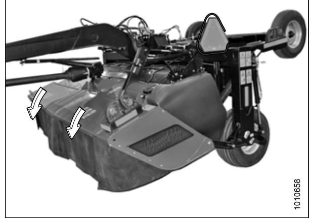
Figure 4.284: Portes de la barre de coupe en position fermée
