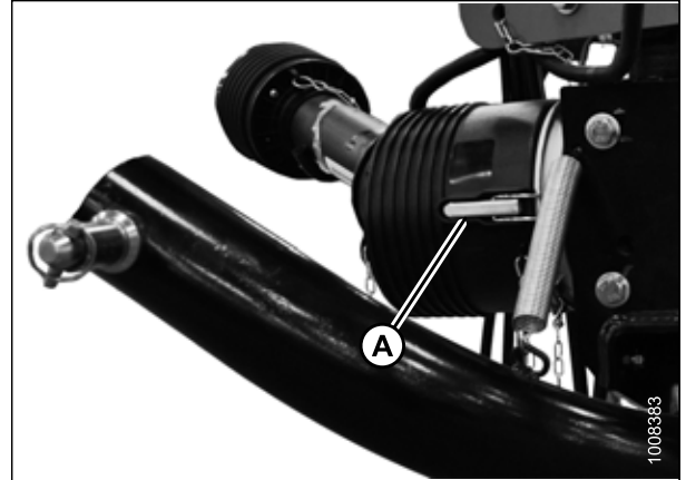
Figure 4.198: Soufflet attaché à la transmission
