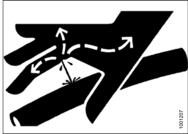
Figure 4.296: Risque lié à la pression hydraulique
