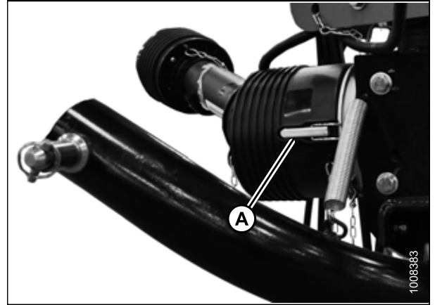
Figure 4.194: Cône de protection de la transmission et verrou de fixation à levier
