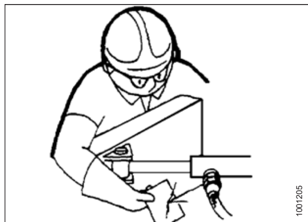
图 4.204: 液压泄漏测试
