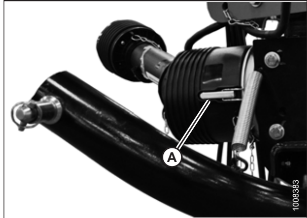
Figure 4.187: Cône de protection de la transmission et verrou de fixation à levier
