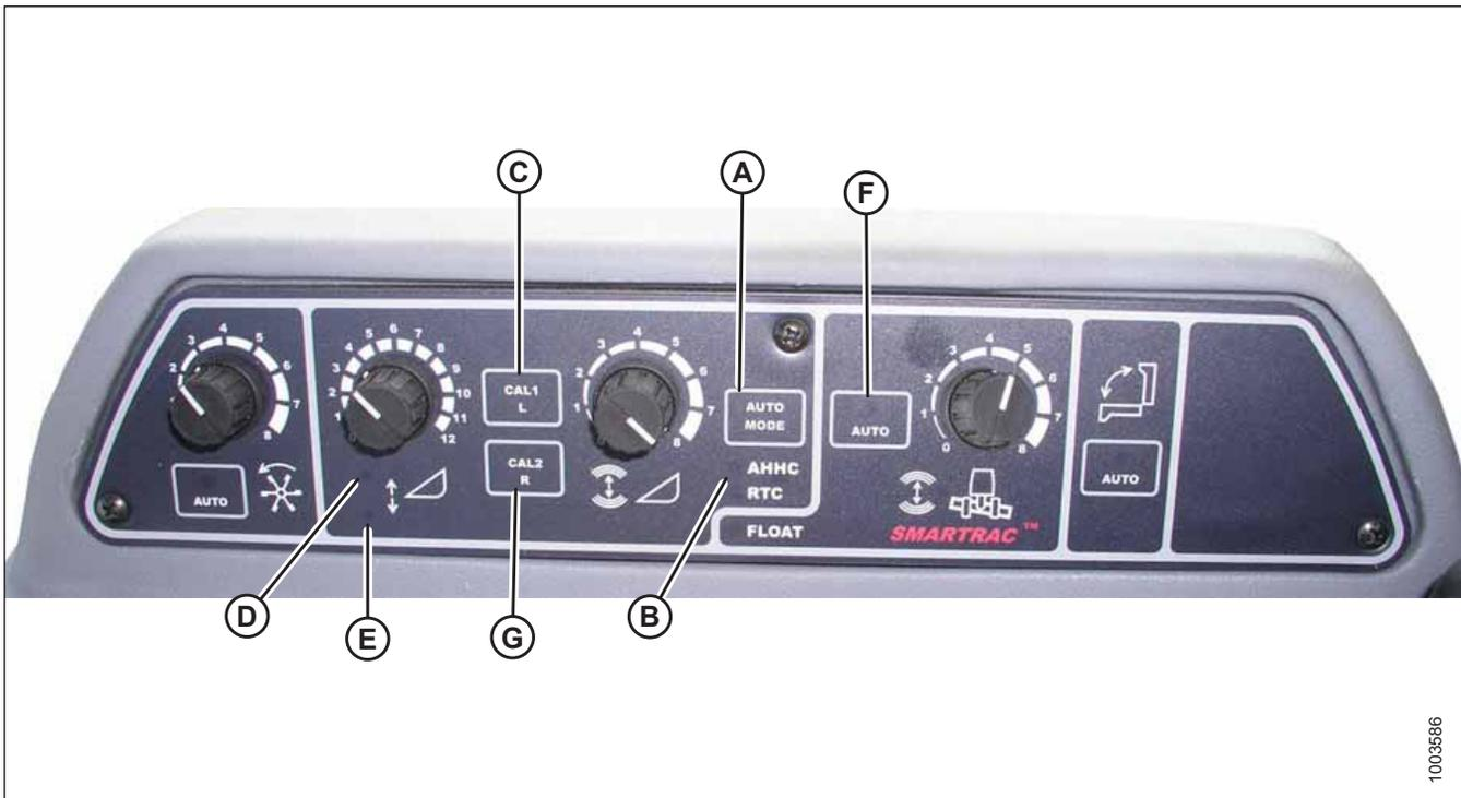
Figura 4.107: Controles automáticos de la altura de la plataforma de la cosechadora
