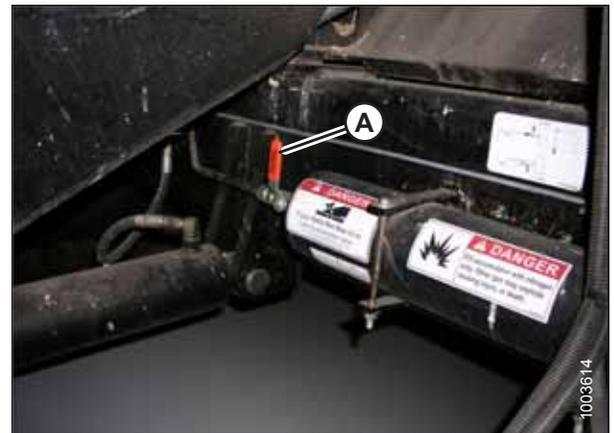
**Figura 4.108: Interruptor de ENCENDIDO/APAGADO del acumulador de la cosechadora**
