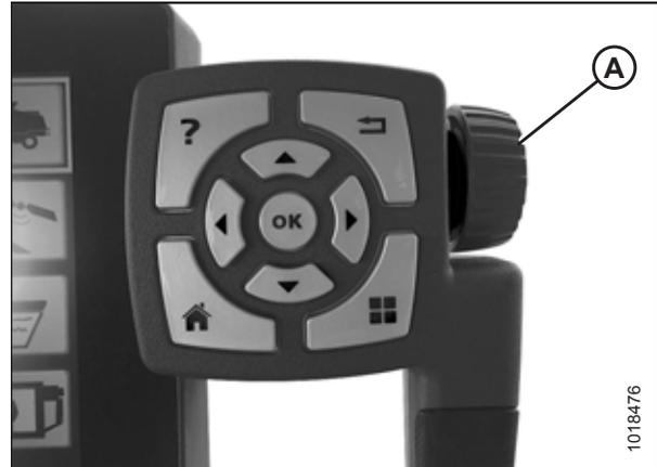
Figura 4.142: Rueda de desplazamiento para ajustes
