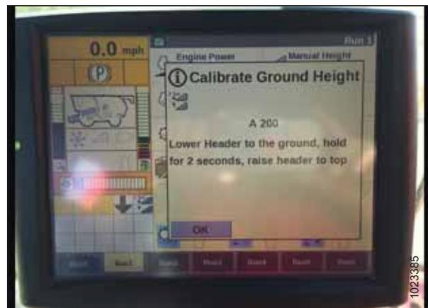
Figura 4.60: Calibración de la altura automática de la plataforma
