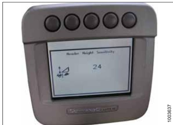
Figura 4.164: Pantalla de la cosechadora John Deere
