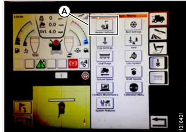
Figura 4.116: Configuración de la plataforma en el Menú principal de la cosechadora
