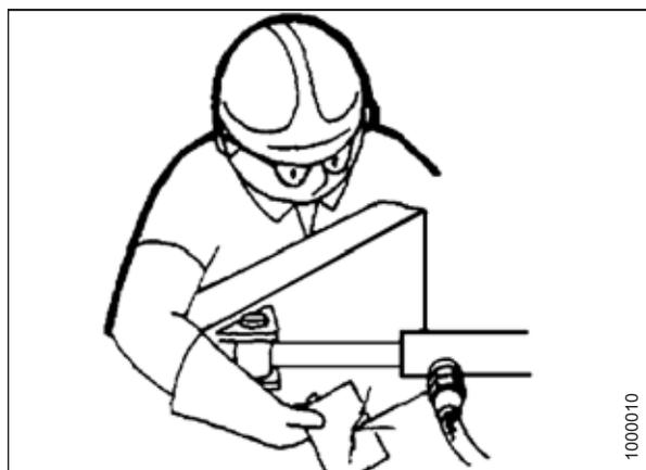
Figura 5.196: Verificación de pérdidas hidráulicas
