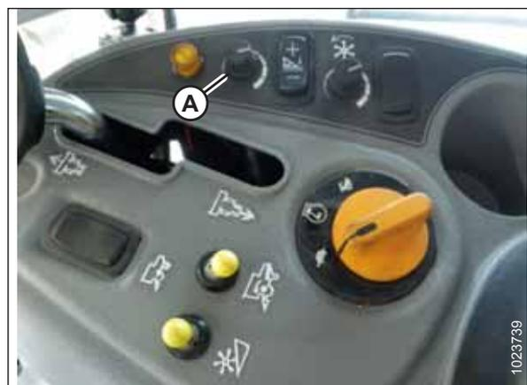
Figura 4.97: Perilla de ajuste de altura en la consola de control de la cosechadora
