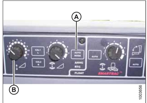
Figura 4.110: Consola de control automático de altura de la plataforma
