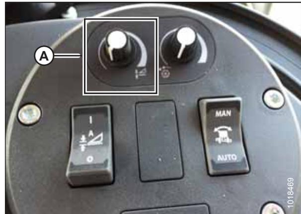
Figura 4.143: Clúster de control de la plataforma
