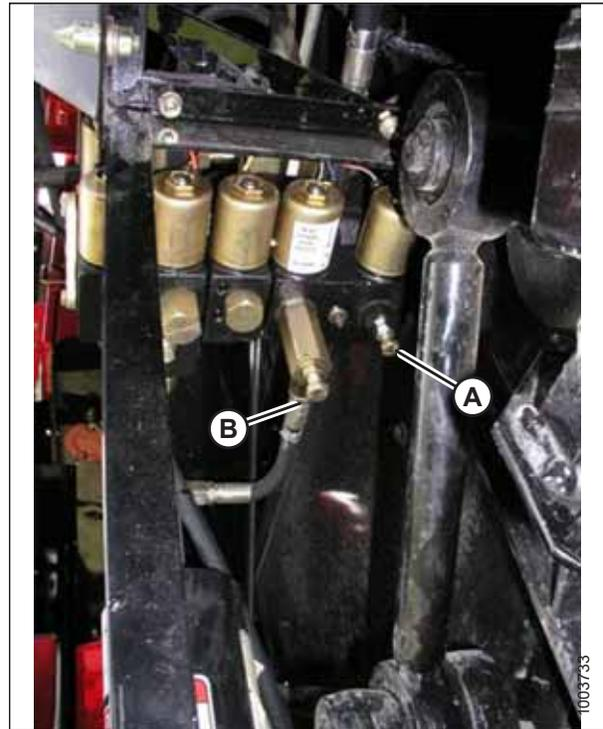
Figura 4.109: Restrictores ajustables de elevación y descenso de la plataforma
