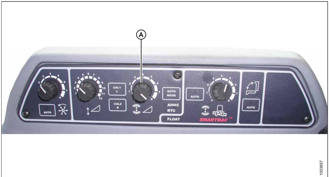
Figura 4.111: Consola de control automático de altura de la plataforma
