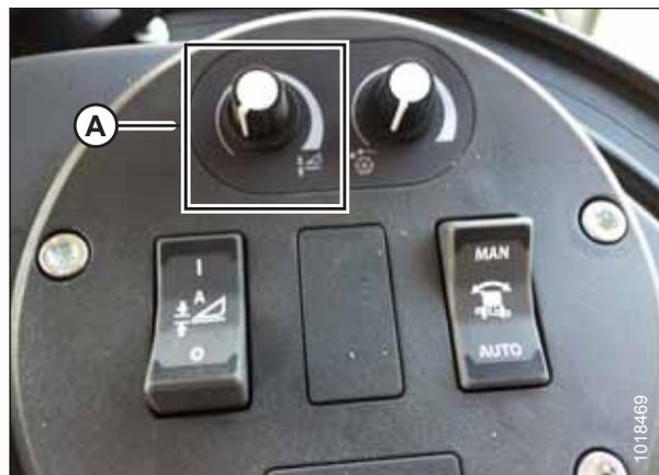
Figura 4.140: Clúster de control de la plataforma
