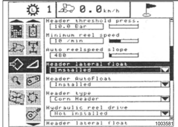
Figura 4.198: Pantalla de la cosechadora New Holland
