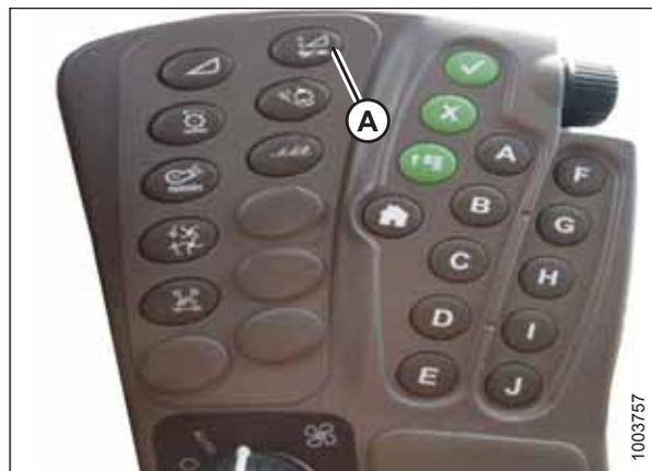
Figura 4.186: Centro de comando de la cosechadora John Deere
