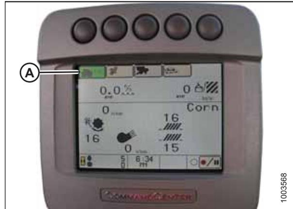
Figura 4.154: Pantalla de la cosechadora John Deere
