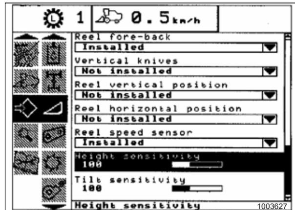
Figura 4.206: Pantalla de la cosechadora New Holland
