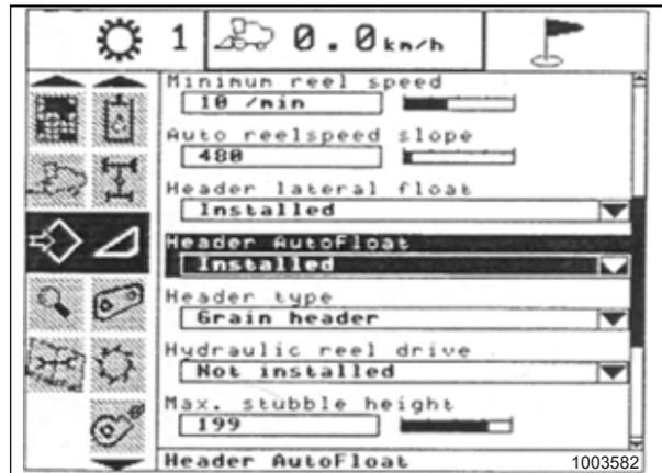
Figura 4.199: Pantalla de la cosechadora New Holland
