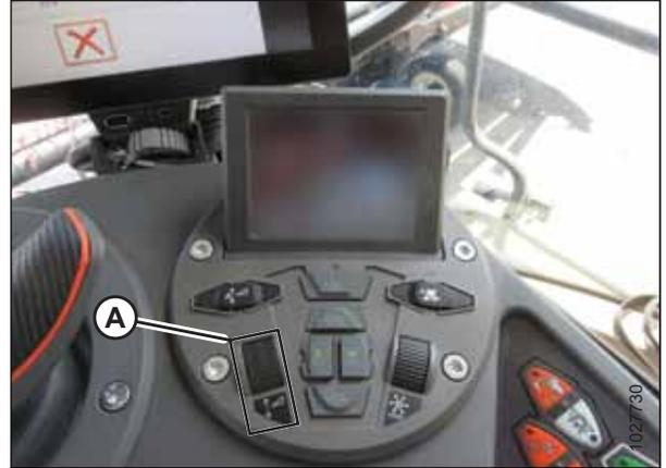
Figura 4.48: Clúster de control de la plataforma
