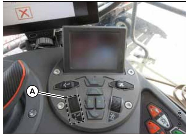
Figura 4.51: Clúster de control de la plataforma
