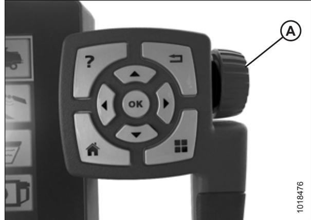
Figura 4.50: La rueda de ajuste en el lado derecho del terminal Tyton
