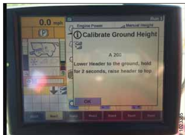
Рисунок 4.60: Калибровка системы автоматического контроля высоты подборщика
