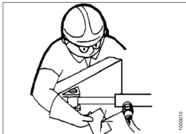
Рисунок 5.196: Проверка наличия гидравлических течей
