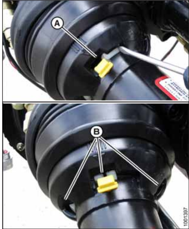
Figura 5.17: Proteção do eixo de transmissão
