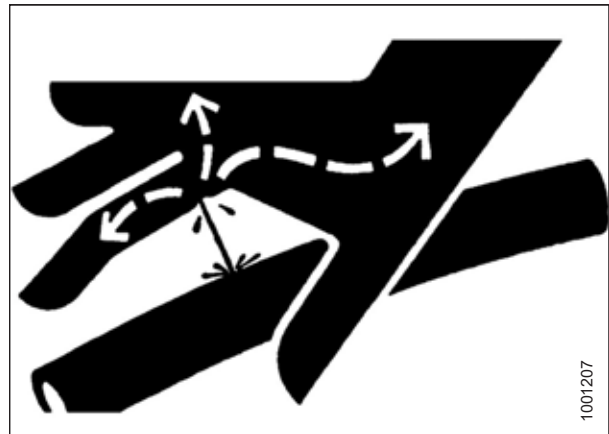
Figura 1.12: Perigo da pressão hidráulica
