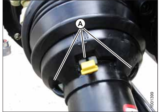
Figura 5.19: Proteção do eixo de transmissão
