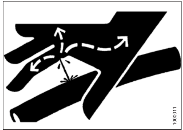
Figura 5.190: Perigo da pressão hidráulica
