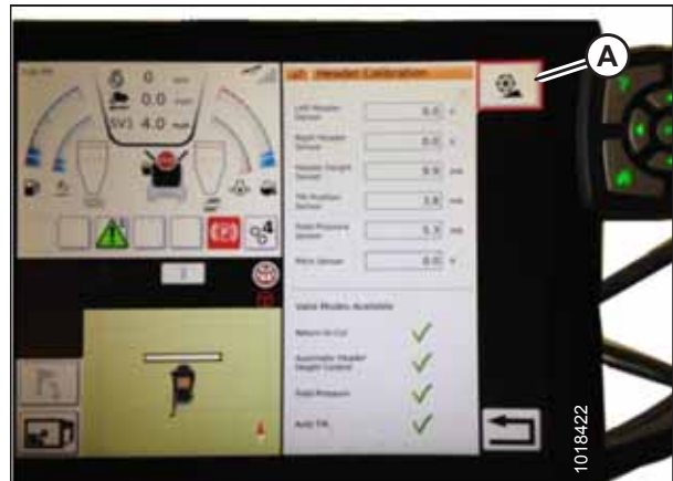
Figure 4.132: Étalonnage de la plateforme
