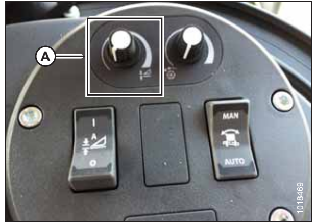
Figure 4.143: Groupe de commande de la plateforme
