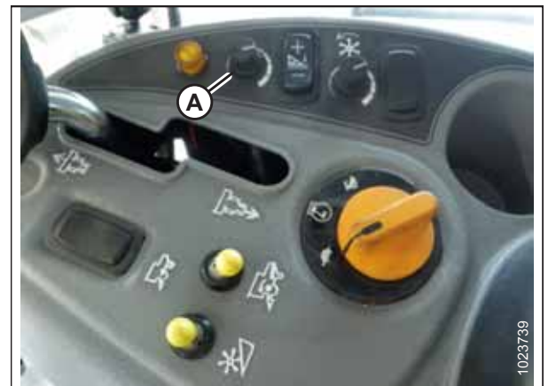
Figure 4.97: Bouton de réglage de la hauteur sur la console de commande de la moissonneuse-batteuse
