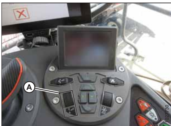
Figure 4.48: Groupe de commande de la plateforme
