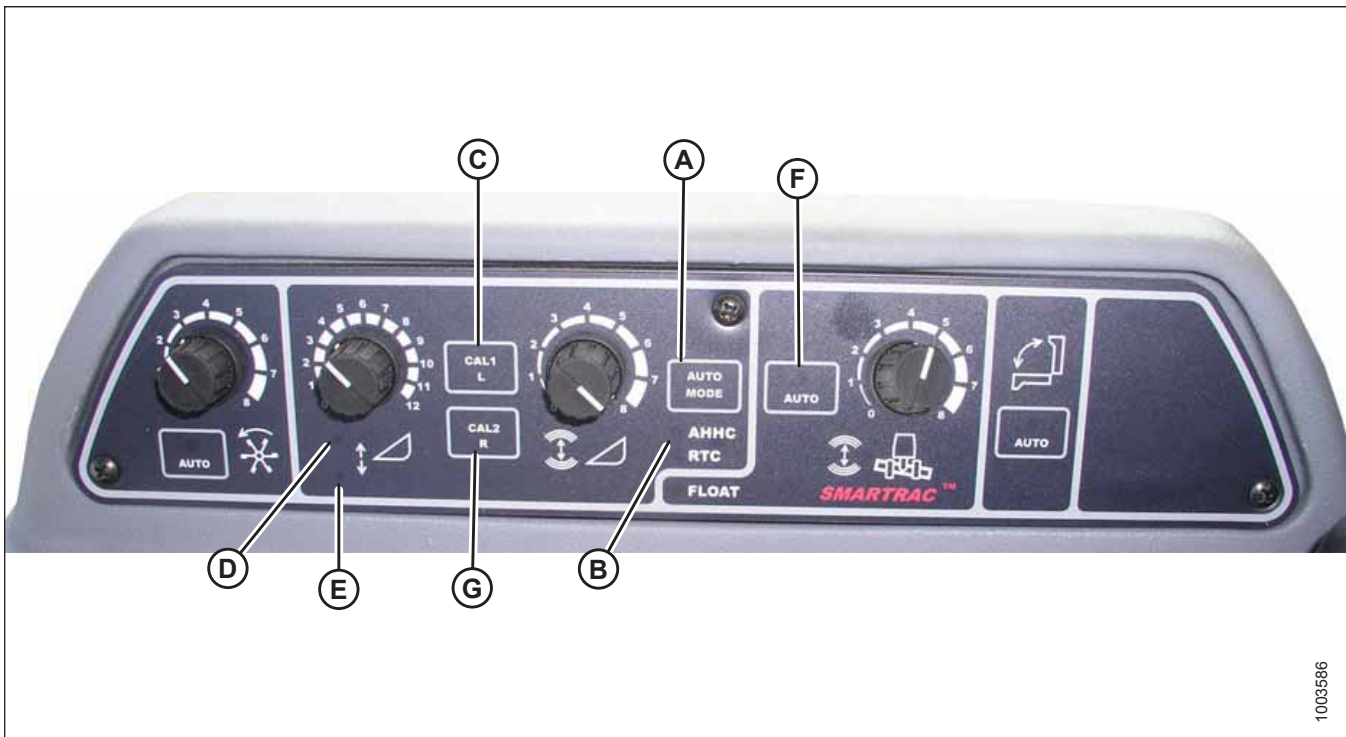
Figure 4.107: Commandes du système de réglage automatique de la hauteur de la plateforme de la moissonneuse-batteuse
