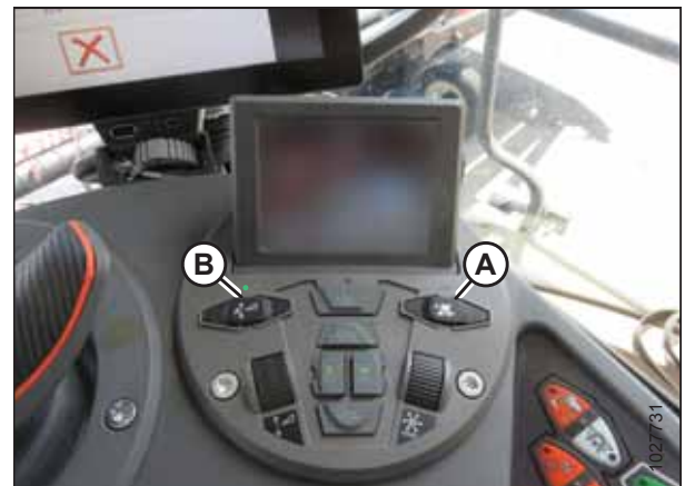
Figure 4.46: Groupe de commande de la plateforme
