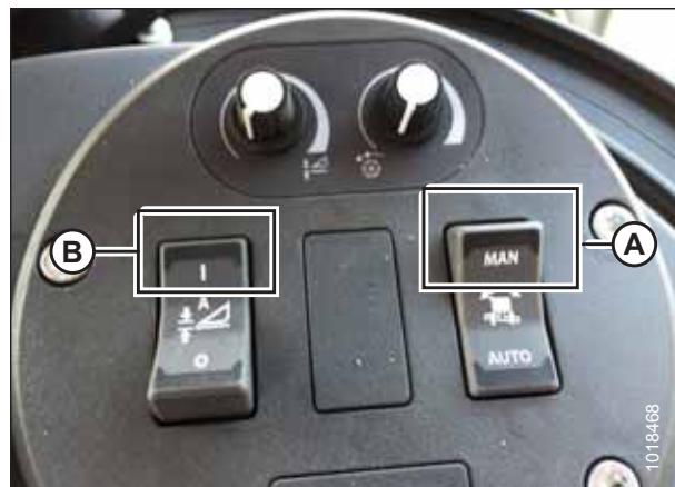
Figure 4.138: Groupe de commande de la plateforme
