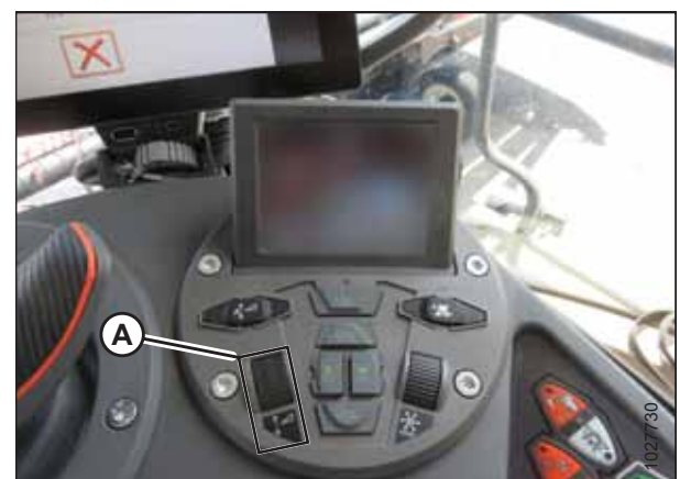
Figure 4.51: Groupe de commande de la plateforme
