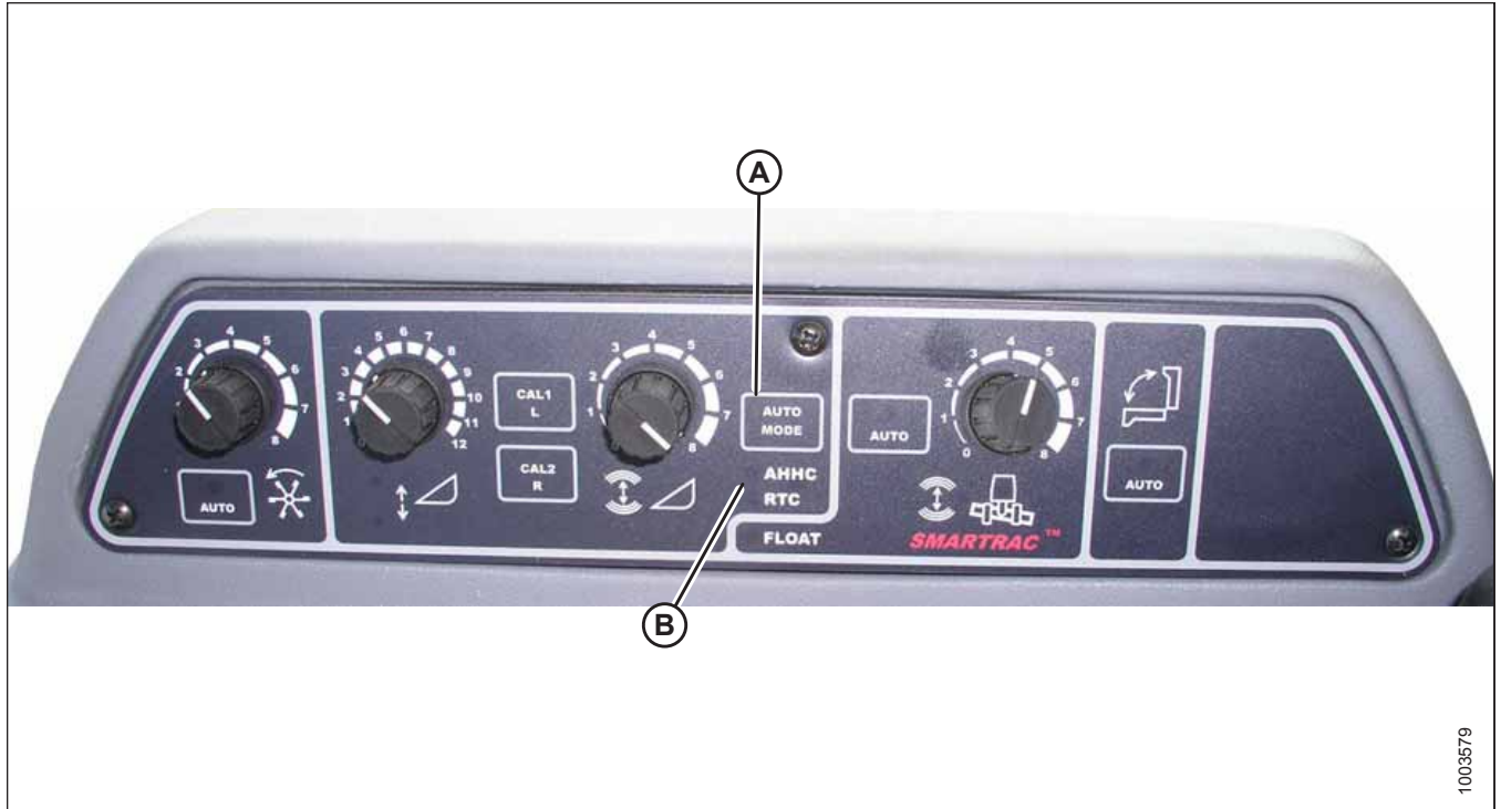
Figure 4.105: Commandes du système de réglage automatique de la hauteur de la plateforme de la moissonneuse-batteuse
