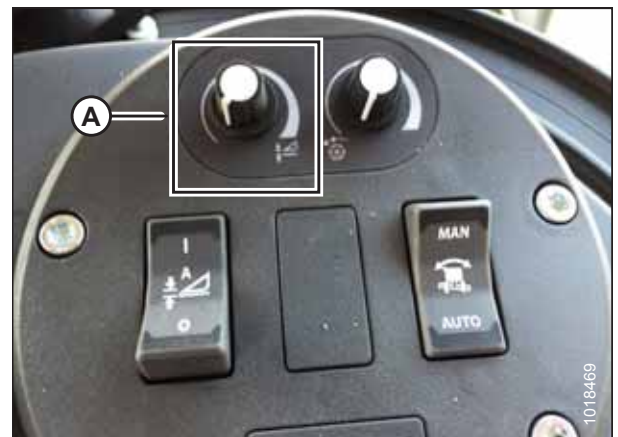
Figure 4.140: Groupe de commande de la plateforme
