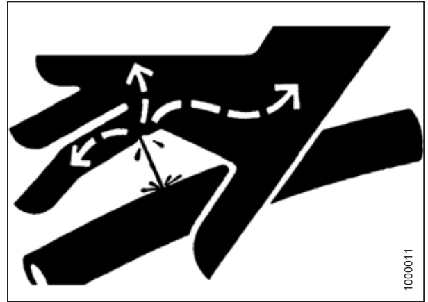
Figure 5.195: Risque lié à la pression hydraulique
