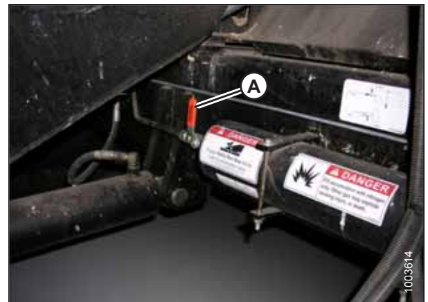
Figure 4.108: Commutateur ON/OFF (marche/arrêt) de l'accumulateur de la moissonneuse-batteuse A – Levier de l'accumulateur (position Off)
