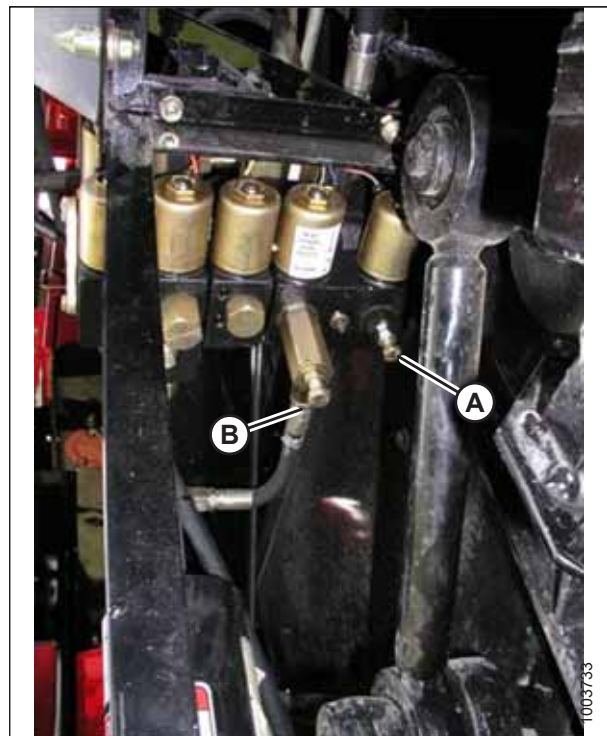
Figure 4.109: Limiteurs réglables d'élévation et d'abaissement de la plateforme
