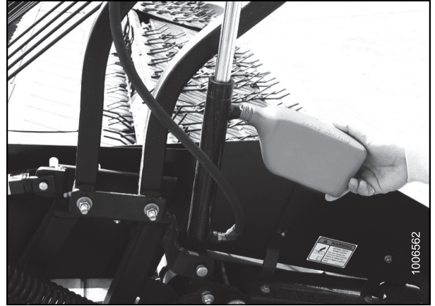
Рисунок 5.190: Вытеснить воздух из гидроцилиндров
