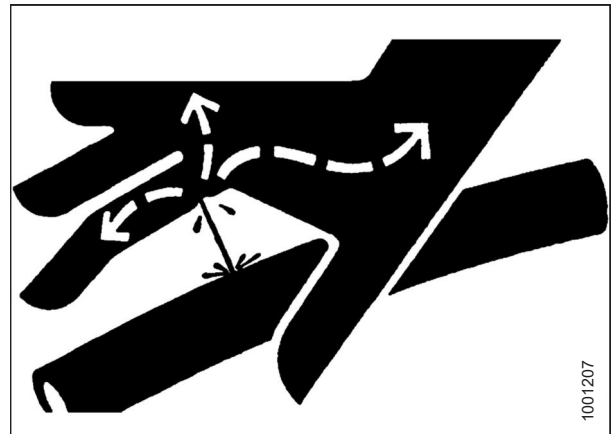
Figura 1.12: Peligro de presión hidráulica
