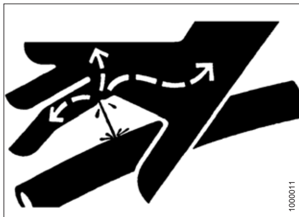
Рисунок 5.178: Опасное давление гидравлической жидкости
