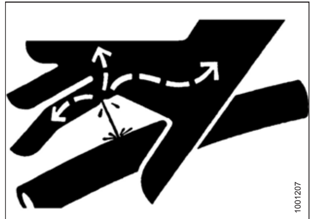
Рисунок 1.12: Опасное давление гидравлической жидкости
