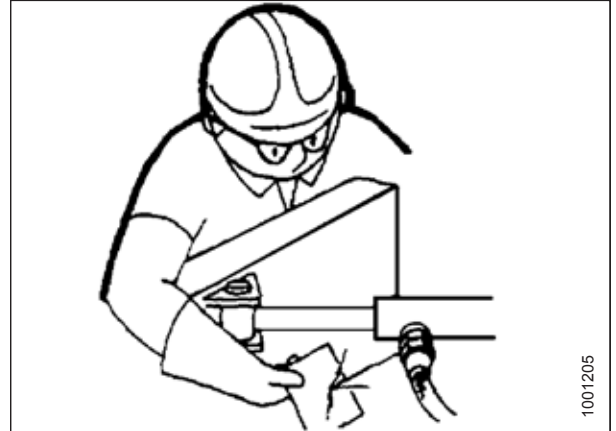
Рисунок 1.11: Проверка наличия гидравлических течей
