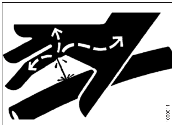
Рисунок 5.191: Опасное давление гидравлической жидкости
