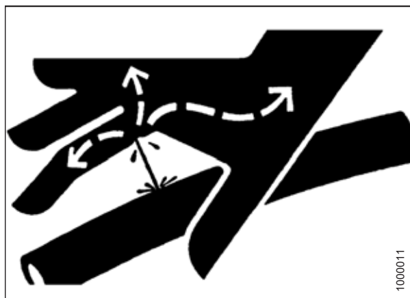
Рисунок 5.188: Опасное давление гидравлической жидкости
