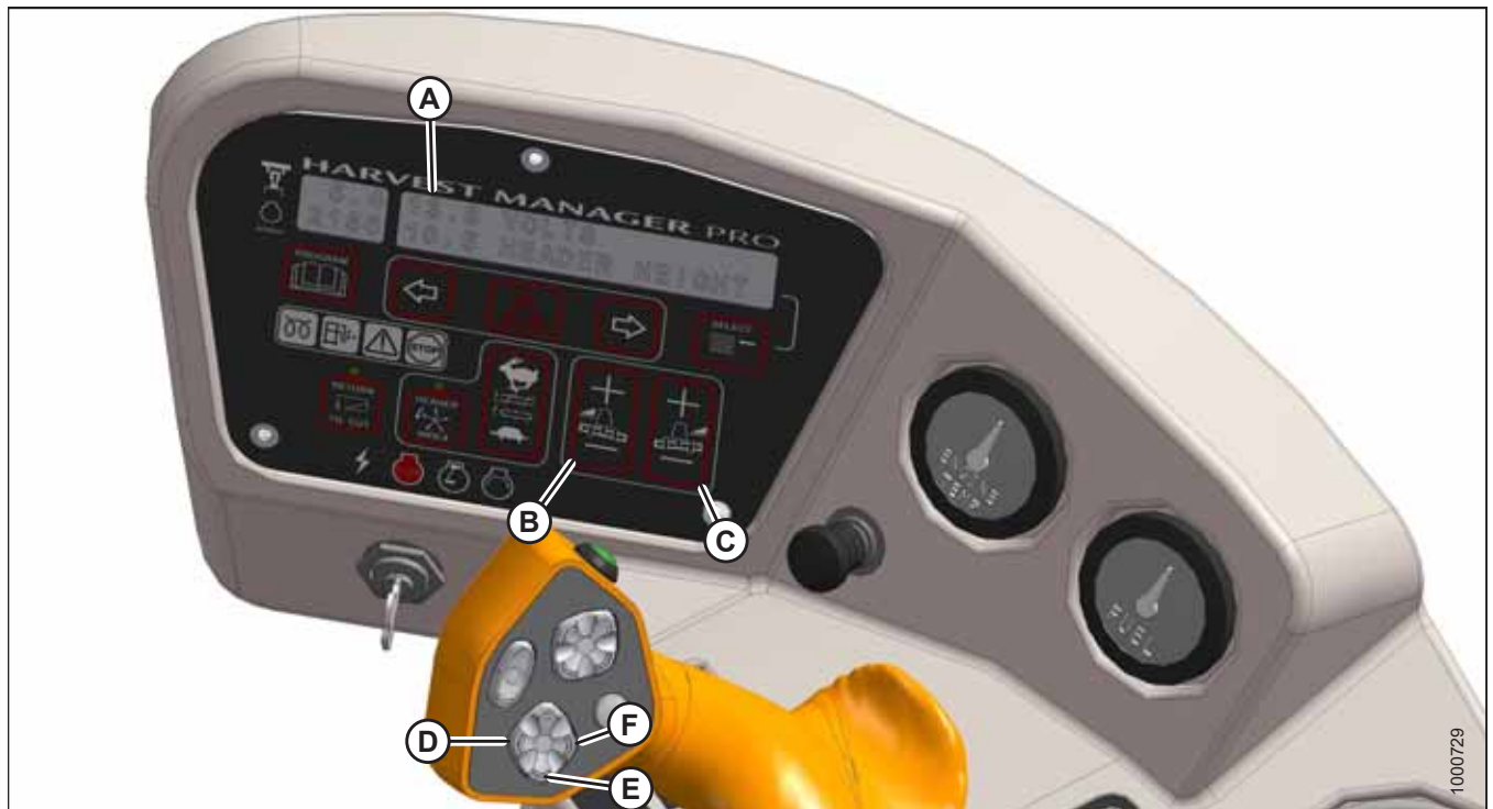
Рисунок 4.74: Регулировка флотации на модуле дисплея кабины (CDM)
