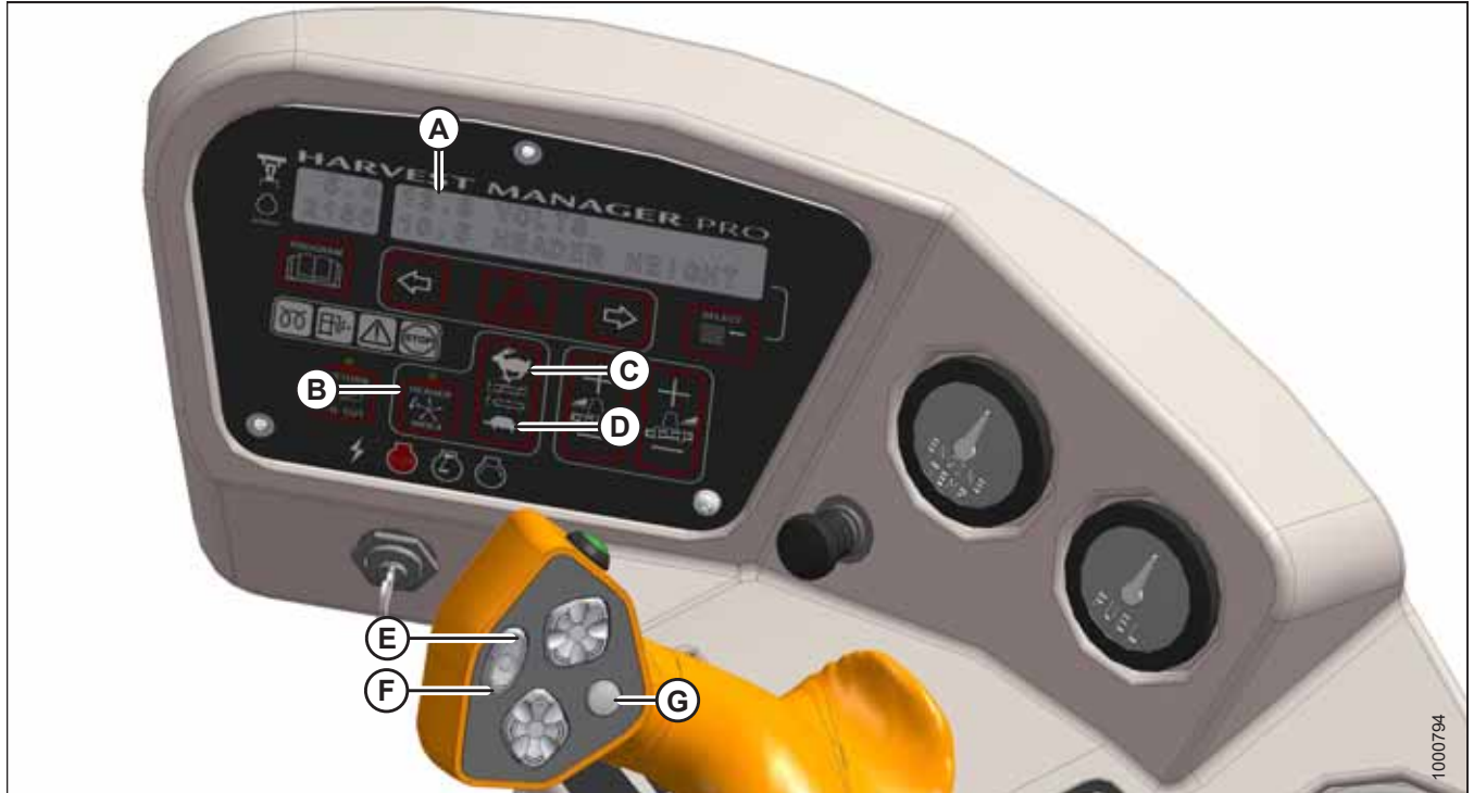
A — дисплей B — дискретное изменение скорости жатки C — шнек быстро D — шнек медленно E — мотовило быстро F — мотовило медленно G — селектор дисплея
