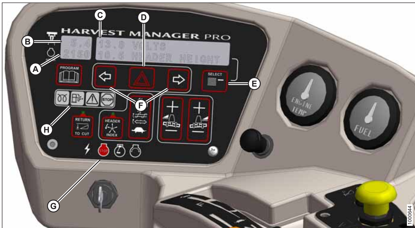
Рисунок 3.57: Дисплейный модуль кабины (CDM). Функции двигателя и косилки
