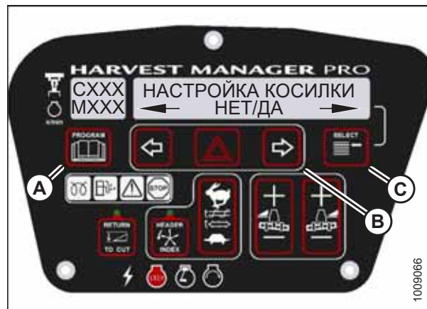
Рисунок 3.86: Кнопки программирования CDM
