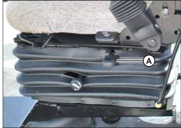
Рисунок 3.8: Фиксация перемещения амортизатора вперед-назад
