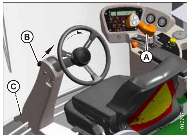
Рисунок 4.21: Двигатель вперед — сиденье обращено к двигателю
