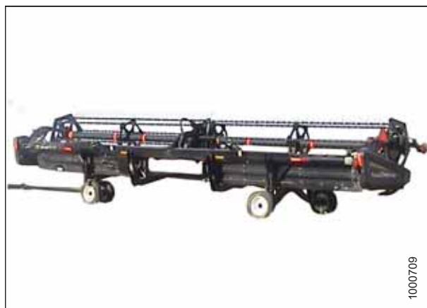
Рисунок 4.40: Жатка в режиме транспортировки
