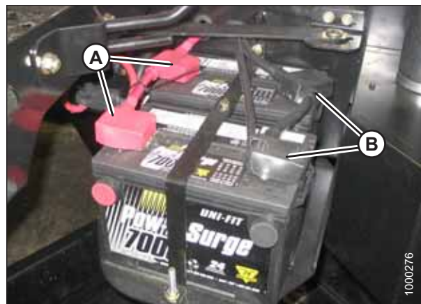
Рисунок 5.120: Расположение клемм аккумуляторной батареи
