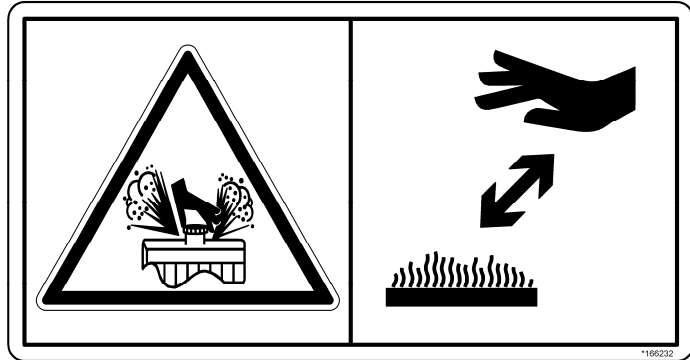
НА КОЖУХЕ ВЕНТИЛЯТОРА #166232
