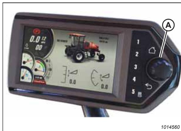
Figure 4.19: Bouton de défilement/de sélection du SPR
