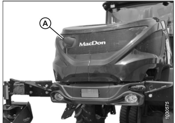
Figure 4.12: Échappement du moteur
