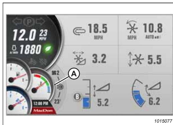
Figure 4.22: Affichage du SPR – Jauge de température du moteur
