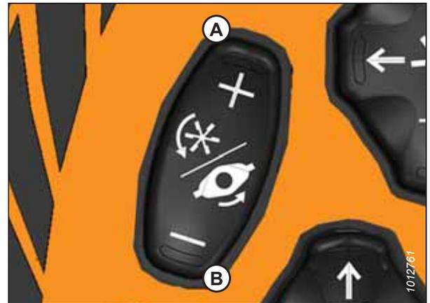
Figure 3.60: Rabatteur du LVS et commutateur de vitesse des disques
