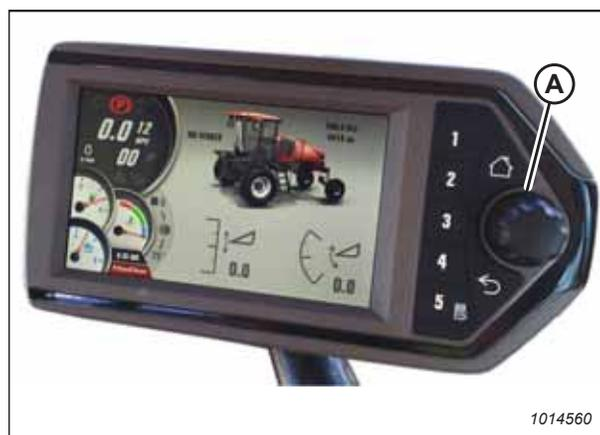
**Figure 4.28: Bouton de défilement/de sélection du SPR**
