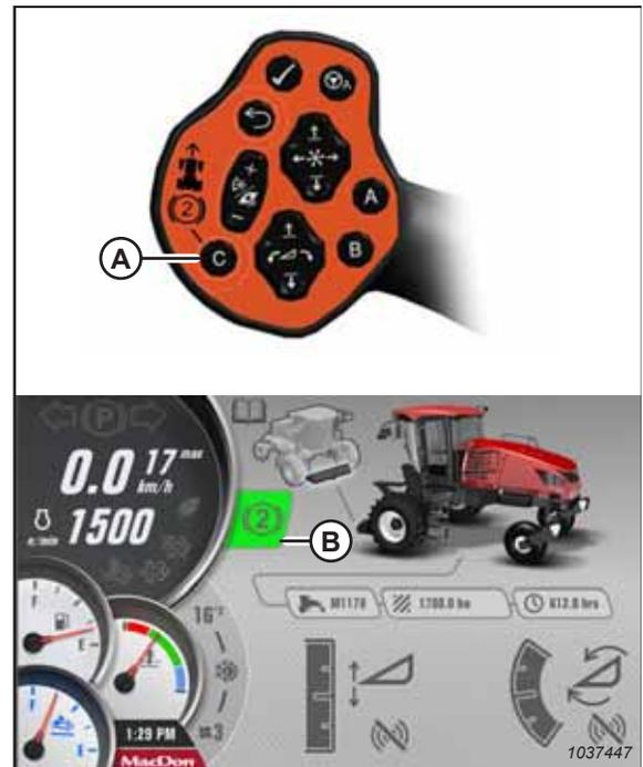
Figure 4.92: Système de freinage secondaire sur le LVS
