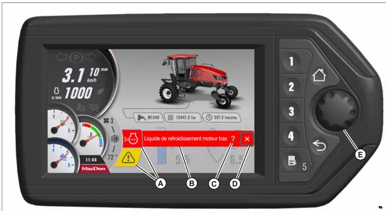
Pour afficher une page de défaut plus détaillée, utilisez le bouton de défilement du SPR (E) pour sélectionner le symbole du point d'interrogation (C).
