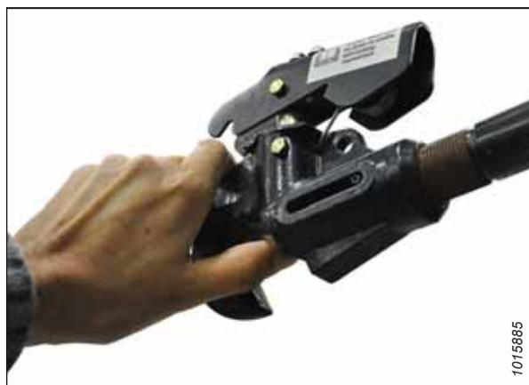
Figure 4.175: Crochet du vérin d'inclinaison
