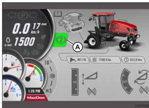
Figure 4.88: Icône du système de freinage secondaire – Exportation vers l'Allemagne uniquement
