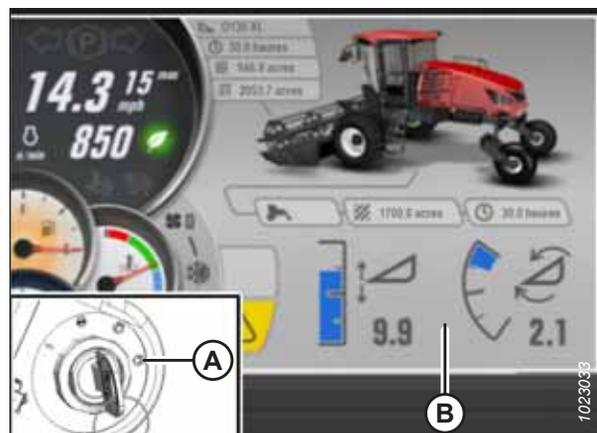
Figure 4.16: Écran de désengagement de la plateforme du SPR
