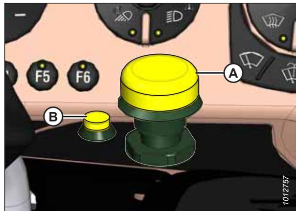
Figure 3.54: Commandes d'entraînement de la plateforme
