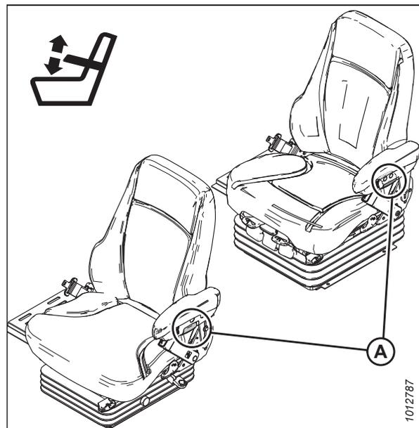
Figure 3.5: Commandes de l'angle de l'accoudoir du siège de l'opérateur
