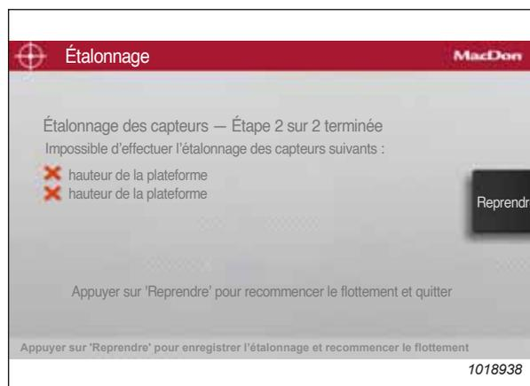
Figure 4.157: Exemple de message d'affichage d'étalonnage échoué
