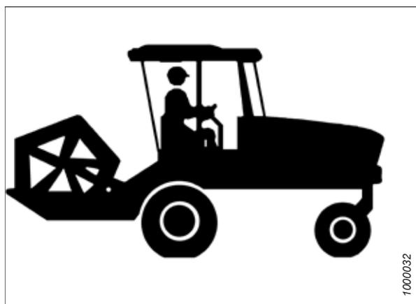
Figure 4.35: Moteur à l'avant – Le siège fait face au moteur
