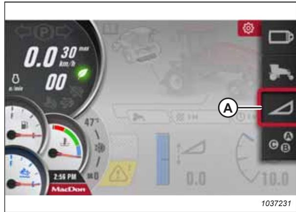
Figure 4.185: Icône des paramètres de la plateforme
