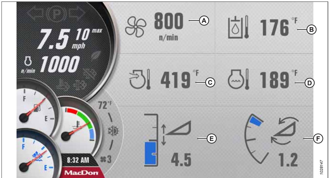
Figure 4.46: Écran d'exécution 4 – Données de refroidissement
