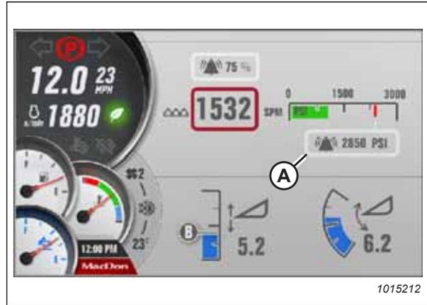
Figure 4.234: Réglage de la pression d'alarme du couteau
