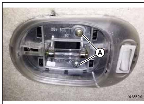
Figure 5.205: Plafonnier d'éclairage sans couvercle
