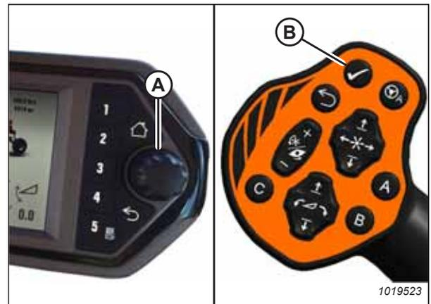
Figure 4.209: Bouton de défilement du SPR et bouton de sélection du LVS
