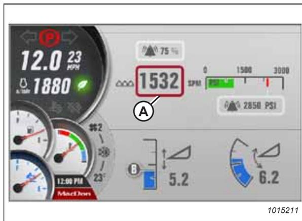
Figure 4.230: Réglage de la vitesse du couteau
