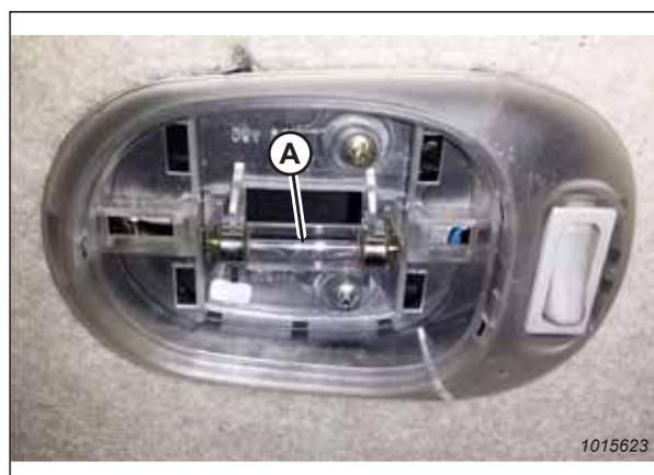
Figure 5.200: Plafonnier d'éclairage sans couvercle
