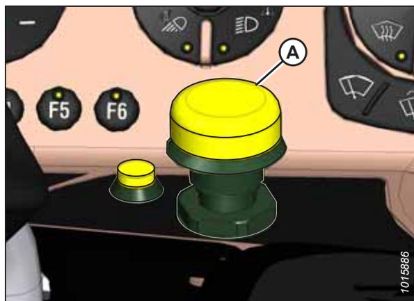
Figure 4.244: Commutateur d'enclenchement de la plateforme
