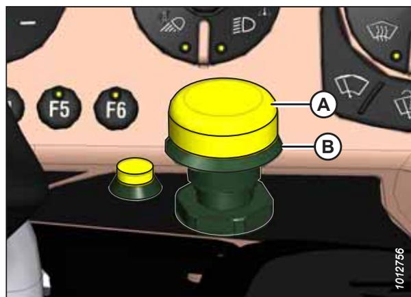
Figure 4.170: Commutateur d'enclenchement de la plateforme
