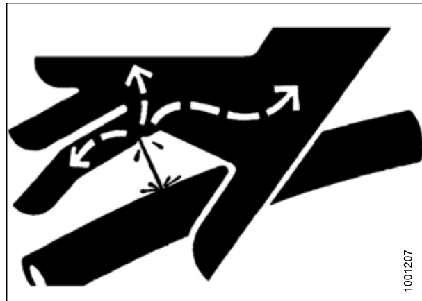
Рисунок 1.12: Опасное давление гидравлической жидкости
