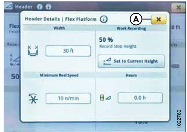
Рисунок 3.319: Дисплей комбайна John Deere серии S7 — окно подробной информации о жатке
