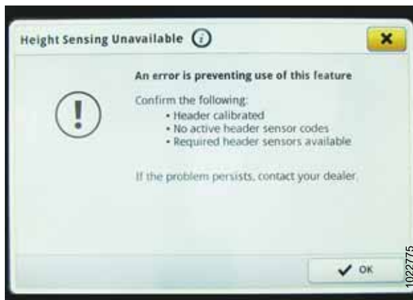
Рисунок 3.324: Дисплей John Deere S7 — сообщение об ошибке чувствительности по высоте
