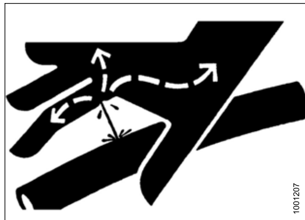
Рисунок 5.2: Опасное давление гидравлической жидкости
