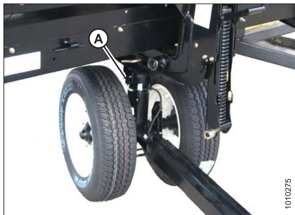
Figura 3.476: Conexão do chicote
