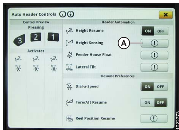
Figura 3.323: Monitor John Deere S7 – Controle automático da plataforma
