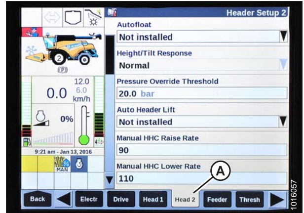
Figura 3.414: Monitor colheitadeiras New Holland
