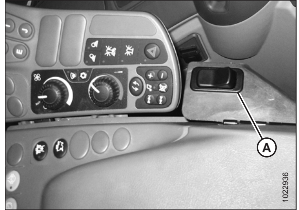
Figura 3.81: Localização da chave seletora – John Deere
