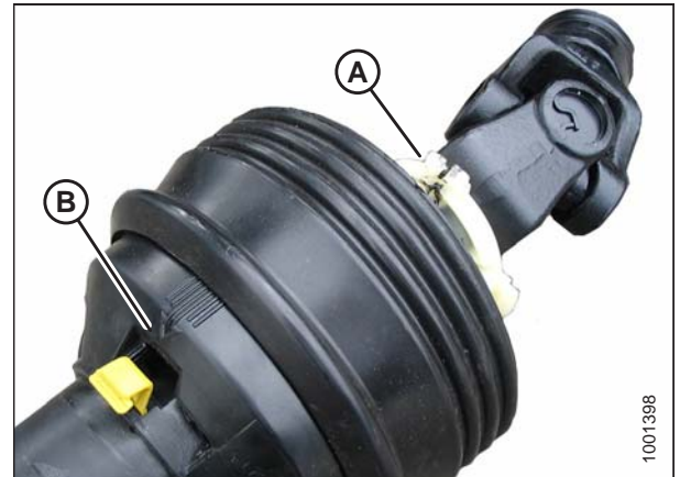
Figura 5.46: Proteção do eixo de transmissão
