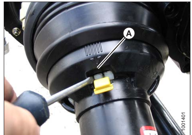
Figura 5.48: Proteção do eixo de transmissão
