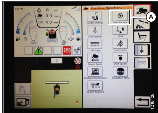
Figura 3.216: Configurações do molinete no menu principal da colheitadeira
