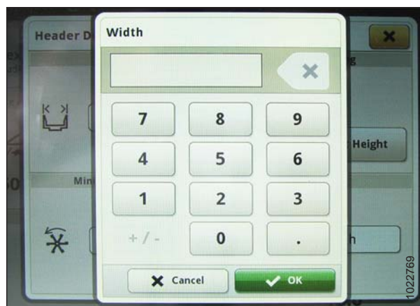
Figura 3.318: Monitor John Deere S7 – Ajuste de largura da plataforma
