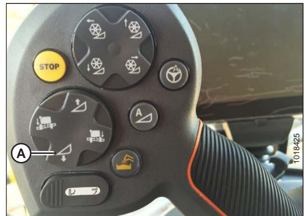
Figura 3.227: Interruptor de descida da plataforma
