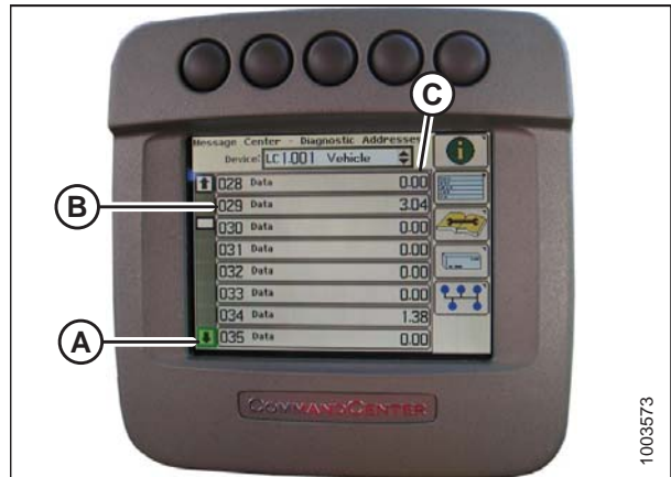
Figura 3.276: Monitor da colheitadeira John Deere
