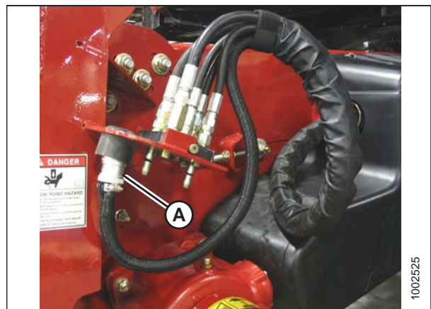
Figura 4.8: Conectores da colheitadeira
