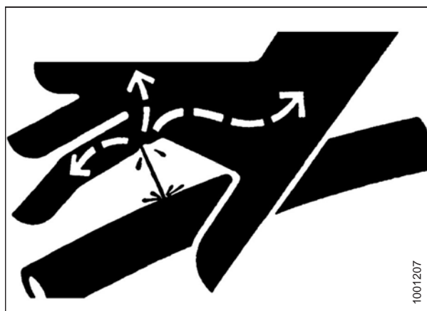
Figura 1.12: Perigo da pressão hidráulica
