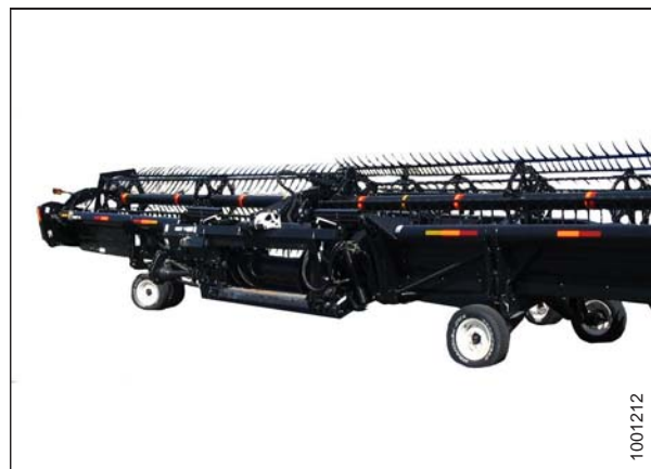
Figura 6.12: Rodas de transporte/estabilizadoras
