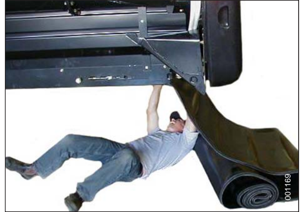
Figura 5.186: Instalação das esteiras
