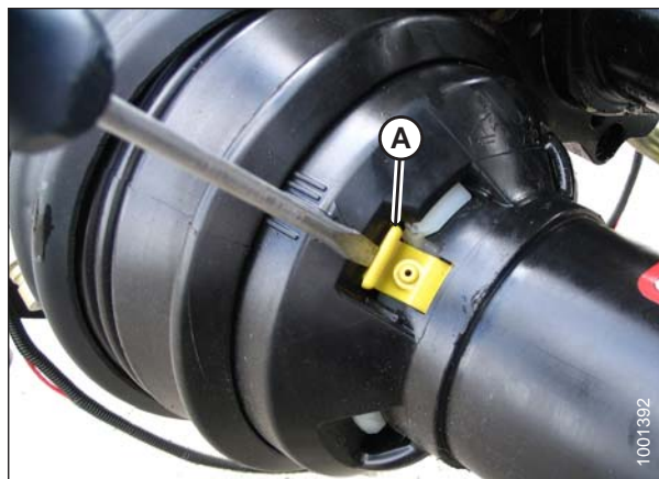
Figura 5.44: Proteção do eixo de transmissão
