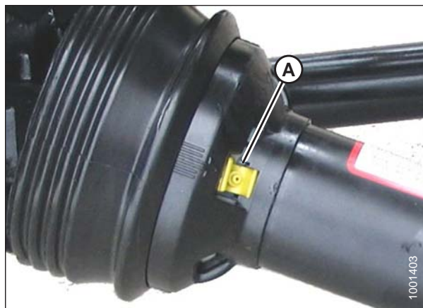
Figura 5.49: Proteção do eixo de transmissão
