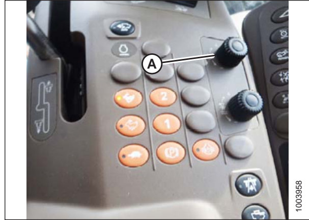
Figura 3.256: Indicador de controle automático da plataforma
