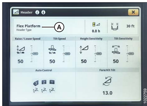
Figura 3.316: Monitor John Deere S7 – Página da plataforma
