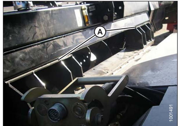
Figura 4.23: Adaptador do alimentador
