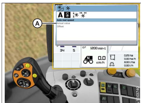
Figura 3.385: Monitor da colheitadeira CLAAS, console e controle
