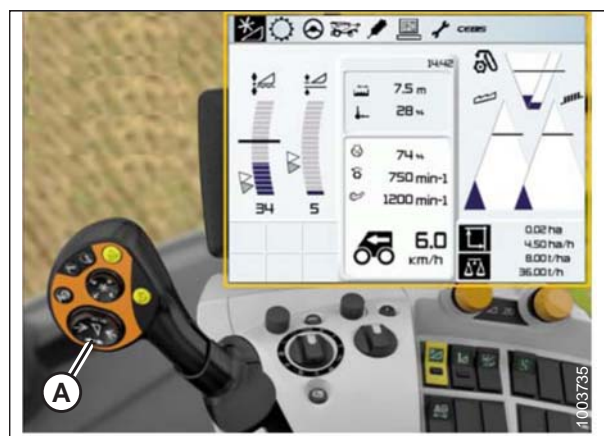
Figura 3.379: Monitor da colheitadeira CLAAS, console e controle
