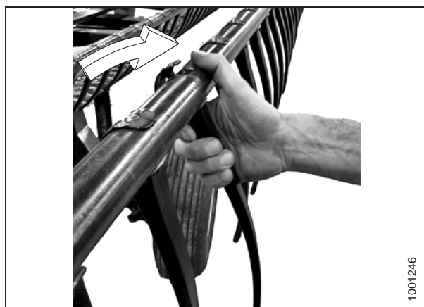
Figura 5.240: Instalação do dedo
