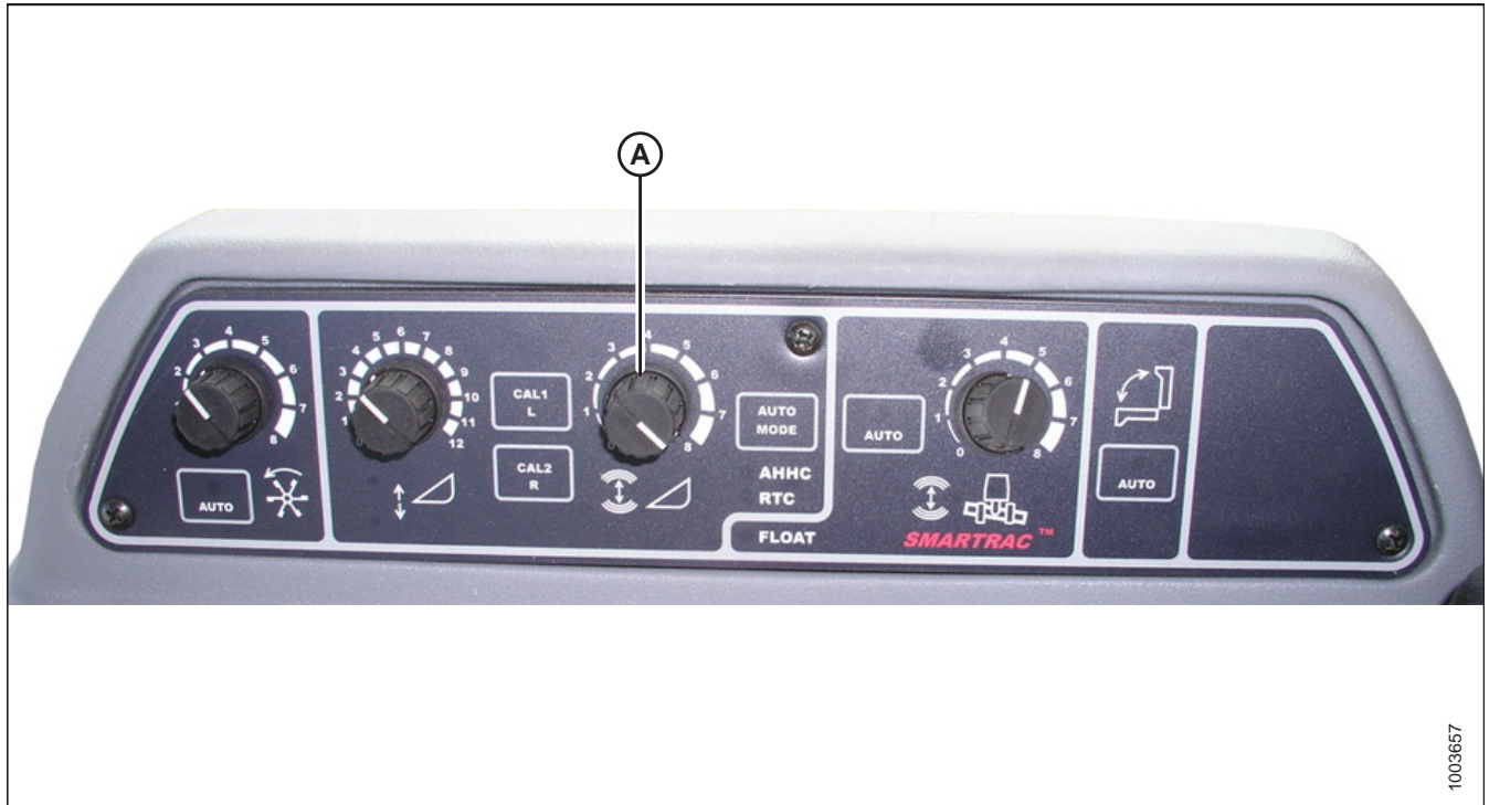
Figura 3.203: Console de controle de altura automática da plataforma
