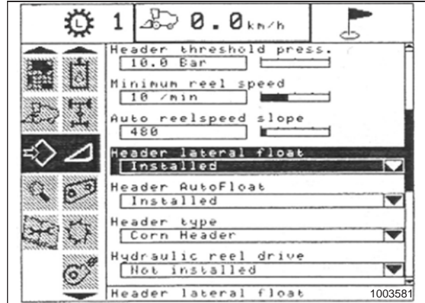
Figura 3.394: Monitor colheitadeiras New Holland
