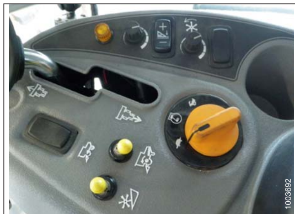
Figura 3.181: Botão de ajuste de altura no console de controle da colheitadeira
