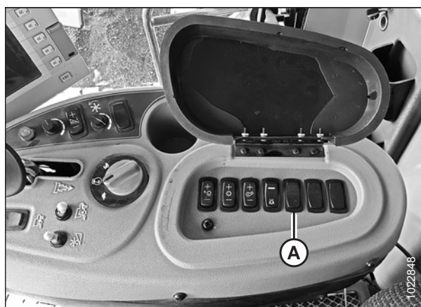
Figura 3.79: Localização da chave seletora – AGCO
