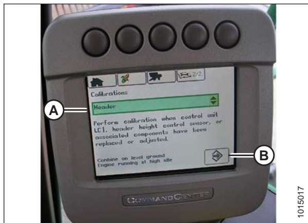
Figura 3.278: Monitor da colheitadeira John Deere
