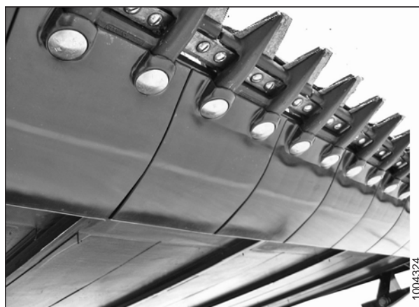
Figura 6.6: Placas de desgaste da barra de corte
