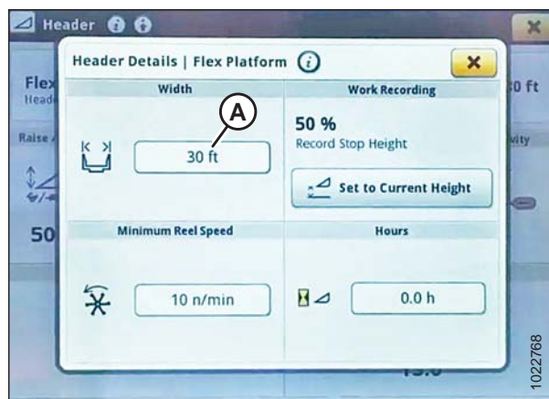
Figura 3.317: Monitor John Deere S7 – Janela de detalhes da plataforma
