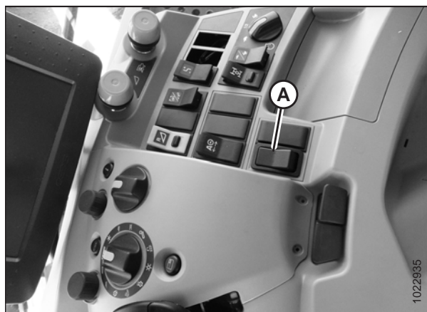
Figura 3.80: Localização da chave seletora – CLAAS
