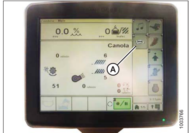
Figura 3.298: Monitor da colheitadeira John Deere
