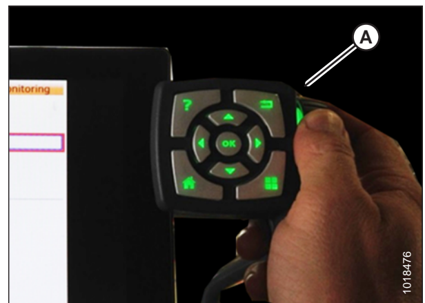
Figura 3.238: Botão de rolagem para ajustes
