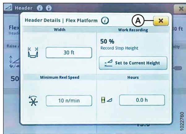
Figura 3.319: Monitor John Deere S7 – Janela de detalhes da plataforma
