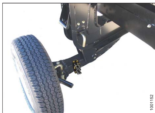
Figura 3.466: Roda esquerda em posição de transporte
