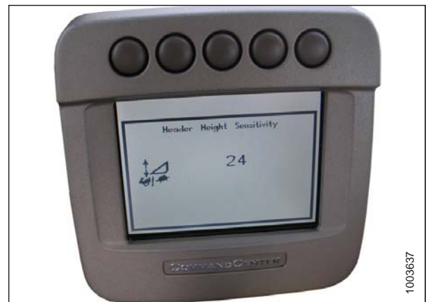
Figura 3.281: Monitor da colheitadeira John Deere
