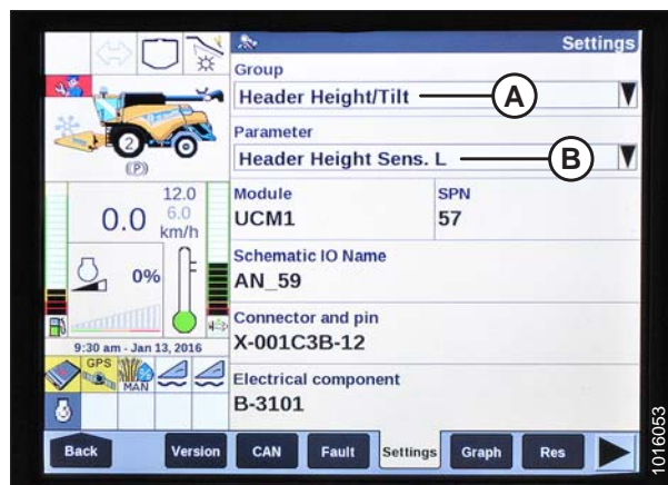
Figura 3.422: Monitor colheitadeiras New Holland
