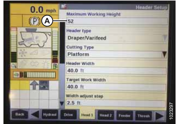
Figura 3.253: Pantalla de la cosechadora Case - Página de configuración de la plataforma
