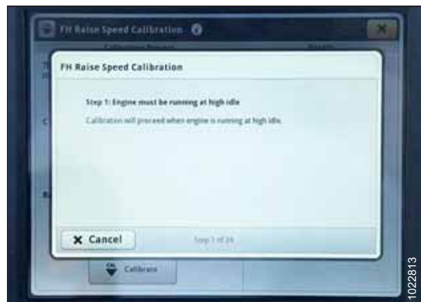
Figura 3.499: Pantalla John Deere S7 - Calibración del embocador
