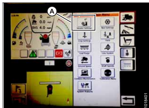
Figura 3.384: Configuración de la plataforma en el Menú principal de la cosechadora
