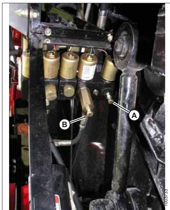
Figura 3.376: Restrictores ajustables de elevación y descenso de la plataforma
