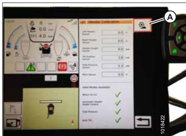
Figura 3.404: Calibración de la plataforma
