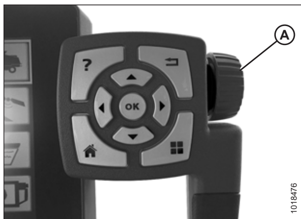
Figura 3.233: La rueda de ajuste en el lado derecho del terminal Tyton
