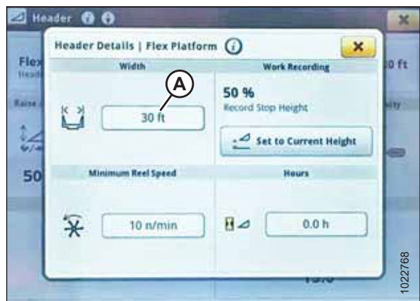
Figura 3.480: Pantalla John Deere S7 - Ventana de detalles de la plataforma
