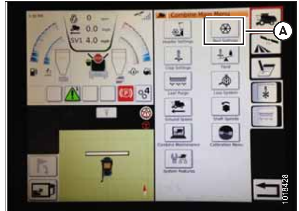
Figura 3.392: Ajustes del molinete en el menú principal de la cosechadora
