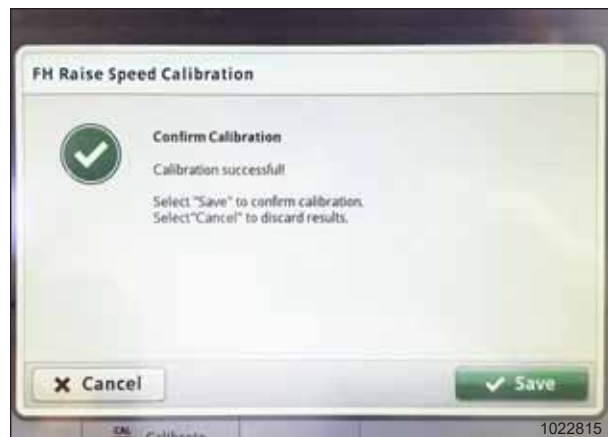
Figura 3.500: Pantalla John Deere S7 - Calibración del embocador
