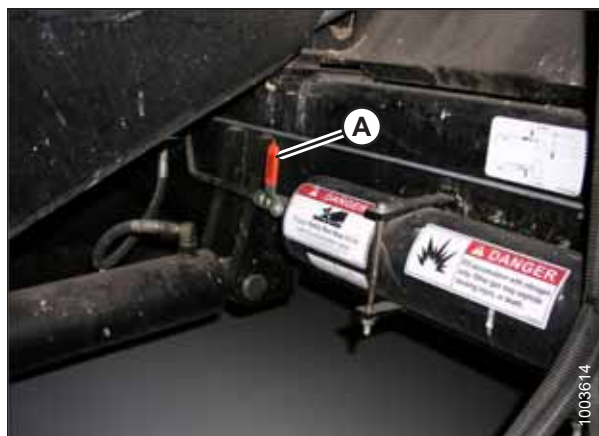
Figura 3.375: Interruptor de ENCENDIDO/APAGADO del acumulador de la cosechadora
