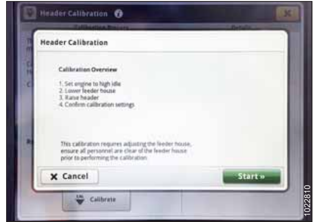
Figura 3.506: Pantalla John Deere S7 - Calibración de la plataforma
