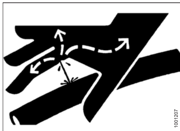
Figura 1.12: Peligro de presión hidráulica
