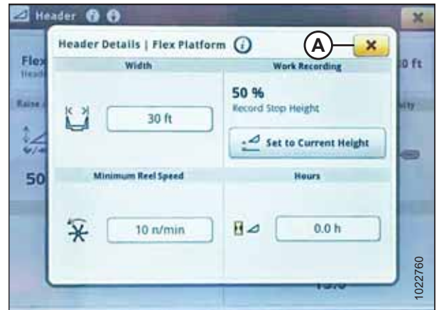
Figura 3.482: Pantalla John Deere S7: cuadro de diálogo de detalles de la plataforma
