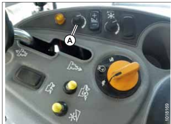
Figura 3.297: Perilla de ajuste de altura en la consola de control de la cosechadora
