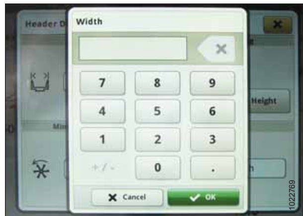
Figura 3.469: Pantalla John Deere S7 - Configuración del ancho de la plataforma
