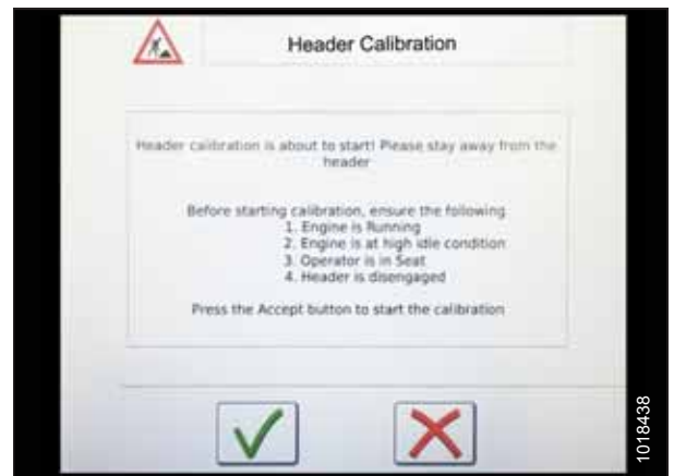
Figura 3.393: Advertencia de calibración de la plataforma
