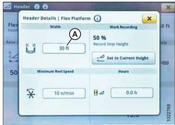
Figura 3.468: Pantalla John Deere S7 - Ventana de detalles de la plataforma
