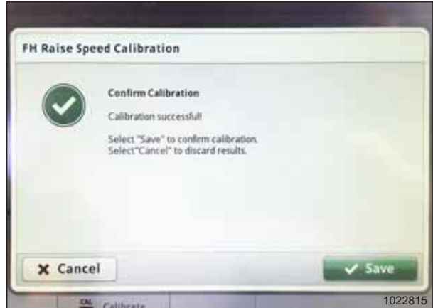
Figura 3.488: Pantalla John Deere S7 - Calibración del embocador
