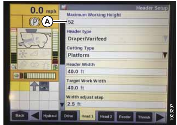
Figura 3.243: Pantalla de la cosechadora Case - Página de configuración de la plataforma
