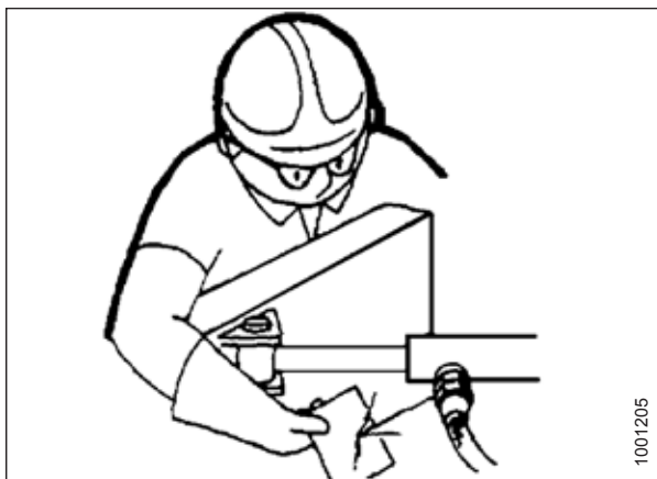
Figura 5.2: Verificación de pérdidas hidráulicas
