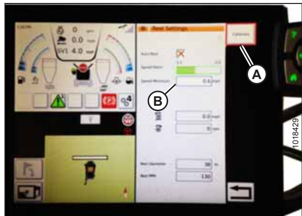
Figura 3.205: Calibración de ajustes del molinete
