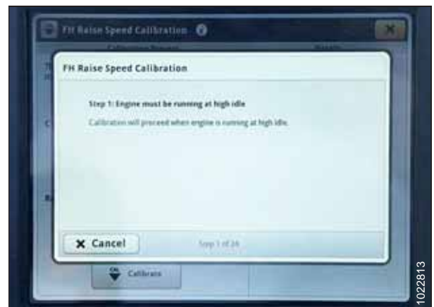
Рисунок 3.499: Дисплей John Deere S7 — калибровка наклонной камеры
