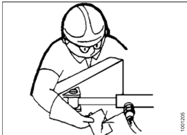
Рисунок 1.11: Проверка наличия гидравлических течей
