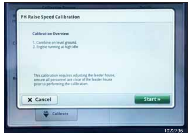
Рисунок 3.498: Дисплей John Deere S7 — калибровка наклонной камеры
