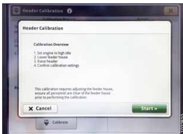
Рисунок 3.506: Дисплей John Deere S7 — калибровка жатки
