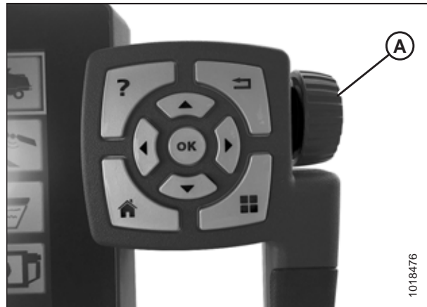
Рисунок 3.414: Регулировочное колесо на правой стороне терминала Tyton
