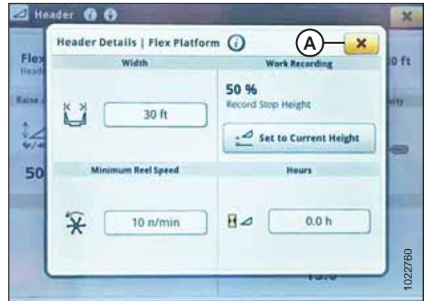
Рисунок 3.482: Дисплей комбайна John Deere серии S7: диалоговое окно подробной информации о жатке
