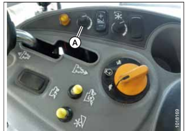
Рисунок 3.297: Ручка регулировки высоты на консоли управления комбайна
