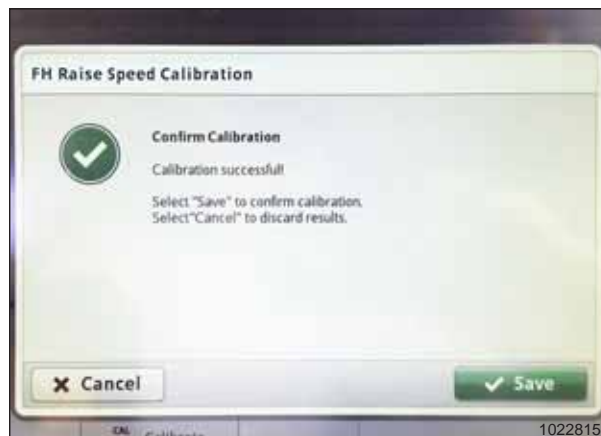
Рисунок 3.500: Дисплей John Deere S7 — калибровка наклонной камеры
