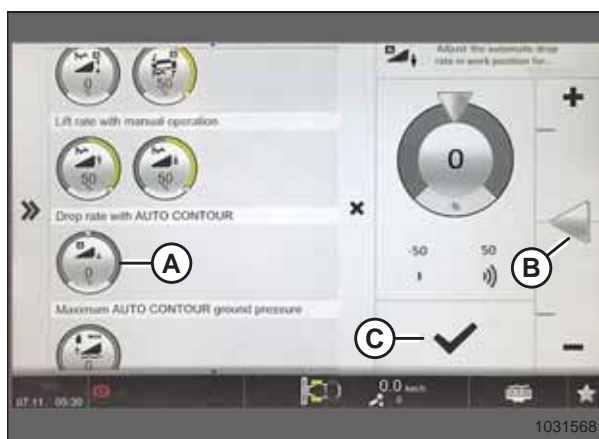
Рисунок 3.360: Страница скорости опускания с автоконтуром
