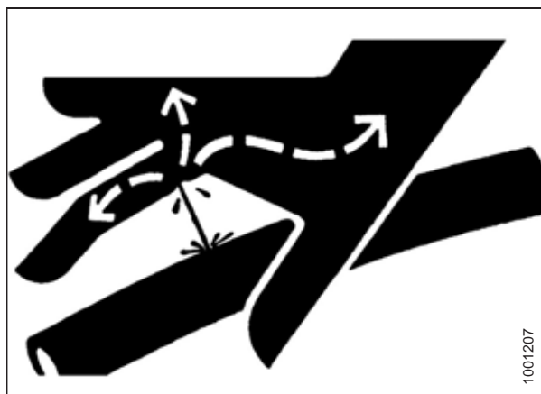
Рисунок 1.12: Опасное давление гидравлической жидкости
