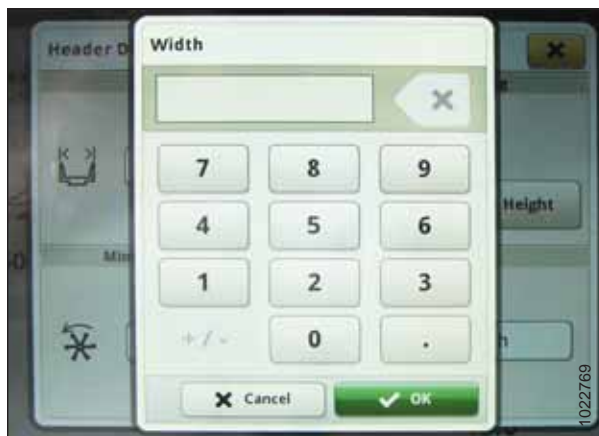
Рисунок 3.481: Дисплей John Deere S7 — настройка ширины жатки
