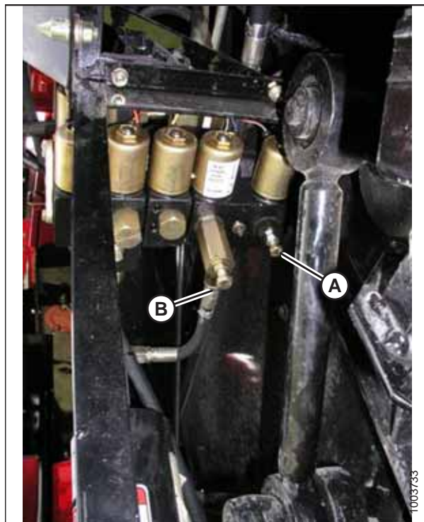
Рисунок 3.376: Регулируемые ограничители подъема и опускания жатки
