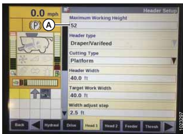
Рисунок 3.253: Дисплей комбайна Case: экран настройки жатки
