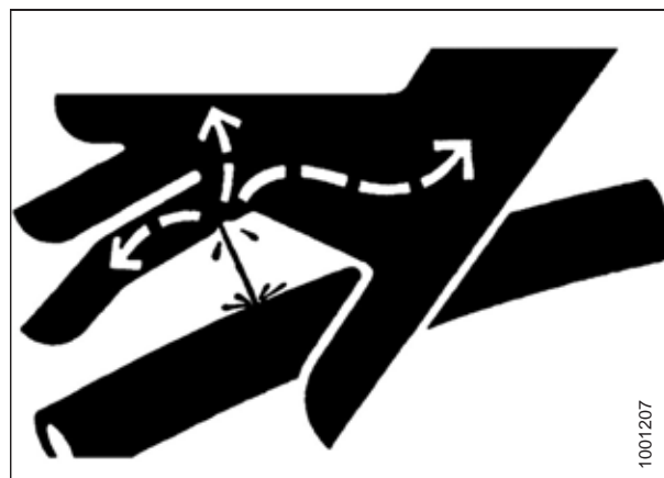
Рисунок 5.1: Опасное давление гидравлической жидкости
