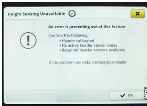
Рисунок 3.487: Дисплей John Deere S7 — сообщение об ошибке чувствительности по высоте
