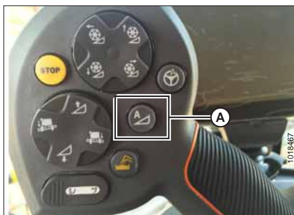
Рисунок 3.230: Автоматический контроль высоты жатки (АННС) на ручке управления
