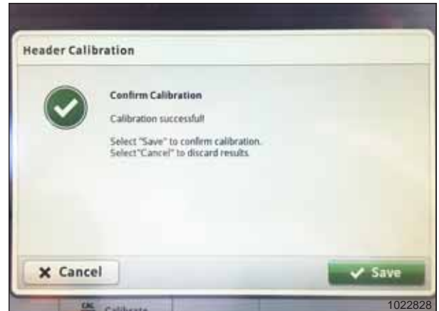
Рисунок 3.507: Дисплей John Deere S7 — калибровка жатки
