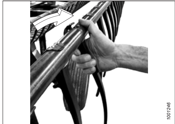
Figura 4.296: Montarea degetului din plastic
