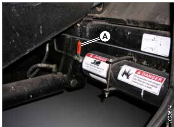
Figura 3.562: Comutatorul ON/OFF al acumulatorului combinei
