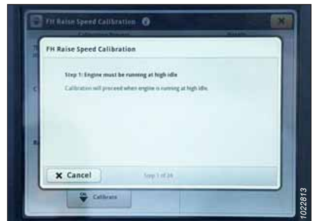
Figura 3.716: Afișajul John Deere S7 – Calibrarea carcsei alimentatorului
