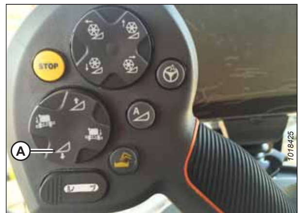
Figura 3.590: Comutator pentru heder în jos
