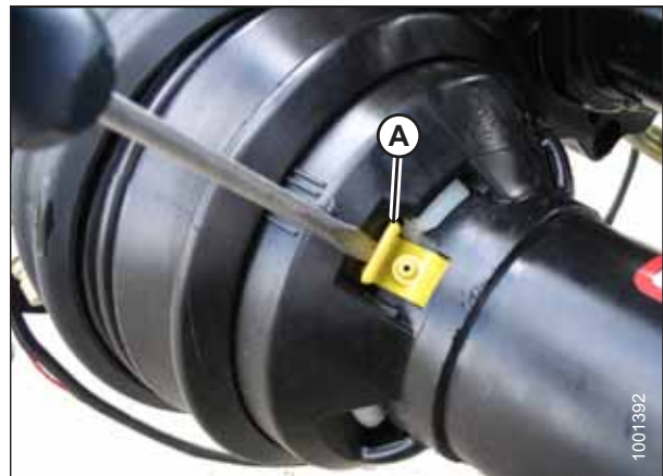
Figura 5.48: Apărătoarea liniei de transmisie
