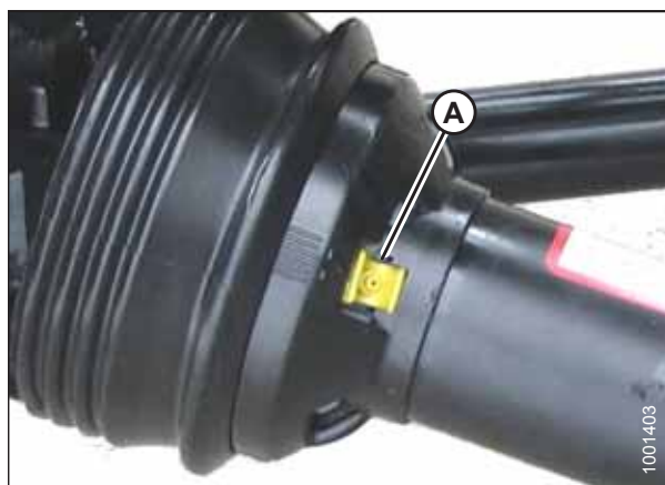
Figura 5.53: Apărătoarea liniei de transmisie
