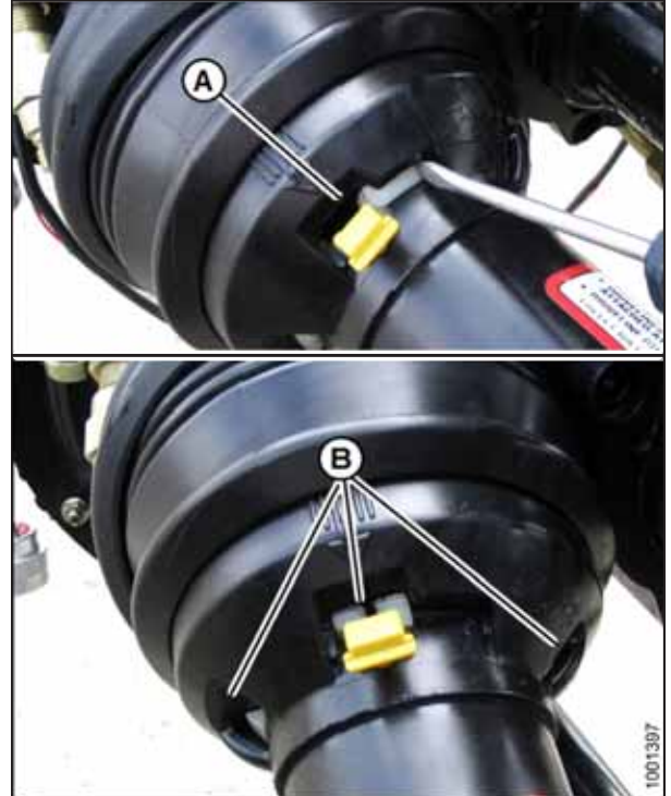
Figura 5.49: Apărătoarea liniei de transmisie
