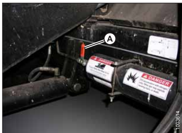
Figura 3.375: Comutatorul ON/OFF al acumulatorului combinei
