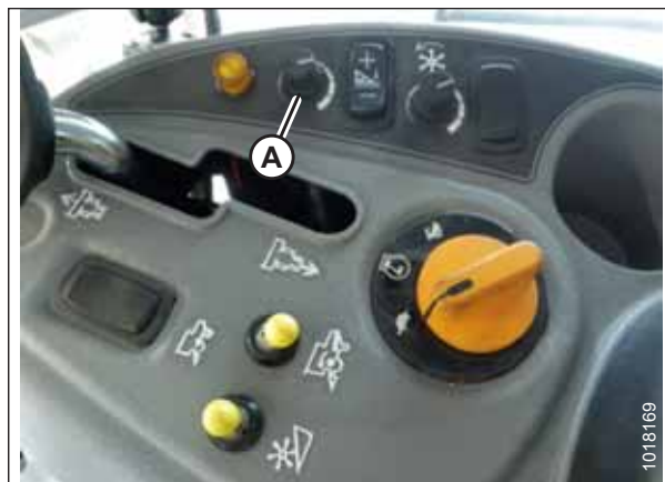
Figura 3.297: Butonul de reglare a înălțimii de pe consola de comandă a combinei
