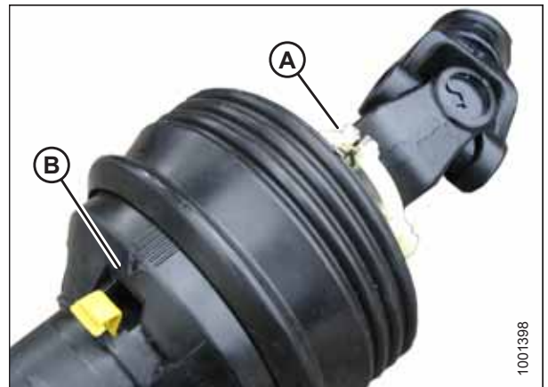
Figura 5.50: Apărătoarea liniei de transmisie
