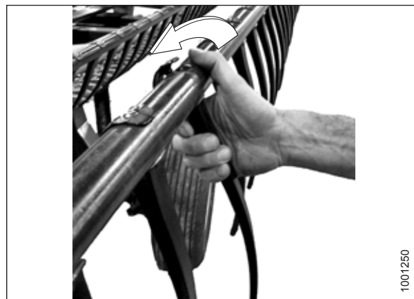
Figura 5.286: Demontarea degetului din plastic
