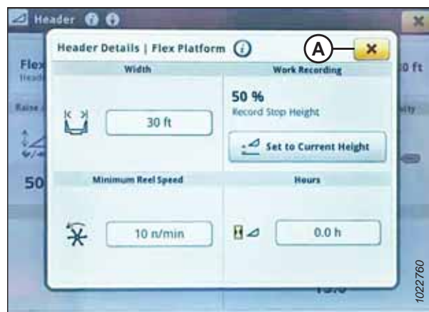
Rysunek 3.699: Wyświetlacz kombajnu John Deere S7 — okno dialogowe Header Details (Szczegóły hedera)
