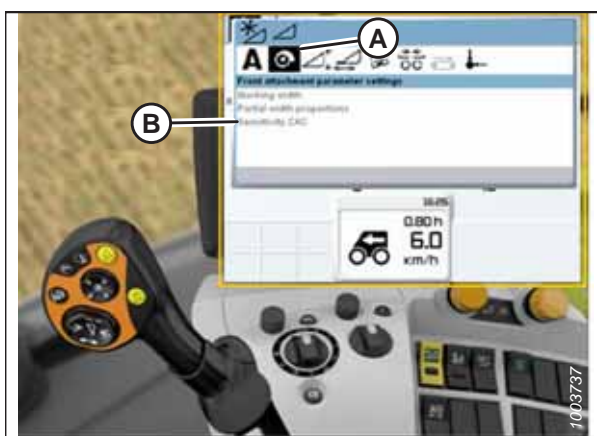
Rysunek 3.518: Wyświetlacz, konsola i drążek sterujący kombajnu CLAAS
