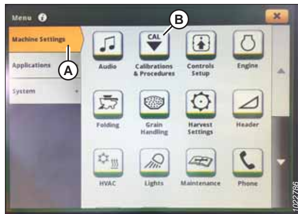
Rysunek 3.712: Wyświetlacz kombajnu John Deere S7 — ustawienia maszyny
