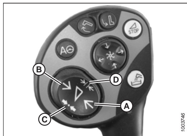
Rysunek 3.498: Przyciski na drążku sterującym
