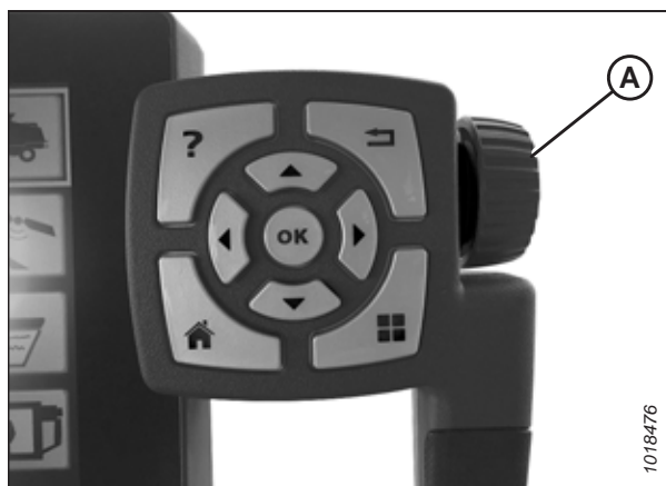
Rysunek 3.601: Pokrętło regulacyjne po prawej stronie terminala Tyton
