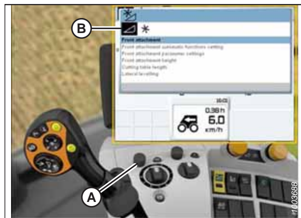
Rysunek 3.511: Wyświetlacz, konsola i drążek sterujący kombajnu CLAAS
