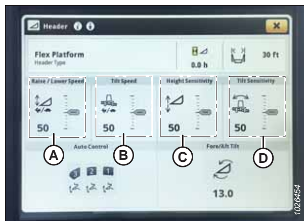
Rysunek 3.700: Wyświetlacz kombajnu John Deere S7 — strona Header (Heder)
