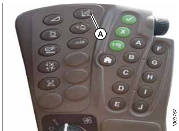
Rysunek 3.666: Wyświetlacz Command Center kombajnu John Deere
