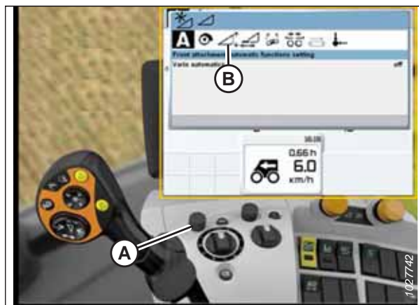
Rysunek 3.512: Wyświetlacz, konsola i drążek sterujący kombajnu CLAAS
