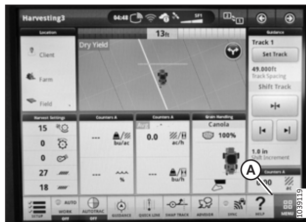
Rysunek 3.766: Wyświetlacz kombajnu John Deere X9 — strona Harvesting (Zbiór)
