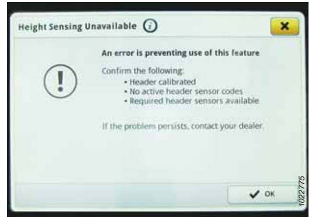
Rysunek 3.704: Wyświetlacz kombajnu John Deere S7 — komunikat o błędzie wykrywania wysokości
