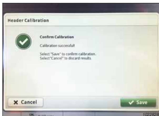
Rysunek 3.724: Wyświetlacz kombajnu John Deere S7 — kalibracja hedera
