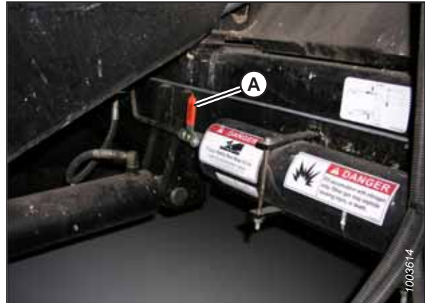
Rysunek 3.562: Przełącznik akumulatora kombajnu A — dźwignia akumulatora (w pozycji wyłączonej)
