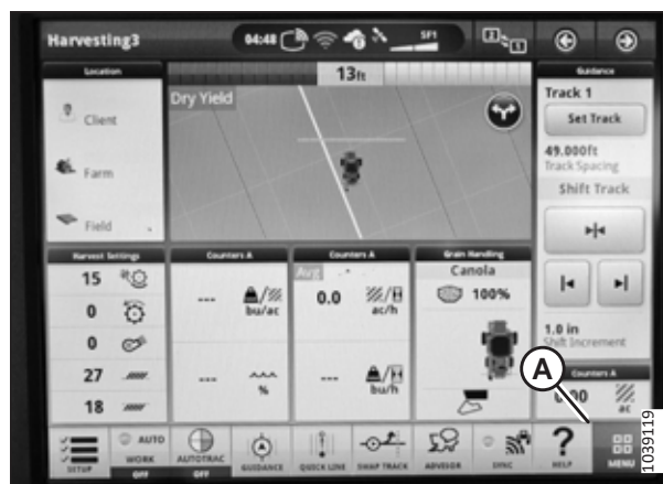
Rysunek 3.730: Wyświetlacz kombajnu John Deere X9 — strona Harvesting (Zbiór)
