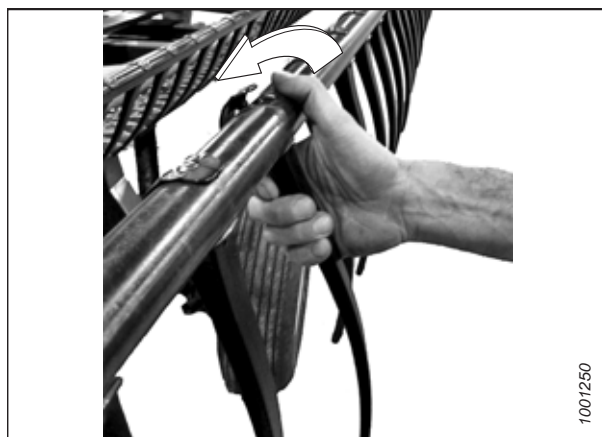
Rysunek 4.295: Demontaż plastikowego palca
