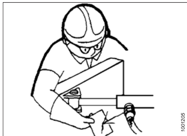
Rysunek 4.2: Próba szczelności elementów hydraulicznych
