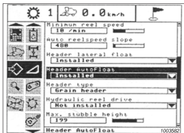
Rysunek 3.777: Wyświetlacz kombajnu New Holland
