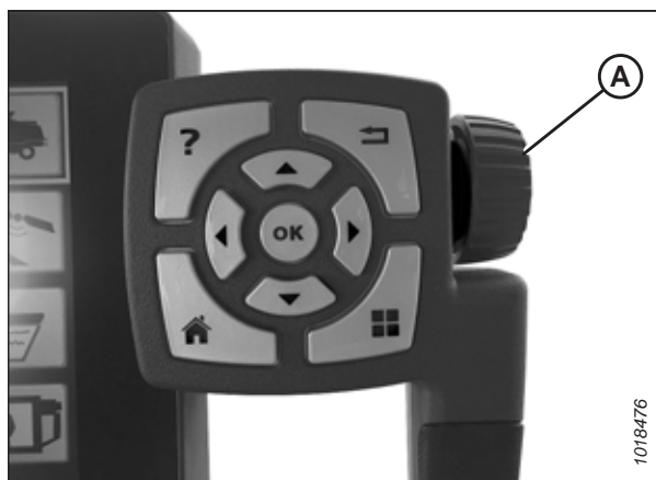
Rysunek 3.631: Pokrętło regulacyjne po prawej stronie terminala Tyton
