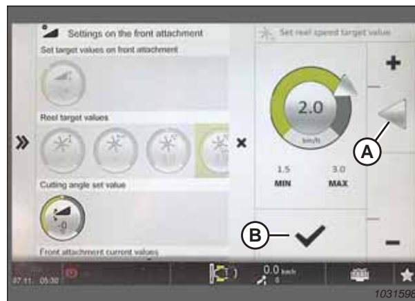
Rysunek 3.550: Strona Reel Speed Target Value (Wartość docelowa prędkości nagarniacza)
