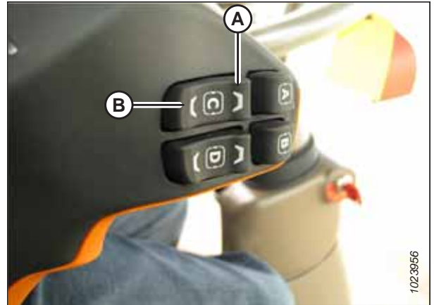
Rysunek 3.315: Sterowanie nachyleniem przenośnika pochyłego John Deere 700 w osi przód-tył
