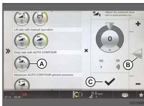
Rysunek 3.547: Strona Drop Rate with Auto Contour (Prędkość opadania z automatycznym śledzeniem terenu)
