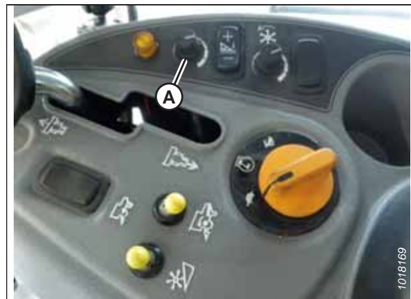
Rysunek 3.484: Pokrętło regulacji wysokości na konsoli sterowania kombajnu
