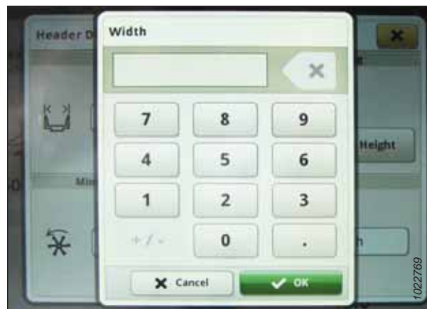
Rysunek 3.698: Wyświetlacz kombajnu John Deere S7 — ustawianie szerokości hedera
