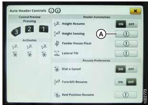
Rysunek 3.703: Wyświetlacz kombajnu John Deere S7 — elementy automatycznego sterowania hederem
