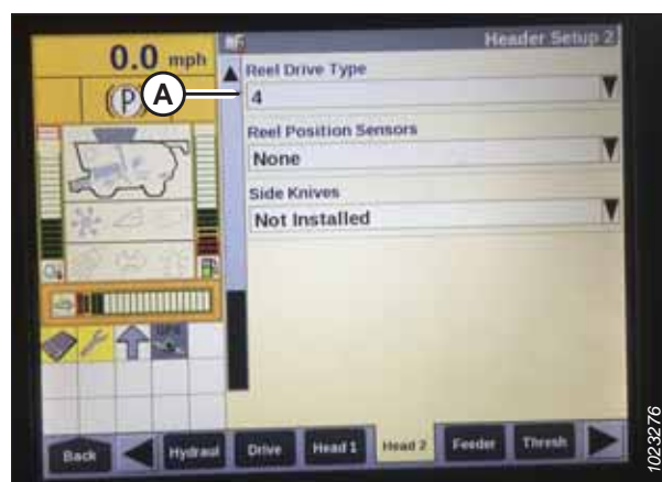
Rysunek 3.429: Wyświetlacz kombajnu Case IH
