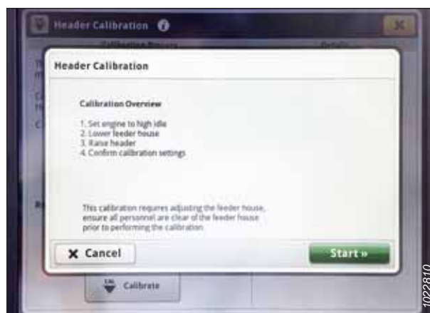
Rysunek 3.723: Wyświetlacz kombajnu John Deere S7 — kalibracja hedera
