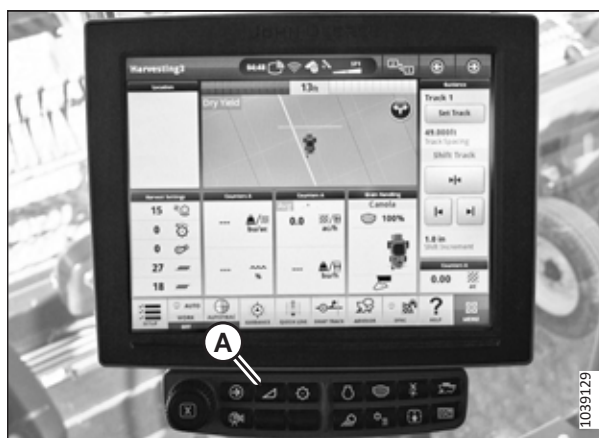
Rysunek 3.725: Wyświetlacz CommandCenter™
