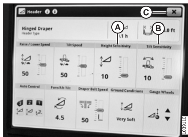
Rysunek 3.729: Wyświetlacz CommandCenter™ — strona Header (Heder)
