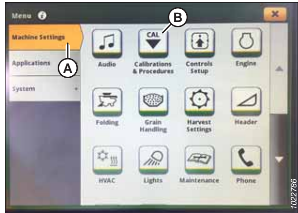
Rysunek 3.719: Wyświetlacz kombajnu John Deere S7 — ustawienia maszyny
