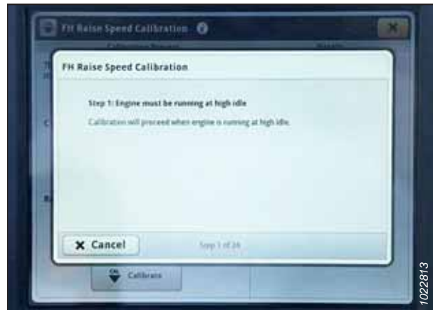
Rysunek 3.716: Wyświetlacz kombajnu John Deere S7 — kalibracja przenośnika pochyłego
