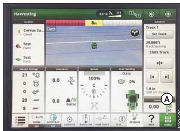
Rysunek 3.718: Wyświetlacz kombajnu John Deere S7 — strona Harvesting (Zbiór)
