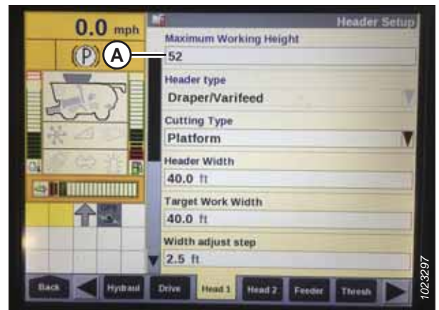
Rysunek 3.438: Wyświetlacz kombajnu Case — strona Heder Setup (Konfiguracja hедера)
