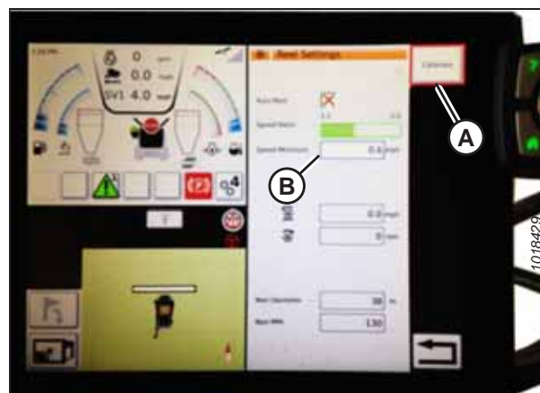
Rysunek 3.614: Kalibracja ustawień nagarniacza
