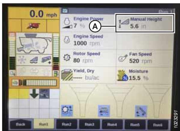
Rysunek 3.436: Wyświetlacz kombajnu Case — strona Run 1 (Przebieg 1)
