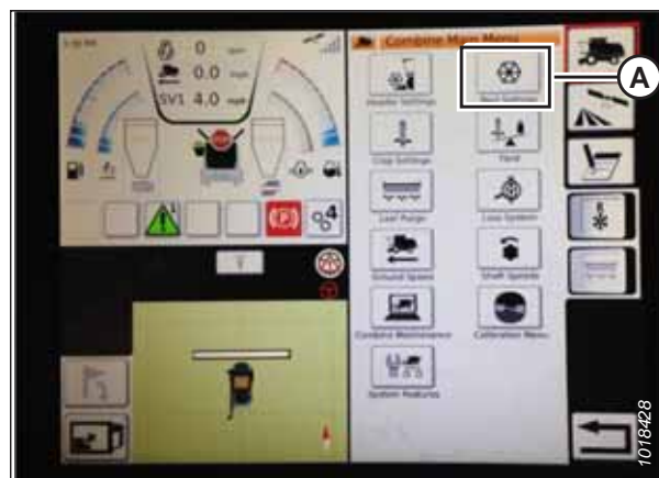
Rysunek 3.579: Ustawienia nagarniacza w menu głównym kombajnu
