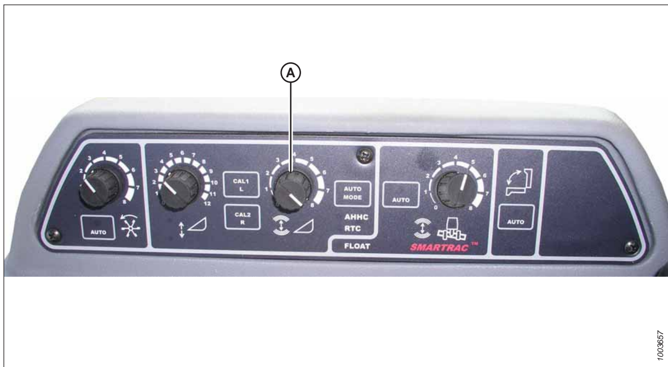
Rysunek 3.566: Konsola automatycznej regulacji wysokości hedera
