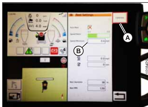
Rysunek 3.580: Kalibracja ustawień nagarniacza
