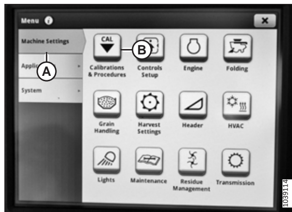
Rysunek 3.731: Wyświetlacz kombajnu John Deere X9 — ustawienia maszyny
