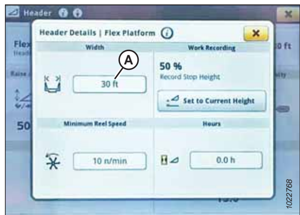
Rysunek 3.697: Wyświetlacz kombajnu John Deere S7 — okno Header Details (Szczegóły hedera)
