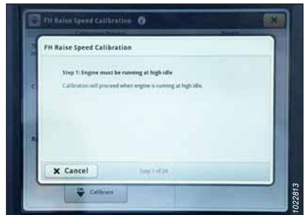
Rysunek 3.731: Wyświetlacz kombajnu John Deere S7 — kalibracja przenośnika pochyłego
