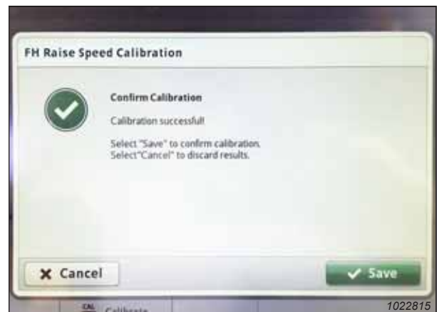
Rysunek 3.732: Wyświetlacz kombajnu John Deere S7 — kalibracja przenośnika pochyłego
