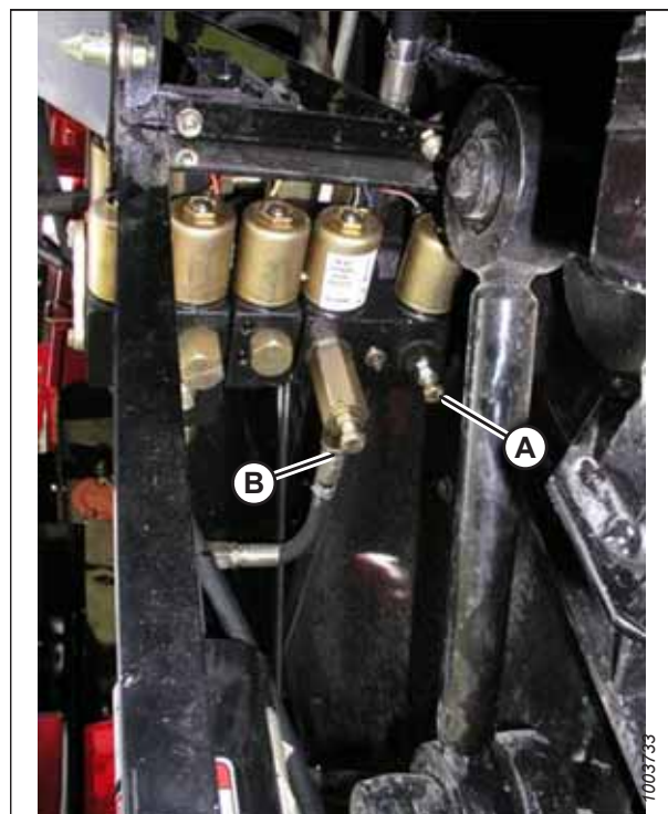
Rysunek 3.578: Regulowane ograniczniki podnoszenia i opuszczania hedera
