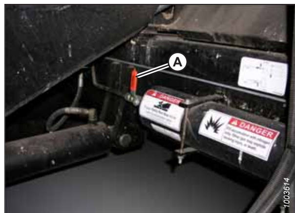
Rysunek 3.577: Przełącznik akumulatora kombajnu A — dźwignia akumulatora (w pozycji wyłączonej)
