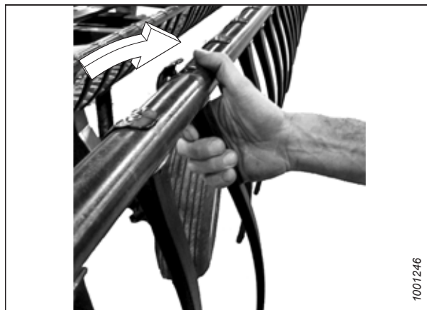
Rysunek 4.290: Montaż plastikowego palca
