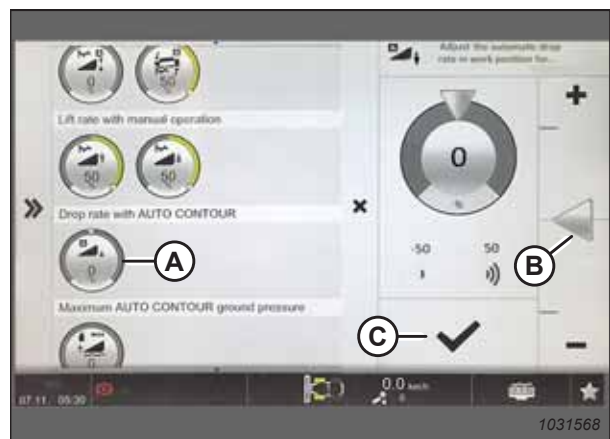
Rysunek 3.562: Strona Drop Rate with Auto Contour (Prędkość opadania z automatycznym śledzeniem terenu)
