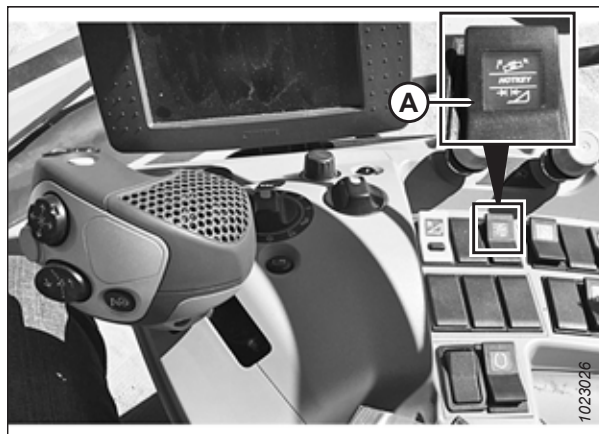
Rysunek 3.254: Wielofunkcyjny przełącznik kołyskowy
