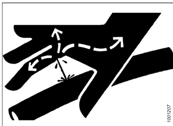
Рисунок 1.12: Опасное давление гидравлической жидкости
