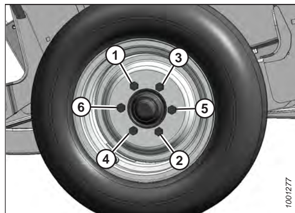
Рисунок 4.383: Последовательность затяжки болтов
