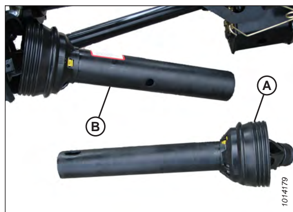
Рисунок 4.52: Раздельный кардан привода жатки
