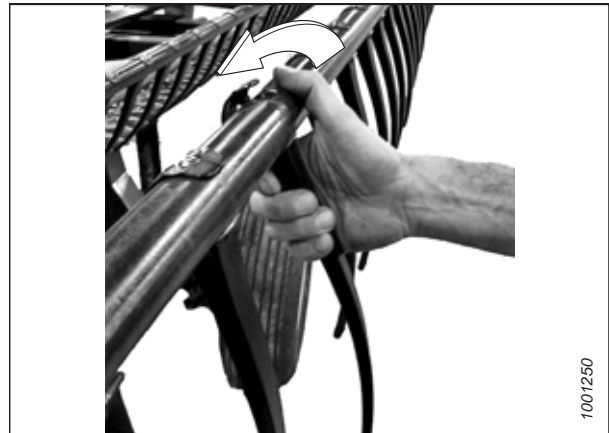
Figura 4.295: Remoção do dedo de plástico
