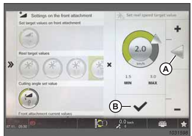
pav. 3.565: Lenktuvų greičio tikslinės vertės puslapis
