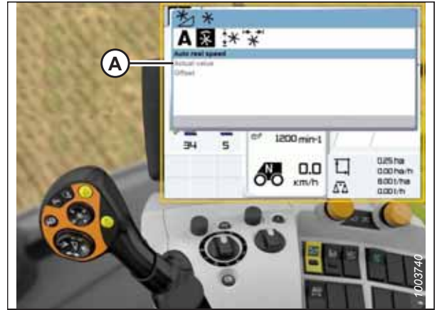
pav. 3.537: CLAAS kombaino ekranas, konsolė ir valdymo rankena
