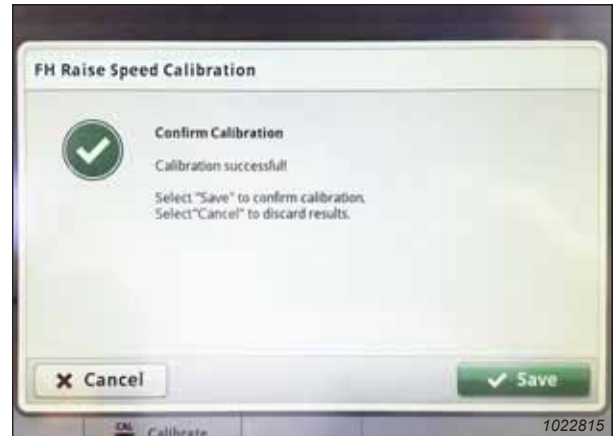
pav. 3.732: „John Deere“ S7 ekranas – nuožulniosios kameros kalibravimas
