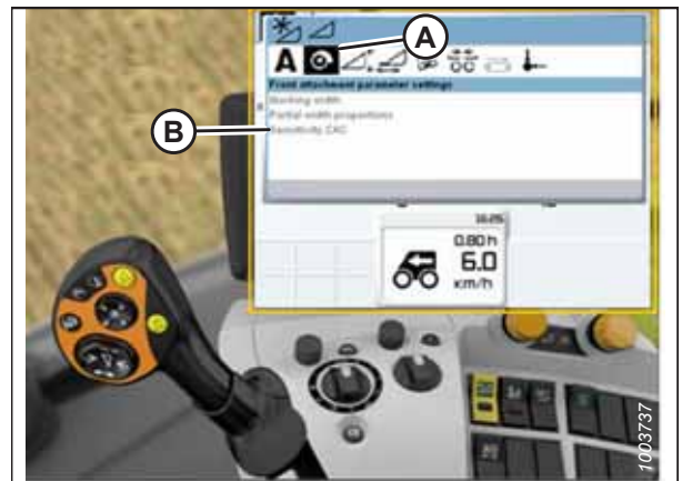
pav. 3.533: CLAAS kombaino ekranas, konsolė ir valdymo rankena
