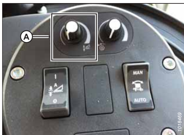
pav. 3.614: Pjaunamosios valdiklių grupė
