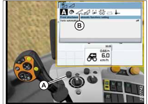
pav. 3.527: CLAAS kombaino ekranas, konsolė ir valdymo rankena
