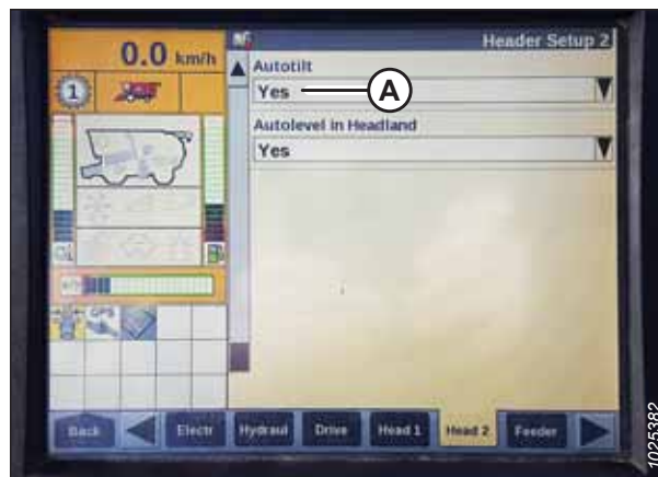
pav. 3.446: „Case IH“ kombaino ekranas
