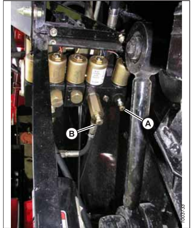
pav. 3.578: Pjaunamosios pakėlimo ir nuleidimo reguliuojami ribotuvai
