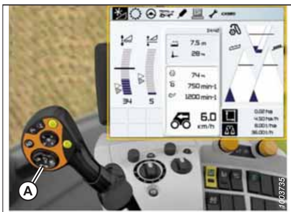
pav. 3.531: CLAAS kombaino ekranas, konsolė ir valdymo rankena
