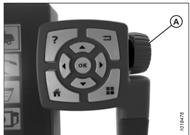
pav. 3.646: Reguliavimo ratukas dešinėje nuo „Tyton™“ gnybto
