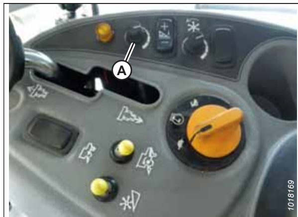
pav. 3.499: Kombaino valdymo konsolės aukščio reguliavimo rankenėlė
