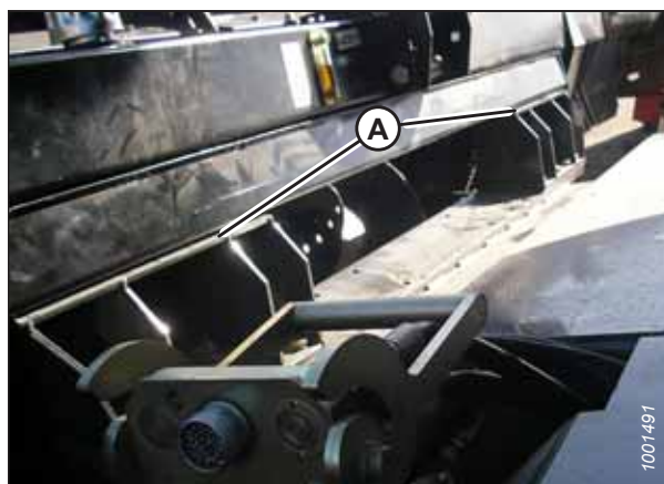
pav. 3.53: Nuožulniosios kameros korpusas ir paviršiaus kopijavimo modulis
