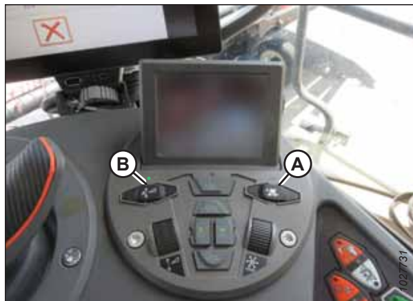
pav. 3.642: Pjaunamosios valdiklių grupė
