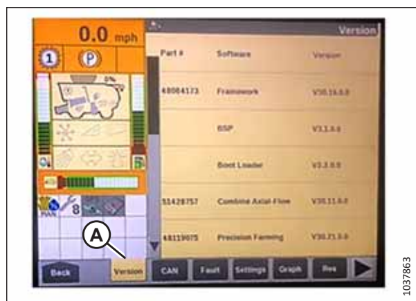
pav. 3.447: „Case IH“ kombaino ekranas
