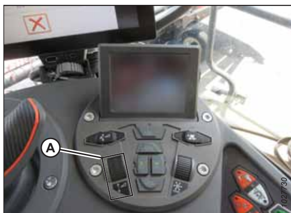
pav. 3.644: Pjaunamosios valdiklių grupė
