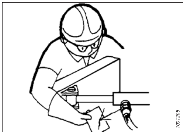
pav. 4.2: Hidraulinių nuotėkių tikrinimas
