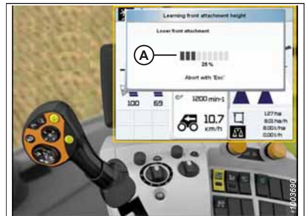
pav. 3.543: CLAAS kombaino ekranas, konsolė ir valdymo rankena
