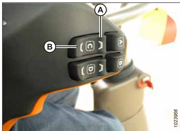
pav. 3.337: „John Deere“ 700 valdikliai
