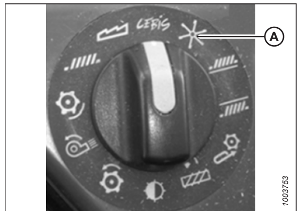
pav. 3.519: CLAAS kombaino sukamasis jungiklis
