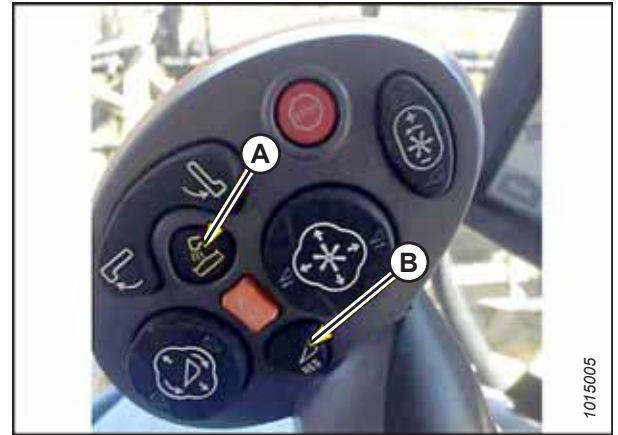
pav. 3.798: „New Holland“ kombaino valdikliai
