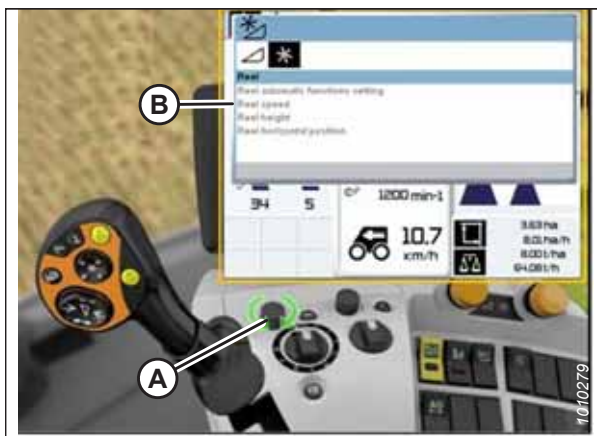
pav. 3.536: CLAAS kombaino ekranas, konsolė ir valdymo rankena
