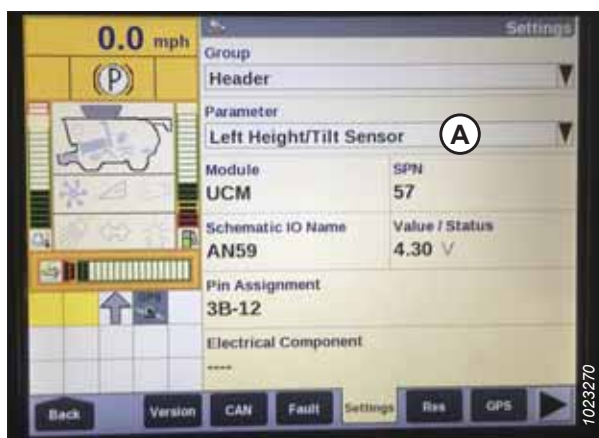
pav. 3.438: „Case IH“ kombaino ekranas
