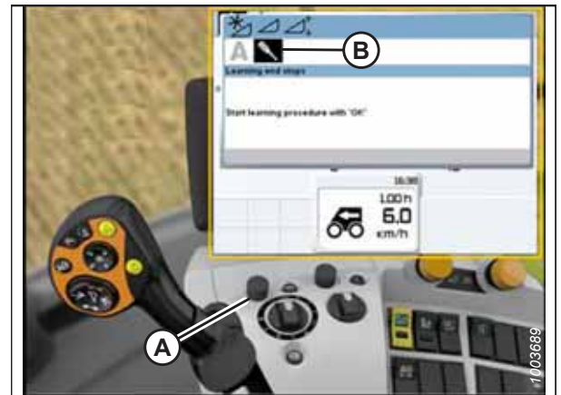
pav. 3.528: CLAAS kombaino ekranas, konsolė ir valdymo rankena
