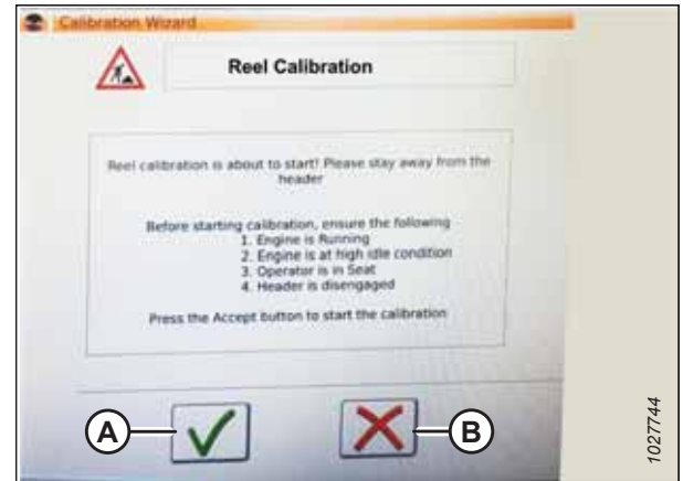
pav. 3.596: Kalibravimo vedlys
