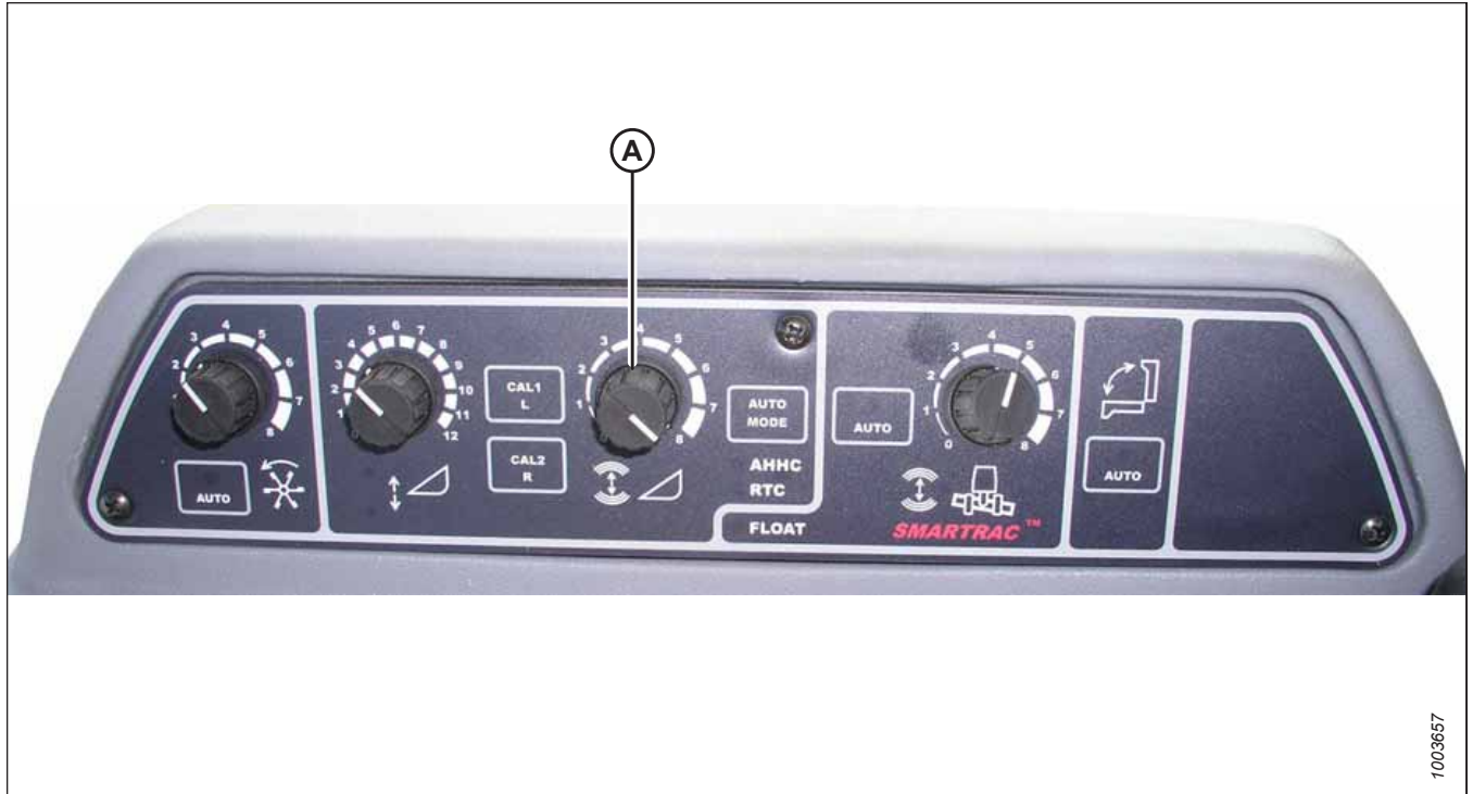
pav. 3.581: Automatinio pjaunamosios aukščio valdymo konsolė
