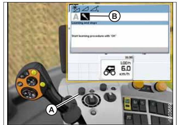
pav. 3.542: CLAAS kombaino ekranas, konsolė ir valdymo rankena
