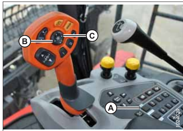
pav. 3.342: „Versatile“ valdymo rankena ir konsolė
