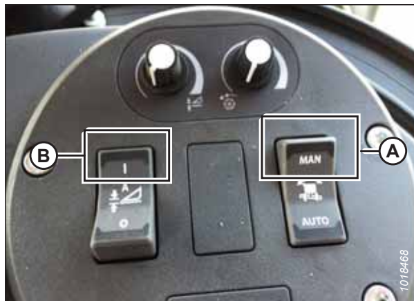
pav. 3.612: Pjaunamosios valdiklių grupė
