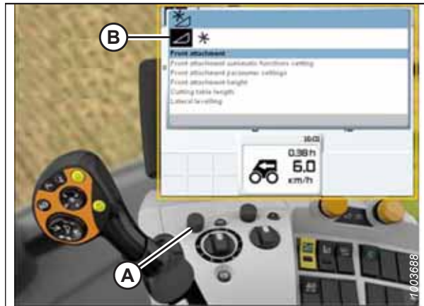
pav. 3.526: CLAAS kombaino ekranas, konsolė ir valdymo rankena
