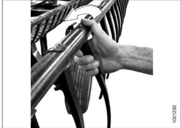
Abbildung 4.296: Ausbauen eines Kunststoffhaspelfingers
