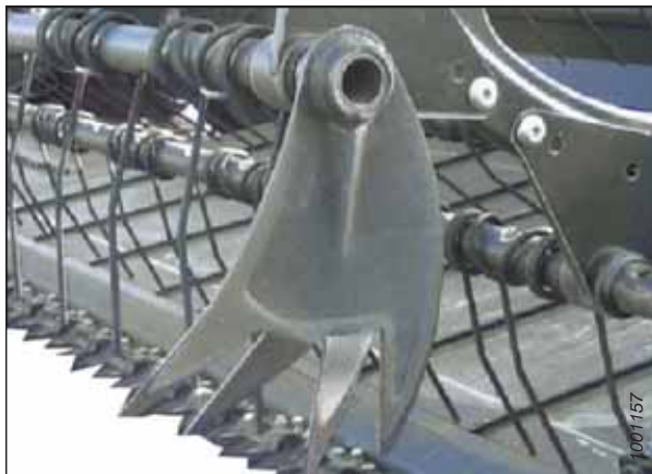
Abbildung 5.6: Haspelfinger für liegendes Erntegut
