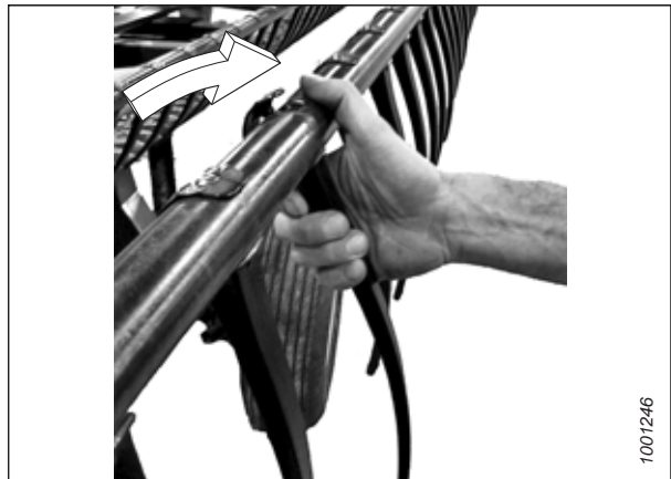
Abbildung 4.297: Einbauen eines Kunststoffhaspelfingers
