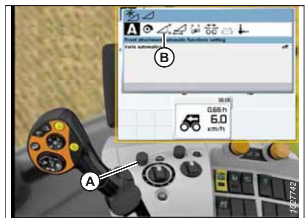
Figure 3.548: Écran, console et levier de commande de la moissonneuse-batteuse CLAAS
