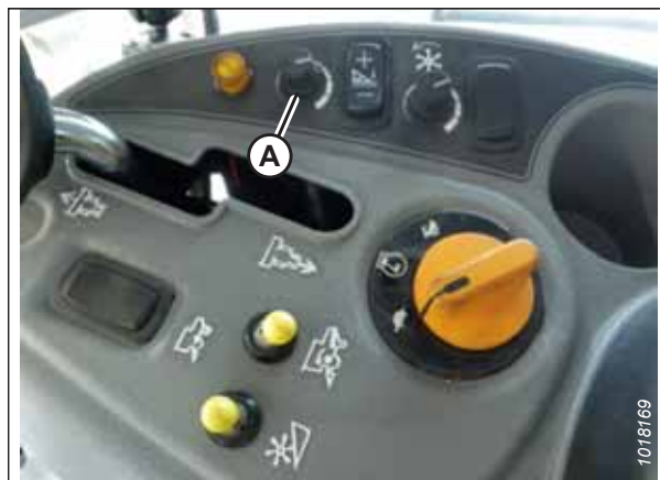
Figure 3.513: Bouton de réglage de la hauteur sur la console de commande de la moissonneuse-batteuse
