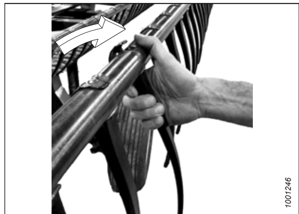
Figure 4.297: Installation des doigts en plastique
