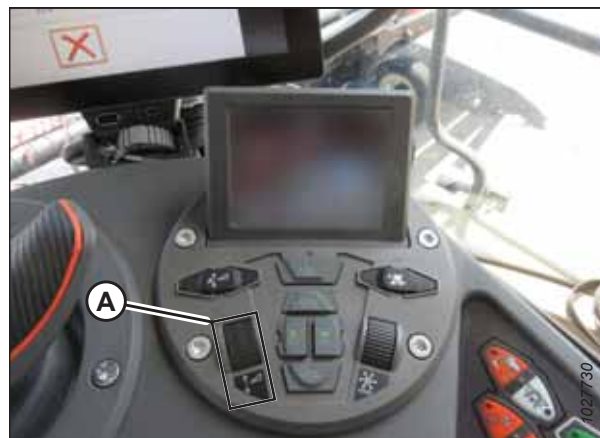
Figure 3.675: Groupe de commande de la plateforme
