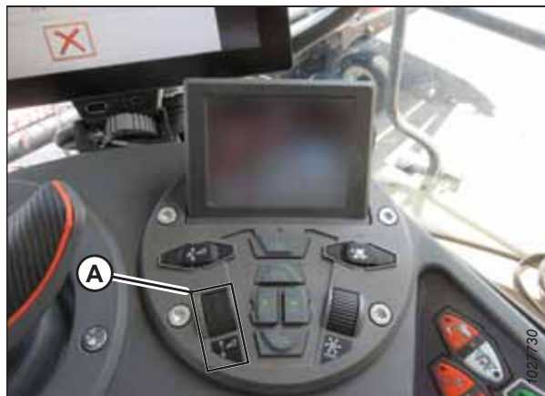
Figure 3.672: Groupe de commande de la plateforme
