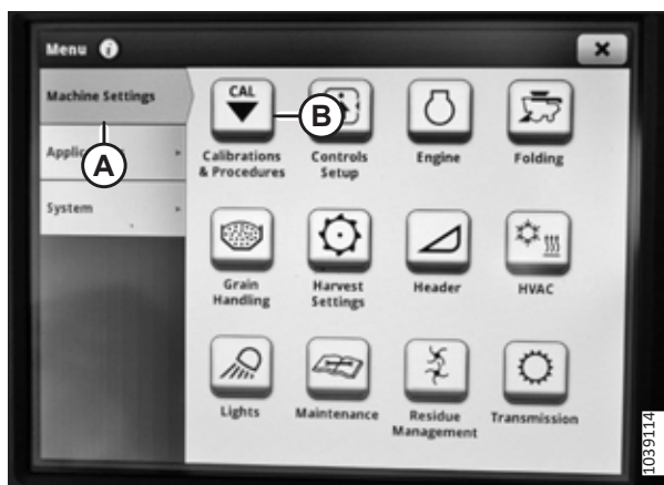
Figure 3.775: Écran John Deere X9 – Paramètres de la machine
