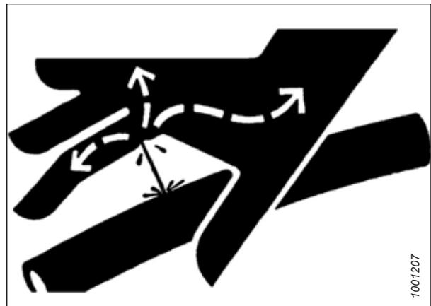
Figure 1.12: Risque lié à la pression hydraulique
