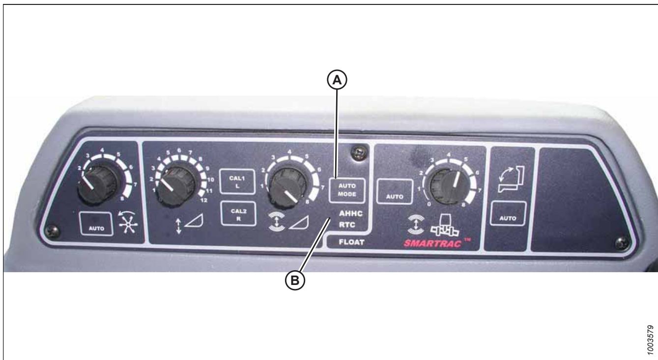
Figure 3.600: Commandes du système de réglage automatique de la hauteur de la plateforme de la moissonneuse-batteuse
