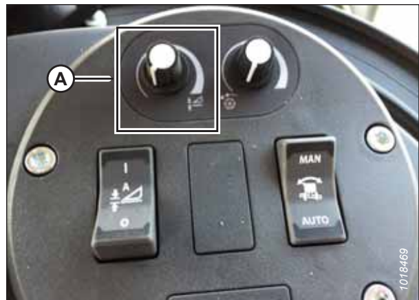
Figure 3.641: Groupe de commande de la plateforme
