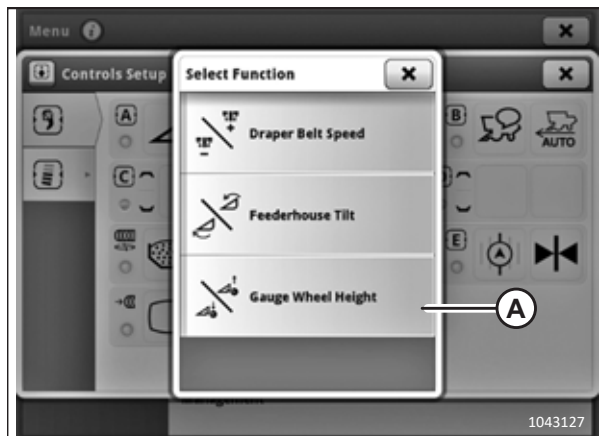
Figure 3.285: Écran John Deere X9 – Réglage des commandes
